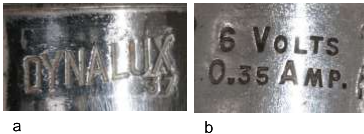
Bild 1.2: Beschriftung des Gehäusemantels a) Typenbezeichnung b) Nenndaten
