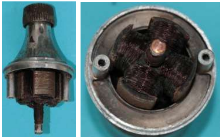
Bild 1.7 : Anker, Durchmesser:30 mm Blechpaketlänge: 14 mm
