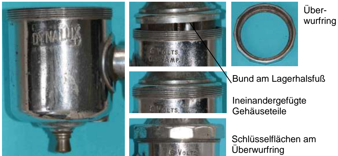
Bild 1.4: Verschraubung der Gehäuseteile
