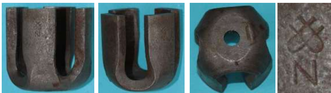
Bild 1.5: Ansichten des vierpoligen Tulpenmagneten mit dem Logo des Magnetherstellers, Magnetlänge 40 mm, Magnetdicke 5 mm
