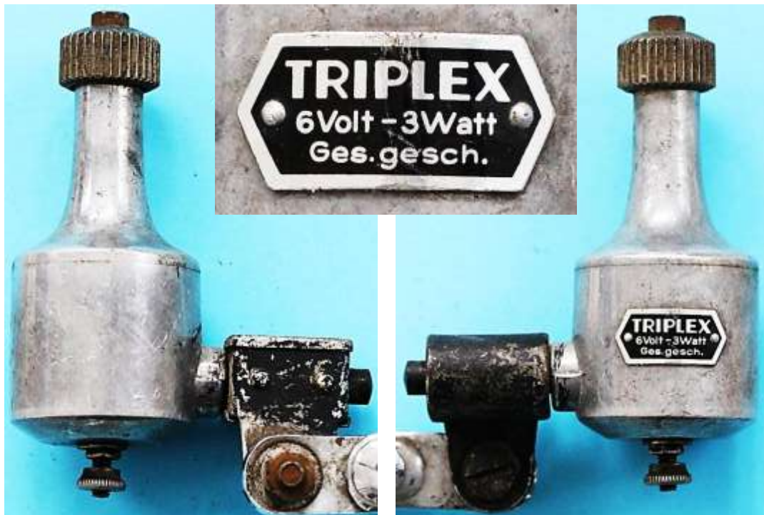
Bild 1.1: Triplex, vierpoliger Blätterpoldynamo
