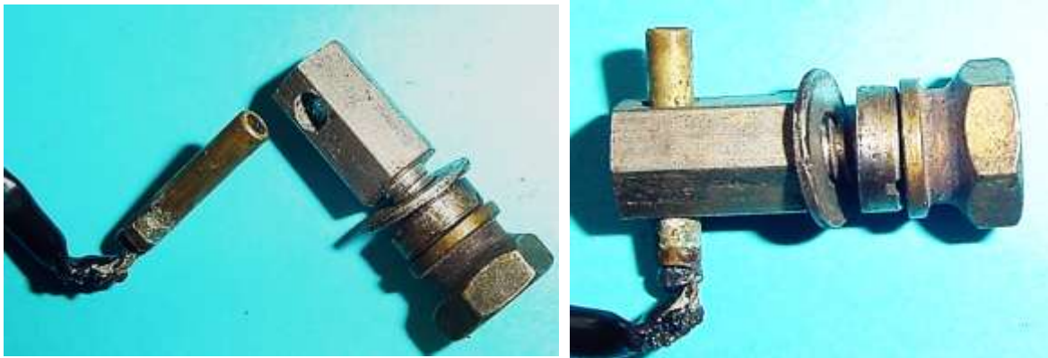
Bild 2.10: Spulenende und Anschlussbolzen mit Durchgangsloch und Gewinde
