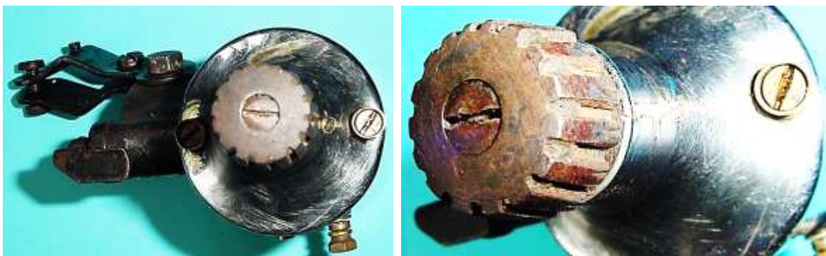
Bild 2.11: Versiegelbare Schlitzschrauben im Lagerhalsfuß
