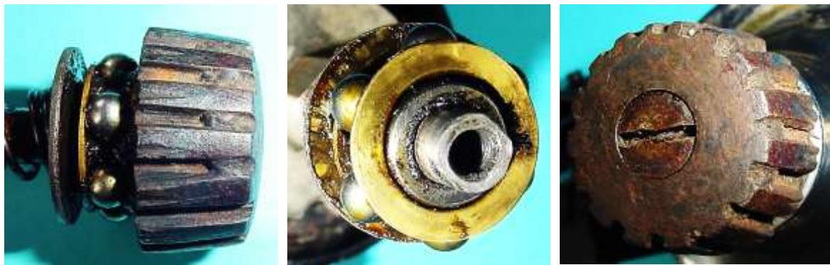
Bild 2.8: Reibrad und axiale Gewindebohrung in der Welle zu seiner Befestigung
