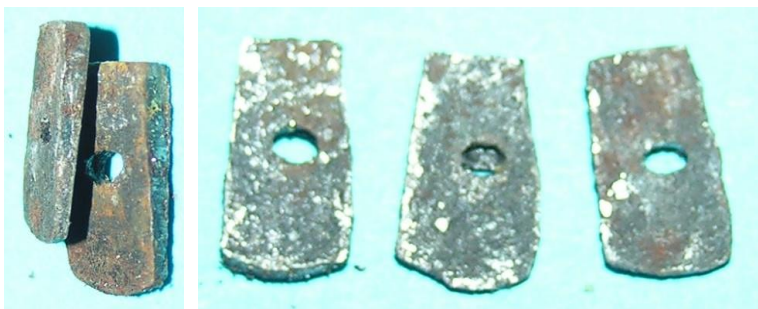
Bild 3.14: Keile für die Ver-spannung der Magnetstäben mit dem Gehäusetopf
