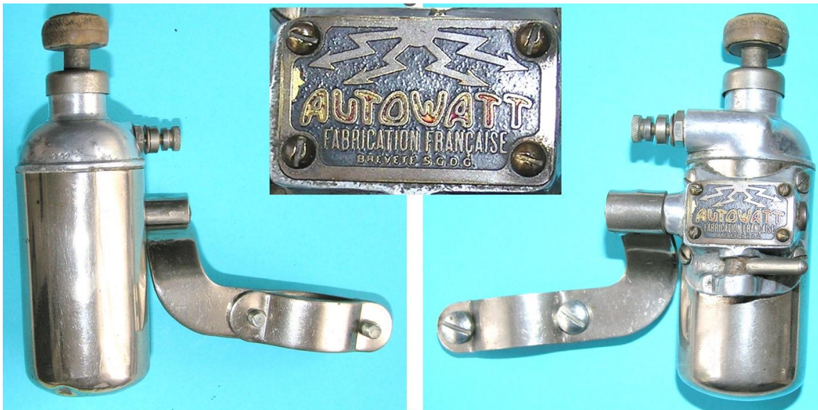
Bild 3.1: Autowatt-Dynamo; Gehäusetopflänge 77 mm, Durchmesser 44 mm, Gesamtgewicht 680 g
