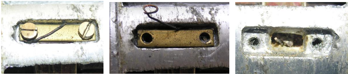
Bild 3.15: Angeschraubtes Kontaktblech für die Masseverbindung
