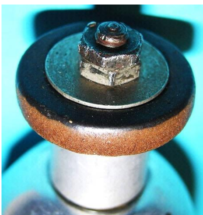
Bild 2.11: Reibrad, ausgeschnitten aus einer 5 mm starken Kautschukplatte
