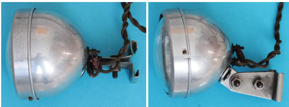
Bild 2.8: Lampenhalter: a) Gelenk zur Einstellung des Lichtscheins auf der Fahrbahn, b) Halter mit Klemmschraube zur Sicherung am Fahrradlampenhalter
