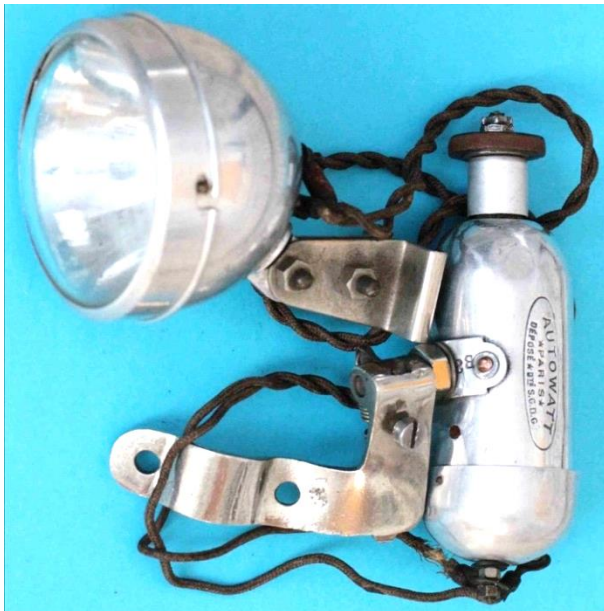
Bild 1.4: Vollständige Fahrradlicht-Anlage der Firma Autowatt
