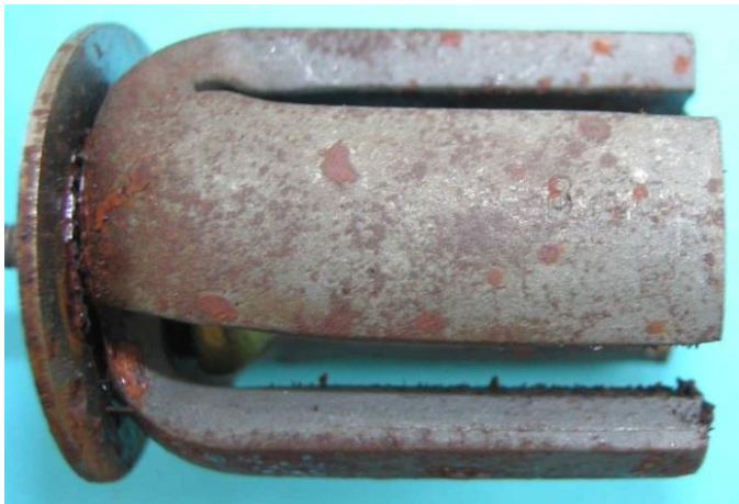
Bild 4.4: Position der Blattfeder des Schleifkontakts
