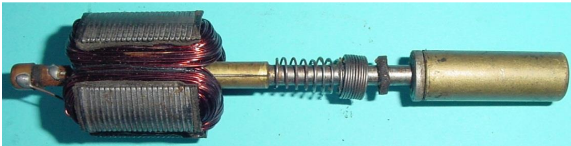
Bild 3.3: Läufer mit den Massekontaktfedern und Stapellager, Blechpaketlänge l=21 mm, 21 Bleche
