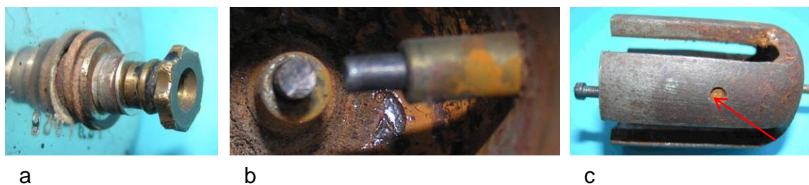
Bild 2.5: Elemente des Stromkreises: a) Kabelanschlussbolzen, b) Spannung führende Bürste und Massebürste, c) Magnetschenkel mit Bohrung für den Massebürstenhalter
