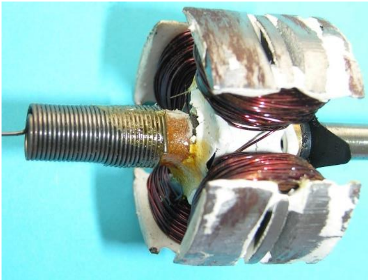
Bild 7.11: Anker des Tulpenmagnet-Dynamos im Bild 1.1d
