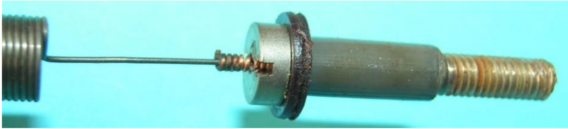
Bild 7.10: Schleifkontakt im Tulpenmagnet-Dynamos im Bild 1.1d
