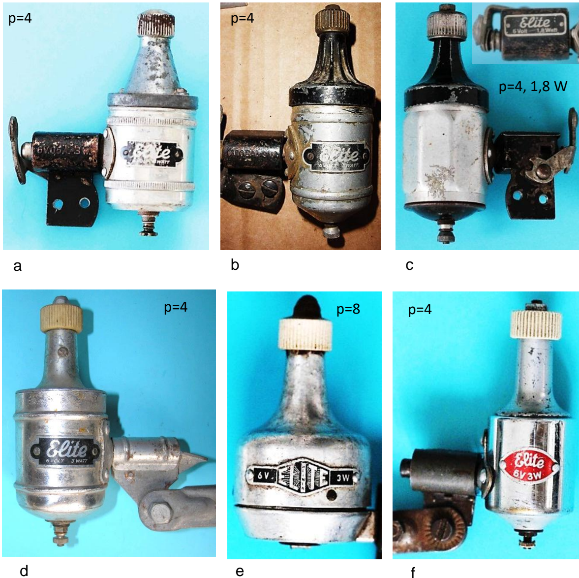
Bild 1.1: Muster mit dem Markennamen „Elite“: a) bis c) Eingebaute Generatoren sind baugleich zu den entsprechenden EnnWell-Typen, d) Elite-Dynamo mit Klinkenhebelkippvorrichtung, e) Baugleich mit der Marke Sadyno, f) Entspricht der Marke Fribu
