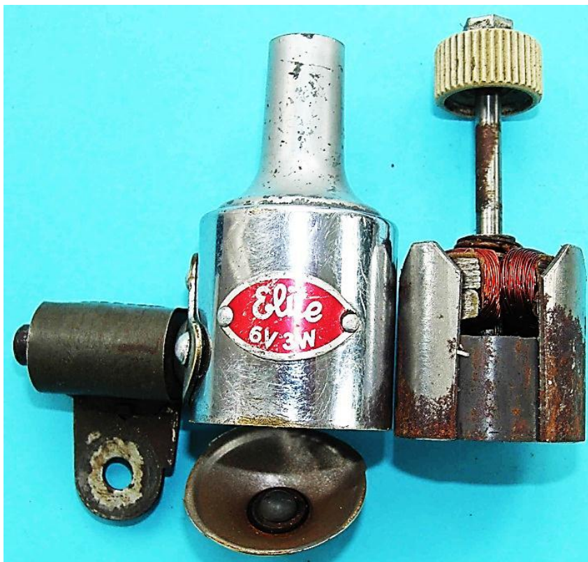
Bild 7.4 Baugruppen: a) Dreiteiliges Gehäuse mit Kippvorrichtung, b) Generator mit Reibrad
