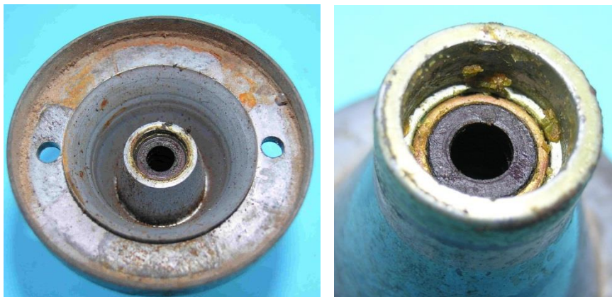
Bild 2.2: Gleitlager aus Pertinaxscheiben
