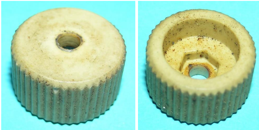
Bild 7.7: Reibrad aus Speckstein
