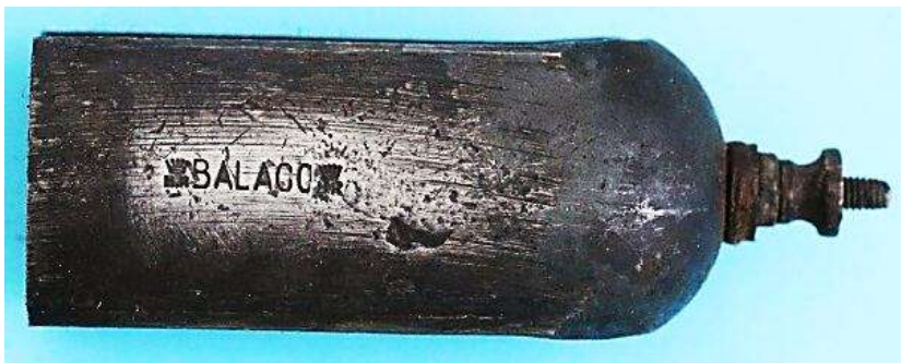
Bild 2.45: Konstruktionskonzept: a) Zweipoliger Tulpenmagnet mit Kabelanschlussbolzen (Magnetlänge 75 mm, Magnetdicke 5 mm, Außendurchmesser 37 mm/31 mm), b) Mit Gewindebolzen am Lagerhals befestigtes untere Lagerschild, c) Positionierung des Magneten ohne Schraubverbindungen
