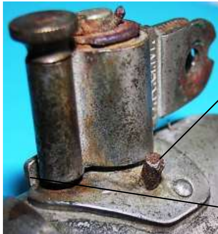
Bild 2.5: Fünfeckiger Flansch bei der ersten Ausführung: a) Arbeitsstellung, b) Ruhestellung
