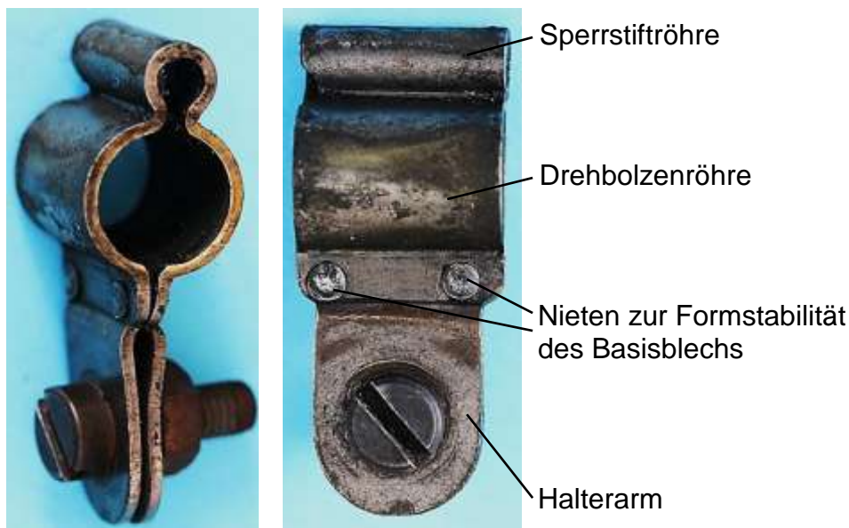
Bild 2.14: 1,5 mm starkes Basisblech; a) Verformung des Messingblechs zu zwei übereinander liegenden Röhren und dem geteilten Halterarm, b) Mit zwei Nieten ver- schlossenes Basisblech
