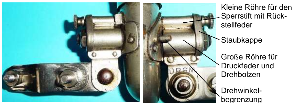
Bild 2.31: Seitenansichten der Kippvorrichtung
