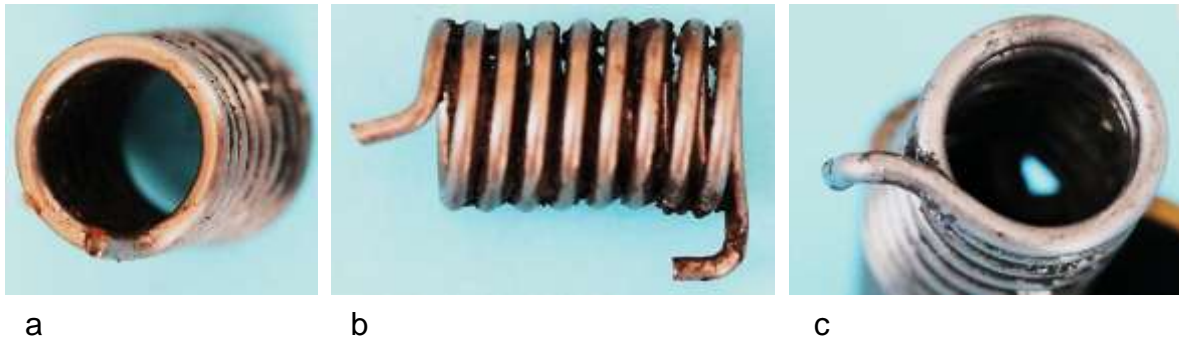
Bild 2.13: Druckfeder: a) Ende der Schraubenfeder zur Arretierung im Flansch, b) Schraubenfeder aus 1,5 mm dicken Draht, c) Zweites Federende zur Abstützung am Basisblech
