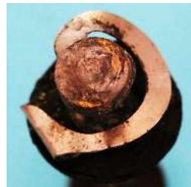
Bild 2.48: Drei Ansichten der Kontaktfeder mit massiver Kontaktscheibe
