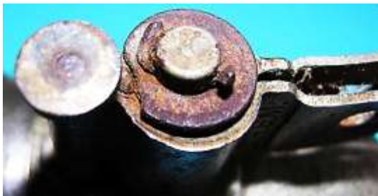
Bild 2.5: Fünfeckiger Flansch bei der ersten Ausführung: a) Arbeitsstellung, b) Ruhestellung
