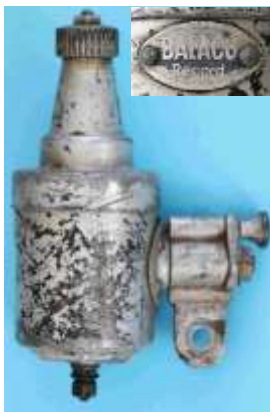
Balaco Record 3 W Magnetdicke: 6,5 mm Magnetlänge 62 mm
