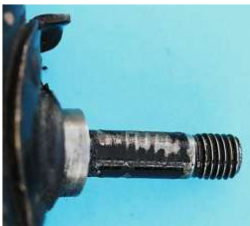
Bild 2.12: Im ovalen Flansch eingesetzter Drehbolzen
