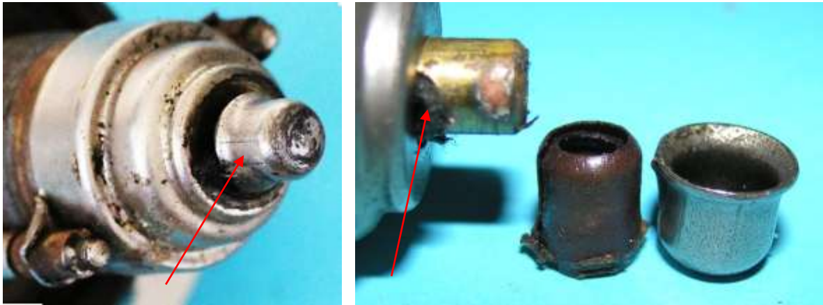
Bild 2.55: Spannung führender Kontakt: a) Schleifkappe auf dem Wellenende, b) Spulenanschluss, c) Gewickelte Isolierhülse, d) Schleifkappe
