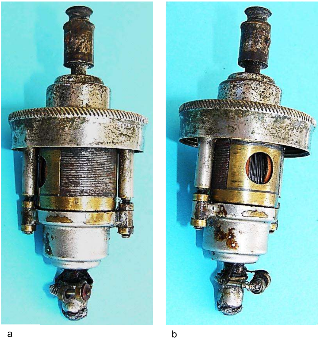
Bild 2.18: Anker und Lagerhals: a) Ansicht eines Polschuhs, b) Pollückenblech mit zentraler Öffnung
