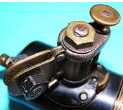
Bild 2.7: Runder Flansch beim Typ Balaco-Record: a) Arbeitsstellung, b) Ruhestellung
