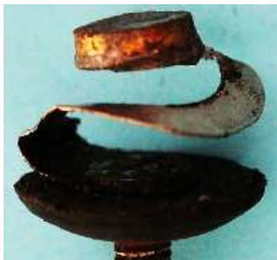
Bild 2.48: Drei Ansichten der Kontaktfeder mit massiver Kontaktscheibe
