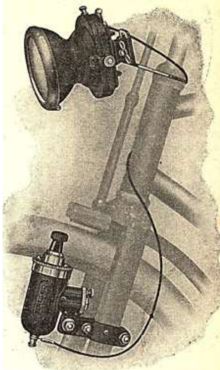
Bild 2.10: Abbildung im Wedlerkatalog von 1928 a) Lichtanlage mit Batterie und Dynamo, b) Ausschnittvergrößerung von a)
