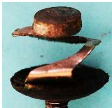
Bild 2.48: Drei Ansichten der Kontaktfeder mit massiver Kontaktscheibe
