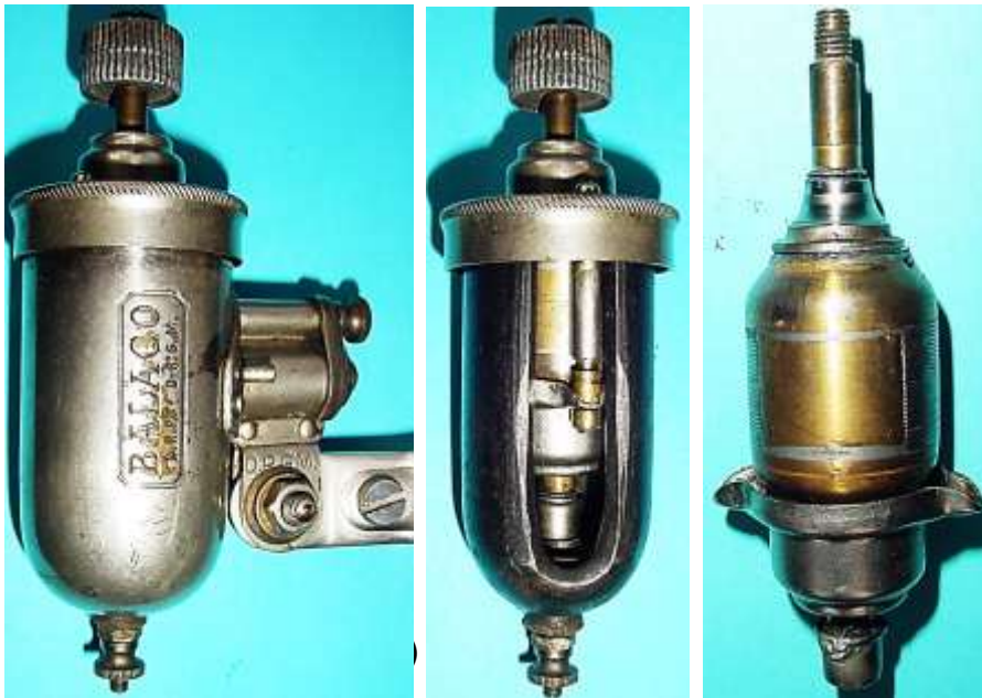
Bild 2.28: Erstes Modell „Balaco 1“. a) Vollständige Ansicht, b) Gehäusetopf entfernt, c) Läufer mit unterem Lagerschild
