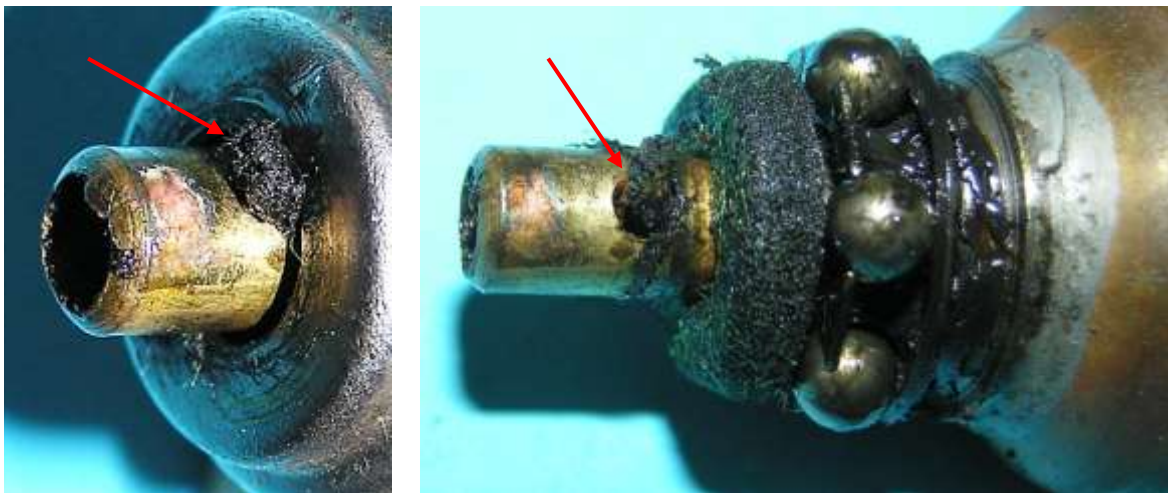
Bild 2.56: Unteres Lager: a) Aufgeschobene Lagerschale mit Wicklungsanschluss, b) Position des Kugellagers auf dem Konus
