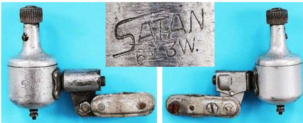
Bild 1: Satan: 6V, 3A, Dynamogewicht 240 g + 60 g Halter
