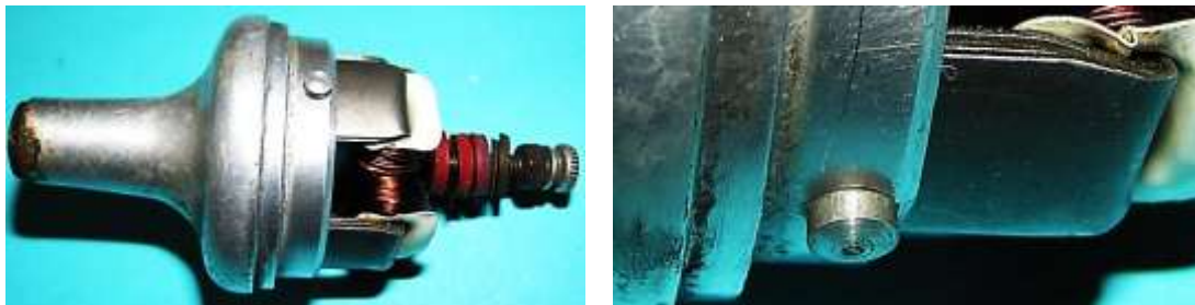
Bild 11: Sicherung der axialen Position mit einem Stopfen
