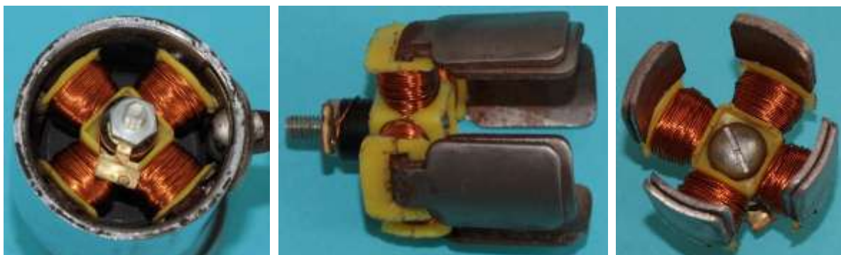
Bild 1.10: Anker: a) Position im Lagerhalstopf, b) Einzelbewicklung der Polschäfte, c) Innenraum des Ankers mit Schraubenkopf des Kabelanschlussbolzens
