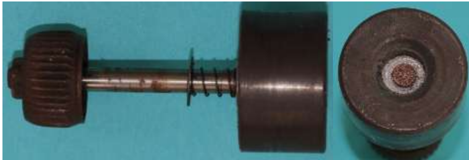
Bild 1.9: Vierpoliges Walzenpolrad, 14 mm lang, 28 mm Durchmesser
