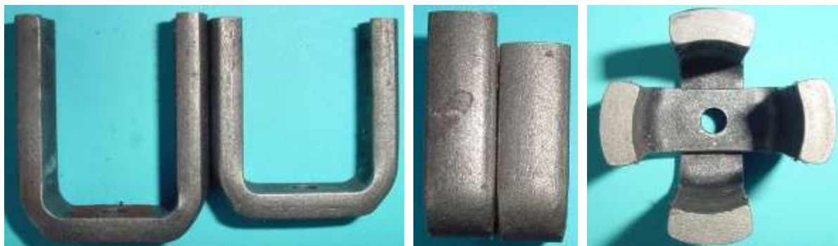
Bild 2.2: Gabelpolanordnung: a) U-Formen mit unterschiedlich langen Schenkeln, b) Polbreiten, c) Stirnseiten der Pole
