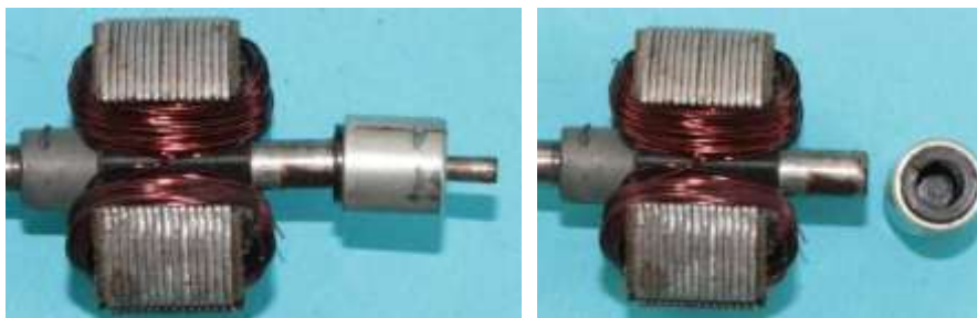
Bild 2.8: Spannung führender Kontakt: a) Welle mit Kon- takthülse, b) Kontakthülse mit Isoliereinlage
