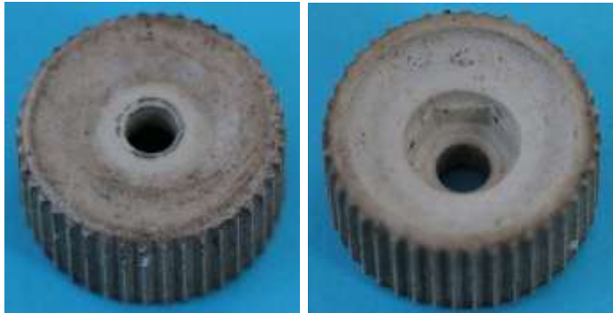
Bild 1.10: Befestigung des Keramikreibrades
