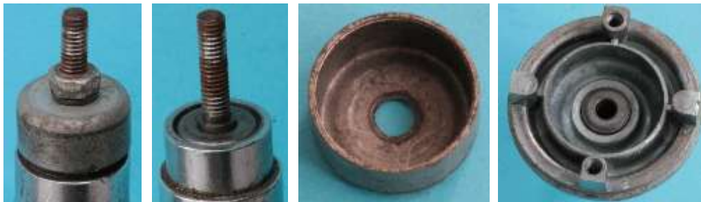
Bild 1.12: Dichtungs-Kapsel: a) Montierte Dichtungs-Kapsel, b) Oberes Gleitlager, c) Dichtungs-Kapsel, d) Unteres Gleitlager
