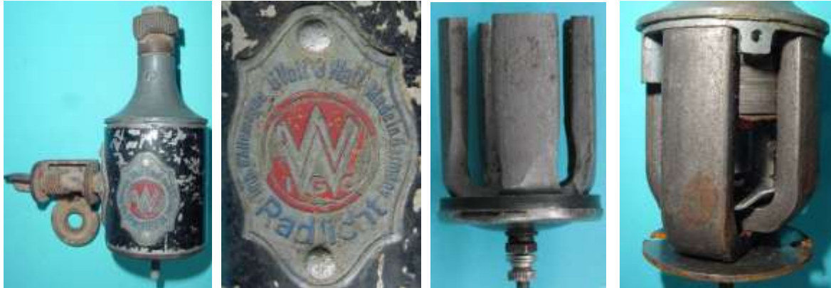
Bild 2.1: Erregersysteme im WIGO-Radlicht: a) Dynamo mit dreiteiligem Gehäuse, b) Firmen und Leistungsschild, c) Vierpoliger Tulpenmagnet, d) Gabelpolanordnung
