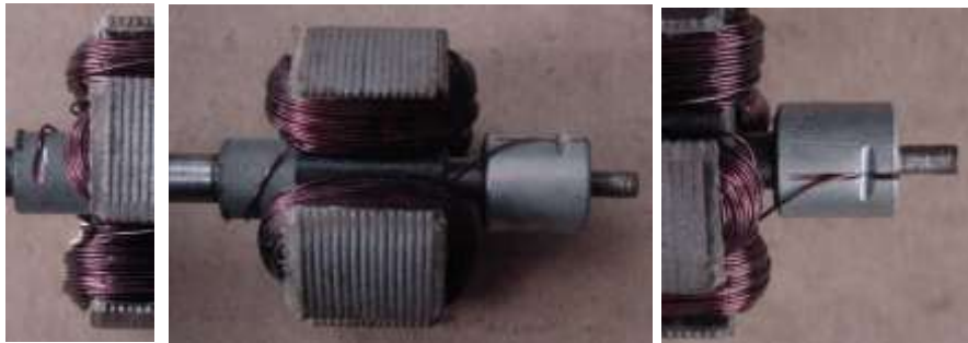
Bild 2.7: Spulenan- schlüsse in den Mustern von Bild 1.7b, c und d a) Masseanschluss b) Anker c) Spannung füh- render Anschluss
