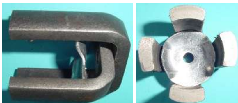
Bild 2.3: Aluminiumplatte innerhalb des Polsystems
