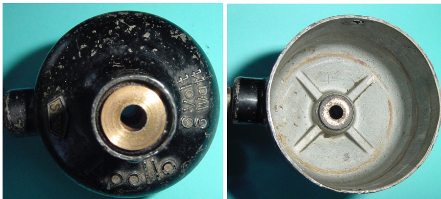
Bild 1.5: Lagerhalstopf mit Gleitlager
