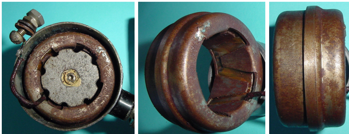
Bild 1.8: Zweiteiliger Klauenpolanker mit dem Polrad
