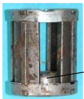
Bild 1.28: Konstruktion des Erregersystems mit Stabmagneten
