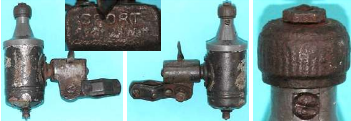
Bild 4.14: Häckel 334 296, SPORT, 2,1 W, Durchmesser des Reibrades 21 mm
