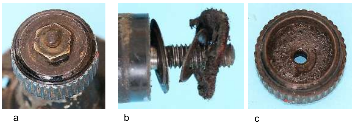
Bild 4.10: Raum zwischen Lager und Reibrad: a) Reibrad mit Kontermutter, b) Unterlegscheiben und Dichtungsring, c) Innenraum des Reibrades
