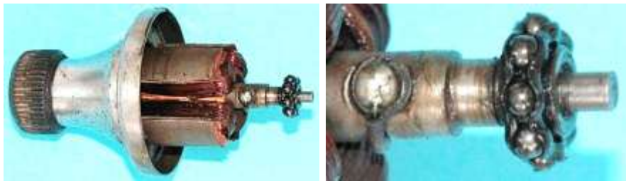
Bild 2.22: Unteres Kugellager und Lötstelle für den Spannungsführenden Anschluss
