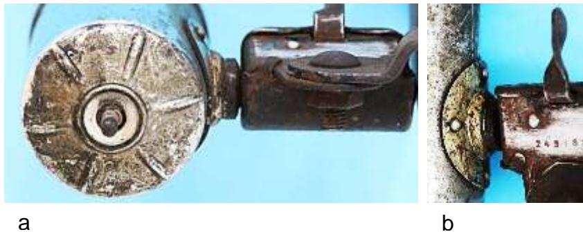
Bild 4.4: Gehäusetopf: a) Stabilisierungsrippen am Boden, b) Angenieteter Flansch der Kippvorrichtung
