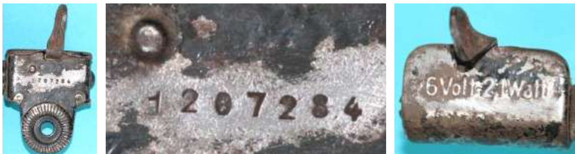
Bild 4.28: Beschriftung der Kippvorrichtung: a) Rückseite, b) Fertigungsnummer auf der Rückseite, c) Nennangaben 6 V, 2,1 A
