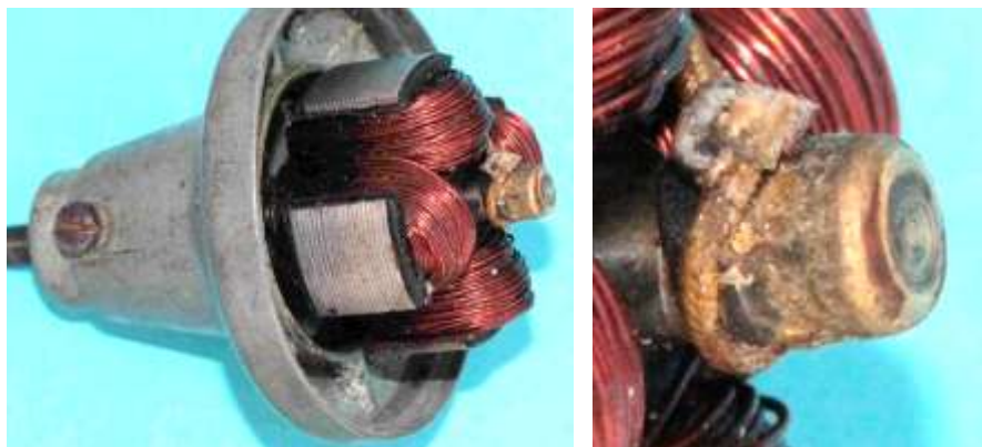
Bild 5.6: Spannung führende Messing- kappe auf dem Wel- lenende
