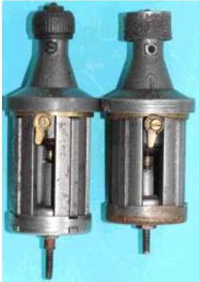
Bild 4.24: Differenz der Magnetlängen von 5 mm a) Dynamo Nr. 334 296 b) Dynamo Nr. 443 498
