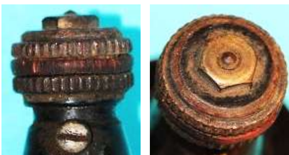
Bild 4.26: Reibrad mit Gummiring und aufgesetzter Kontermutter
