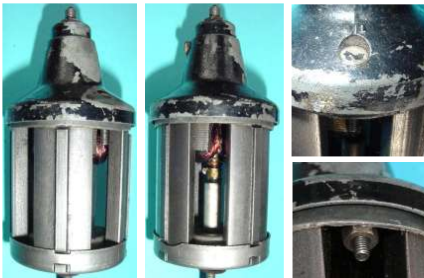
Bild 5.14: Befestigung des Erregersystems am Lagerhals: a) Magnetstab mit Rückensteg b) Pollücke c) Mutter unterhalb des Winkelrings d) Verplombter Schraubenkopf
