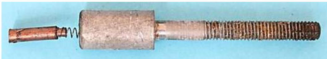
Bild 4.12: Bürste, Bürstenhalter und Kabelanschlussbolzen
