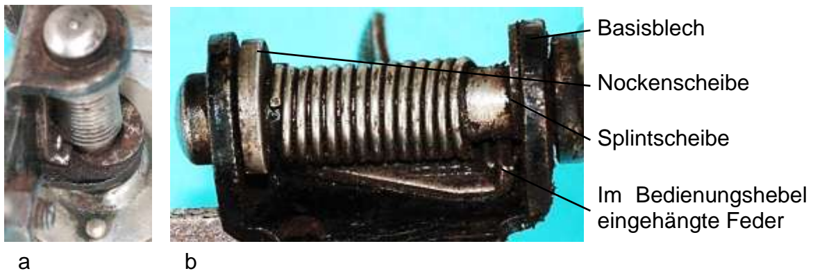
Bild 3.3: Kippvorrichtung mit Nockenscheibe
