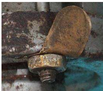
Bild 2.5: Blattfeder zur Sicherung des Stromübergangs zum Gehäusemantel
