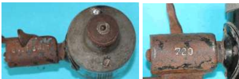
Bild 5.12: Beschriftung auf der Abdeckung der Kipp- vorrichtung: a) Nenndaten 6 V, 3 W, b) Typ 720
