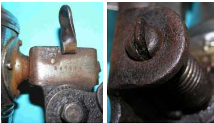
Bild 2.10: Kippvorrichtung: a) Eingeprägte Fertigungsnummer auf der Rückseite b) Drehbolzen mit dem Sperrblech
