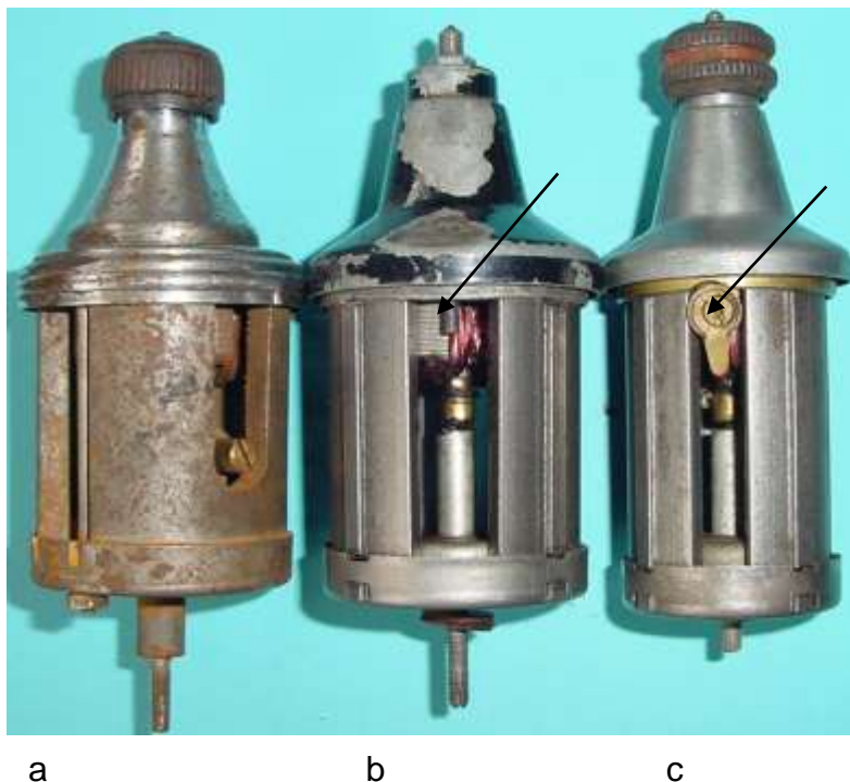
Bild 1.25: Magnetsysteme: a) Zweiteiliges Tulpenmagnetsystem, b) Am Lagerhals sichtbare Befestigungsschrauben c) Vom Gehäusetopf verdeckte Befestigungsschrauben
