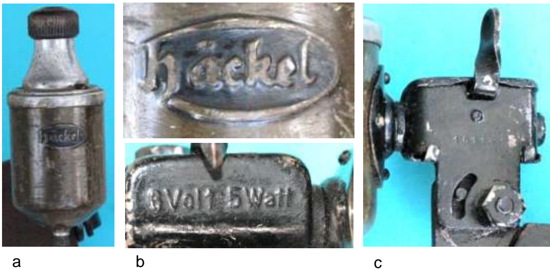
Bild 2.16: Beschriftung des Gehäuses und der Kippvorrichtung: a) Eingepprägter Firmenname, b) Nenndaten 6 Volt, 5 Watt, Fertigungsnummer 101.149
