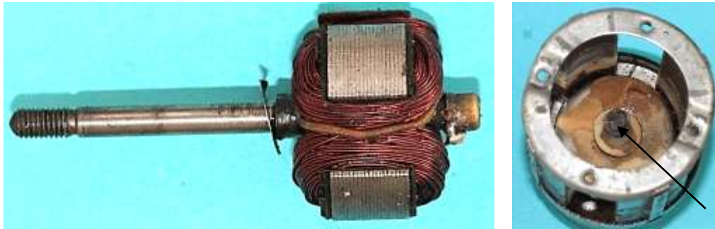
Bild 5.8: Generator: a) Ankerblechpaket, 20 Bleche, 12 mm lang, Durchmesser 33 mm , b) Spannung führende Bürste im Basistopf
