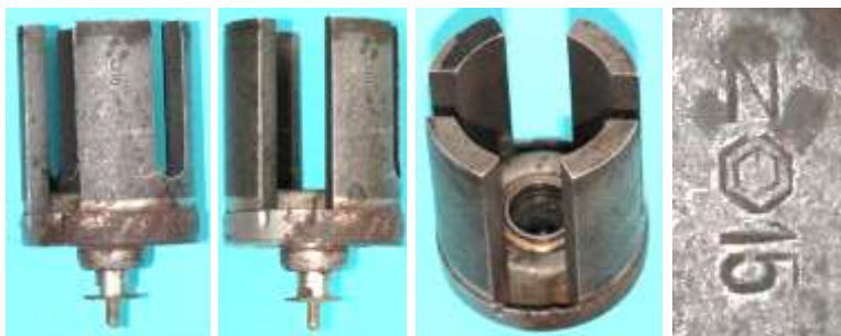
Bild 2.26: Zweiteiliges Tulpenmagnetsystem mit dem Logo des Magnetherstellers
