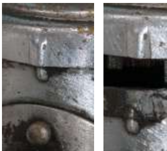
Bild 2.3: Fixierung der beiden Gehäuseteile
