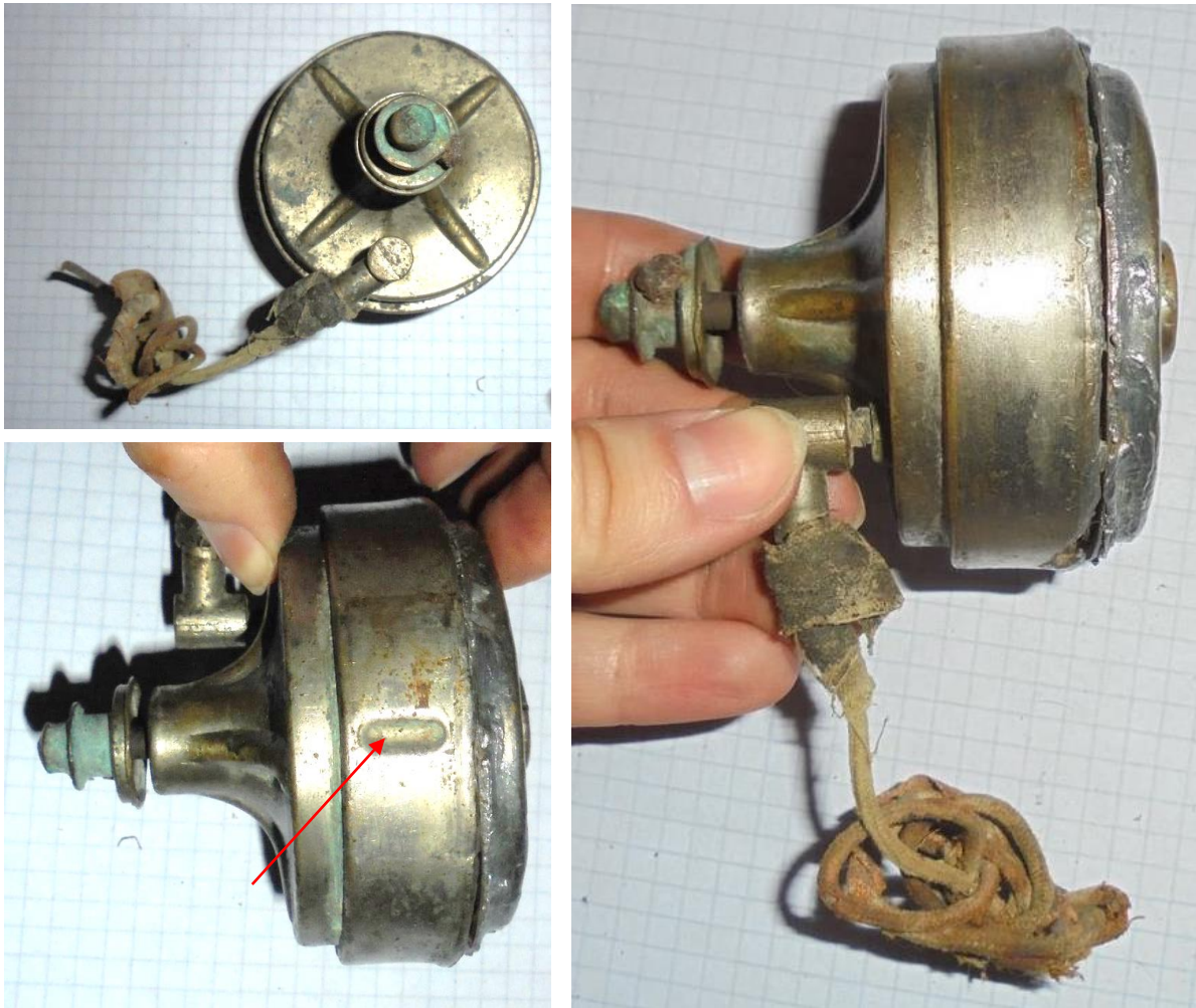
Bild 8: Ansichten des Messinggehäuses mit Steckeranschluss
