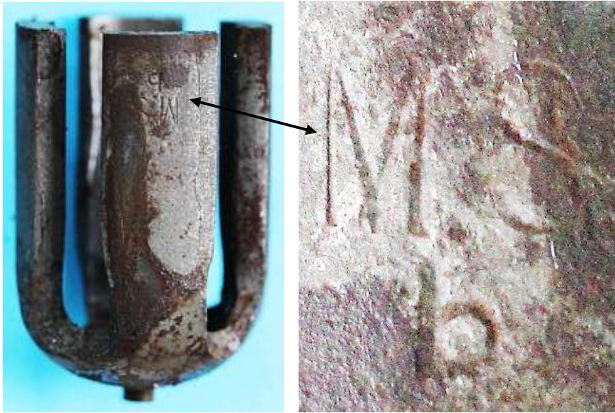
Bild 4.10: Vierpoliger Tulpenmagnet Gewicht 240 g, Länge 65 mm, Dicke 6 mm
