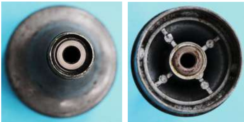
Bild 6.4: Stahlsinterlager: a) Reibradseite, b) Polradseite
