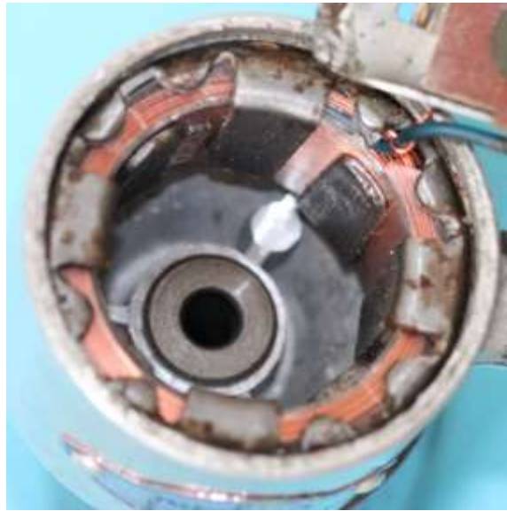
Bild 10.4: Anker mit und ohne Polrad: a) Stirnseiten des Polrades und des Ankers, b) Klauenpole und unteres Gleitlager
