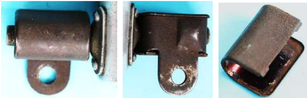
Bild 4.5: Dreiseitige Abdeckung der Kippvorrichtung mit einem aufschiebbaren Blech
