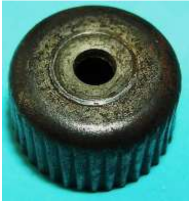
Bild 3.11: Reibradglocke mit 20 mm Durchmesser
