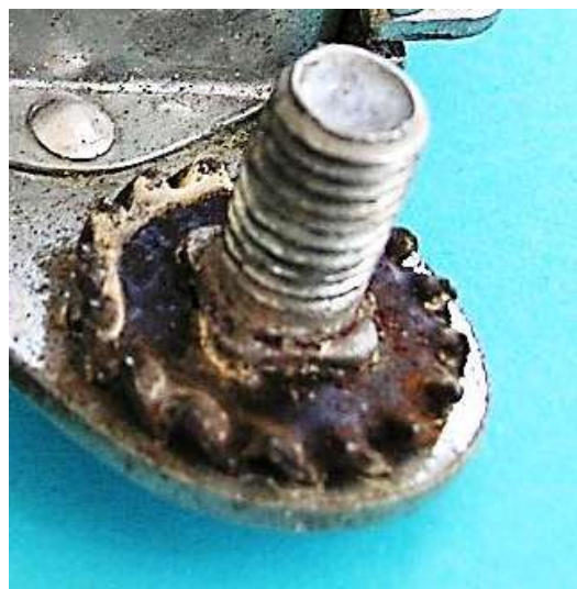
Bild 8.2: Verdreh-sichere Schraub- verbindung des Halterarms mit dem Halter
