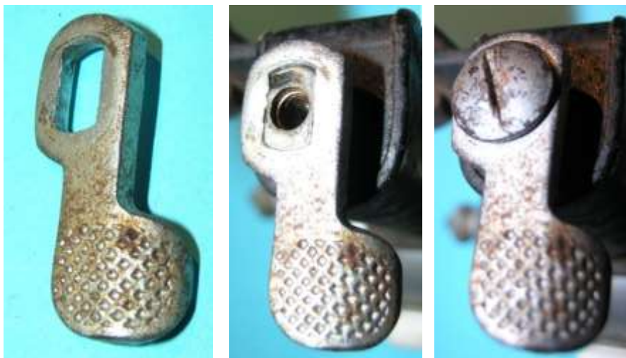
Bild 4.4: Fußpedal a) Stanzteil b) Sitz auf dem Drehbolzen c) Schlitzschraube zur Sicherung des Pedals
