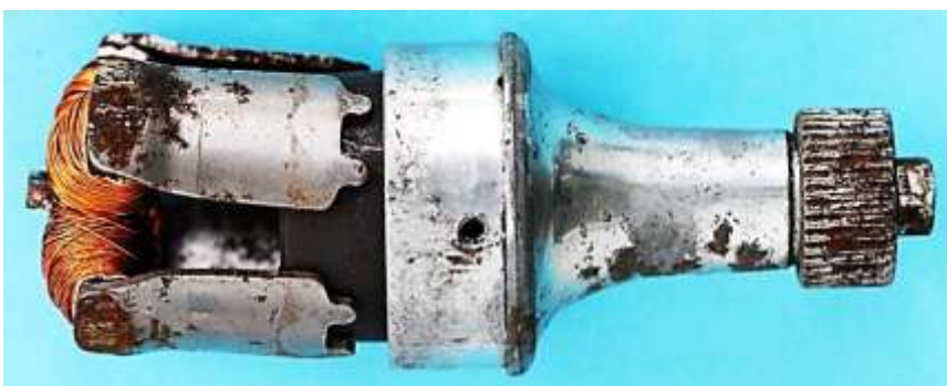
Bild 7.2: Blätterpolanker und Walzenmagnet im K819
