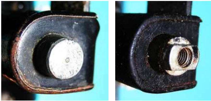
Bild 4.3: Drehbolzenausführungen: a) Stirnseite als Druckfläche, b) Bohrung und Schlüsselflächen an der Stirnseite des Bolzens
