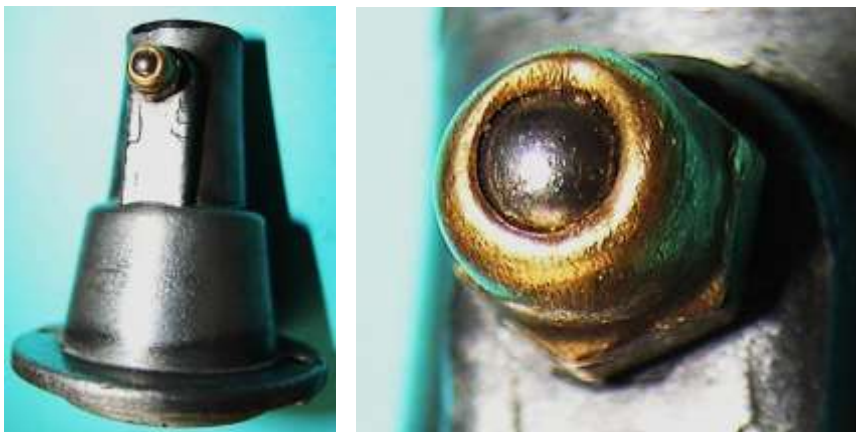
Bild 3.10: Mit einer federnden Kugel verschlossener Ölnippel
