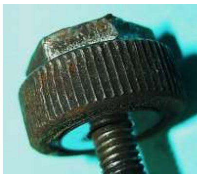
Bild 3.12: Verdecktes Reibrad mit 16 mm Durchmesser: a) Luftspalt zwischen den Reibrädern, b) Untere Reibradseite mit Anlaufscheibe, c) Kontermutter
