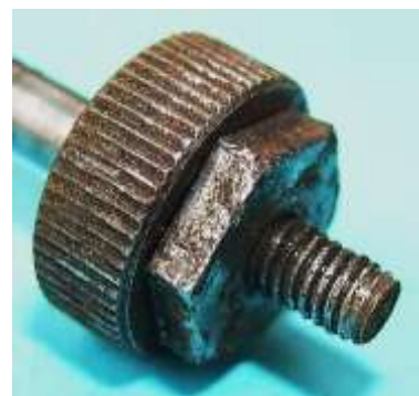
Bild 3.12: Verdecktes Reibrad mit 16 mm Durchmesser: a) Luftspalt zwischen den Reibrädern, b) Untere Reibradseite mit Anlaufscheibe, c) Kontermutter
