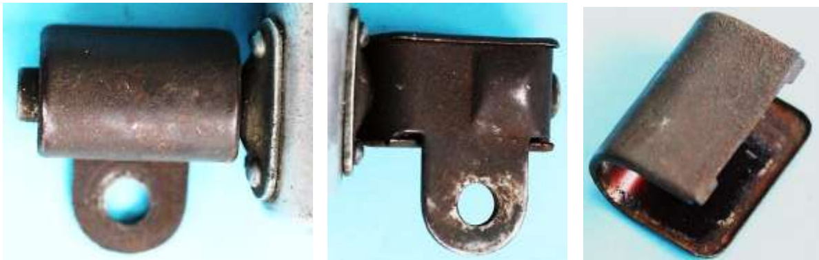
Bild 2.4: Abdeckblech der Kippvorrichtung beim Schmitt-Dynamo
