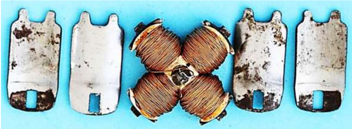
Bild 6.8: Bewickeltes Ankerjoch und vier Polschuhe (1,5 mm dick)
