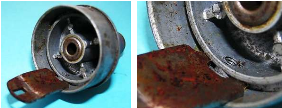
Bild 6.9: Position eines Polblechs in der Ringnut des Lagerhalsfußes
