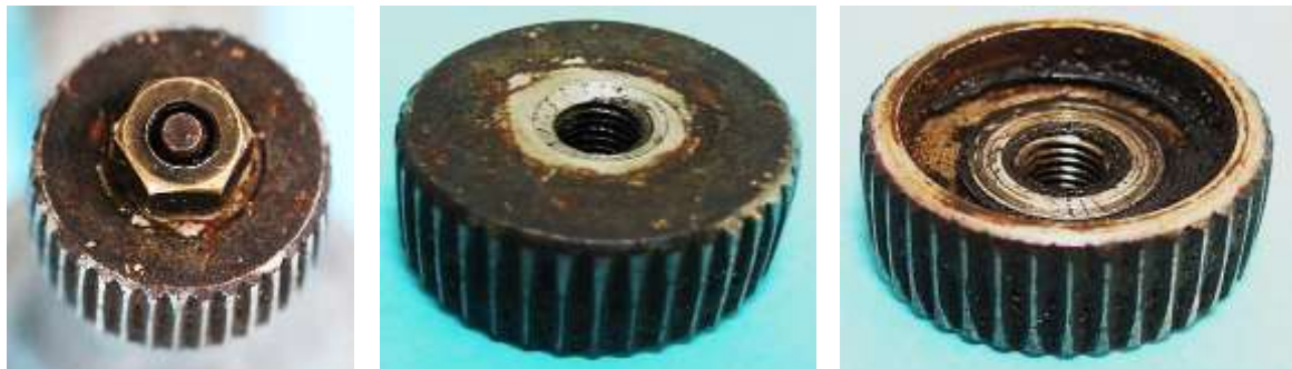
Bild 6.5: Reibrad mit Kontermutter
