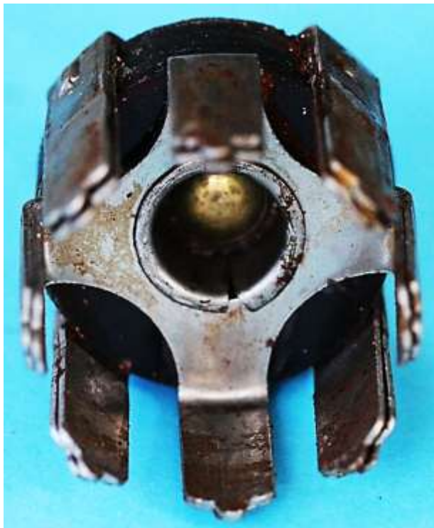
Bild 8.11: Umbörtelung des Spulenkerns: a) Seite des kurzen Klauenpolrings, b) Seite des Langen Klauenpolrings
