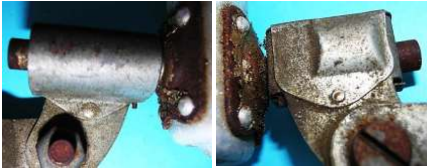
Bild 2.3: Fest vernietete Abdeckung der Kippvorrichtung beim Triepad
