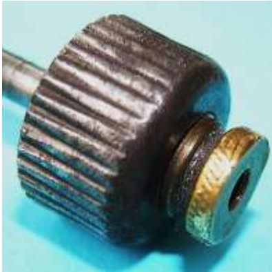
Bild 3.11: Reibradglocke mit 20 mm Durchmesser
