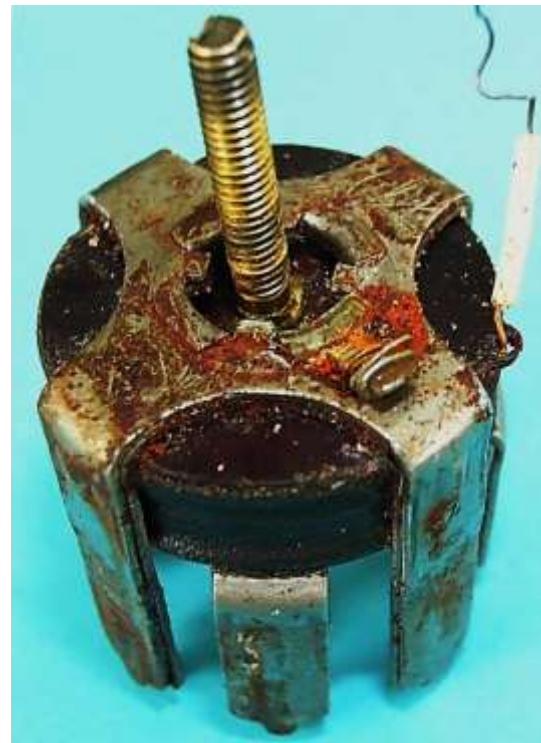
Bild 8.11: Umbörtelung des Spulenkerns: a) Seite des kurzen Klauenpolrings, b) Seite des Langen Klauenpolrings
