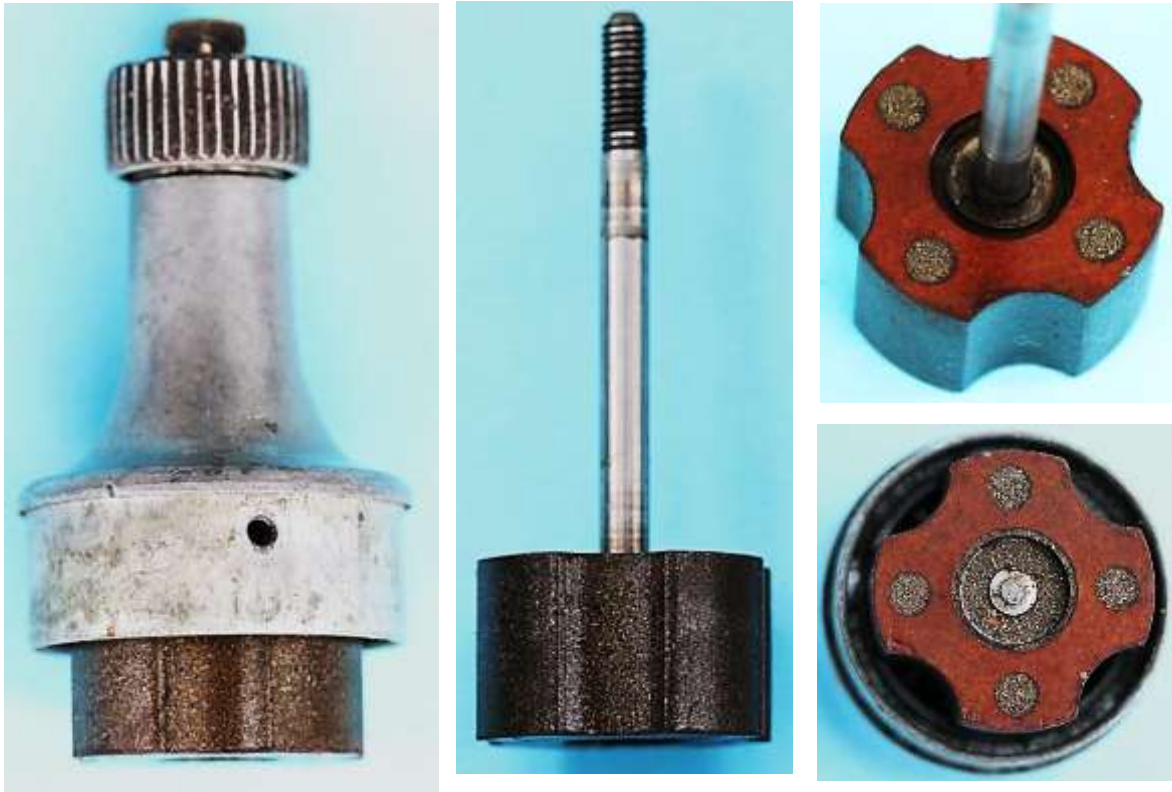
Bild 6.6: Vierpoliger AlNi-Walzenmagnet: Durchmesser 30 mm, Länge 17 mm
