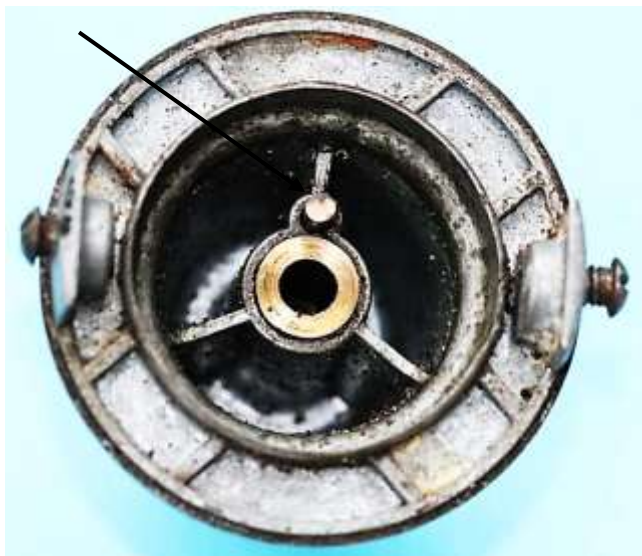
Bild 4.15: Lagerung: a) Unteres Gleitlager, b) Oberes Gleitlager mit Öldepot und Öl- schraube
