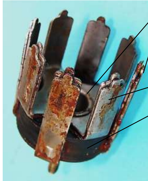
Bild 8.10: Klauenpolanker mit doppelten Polblechen
