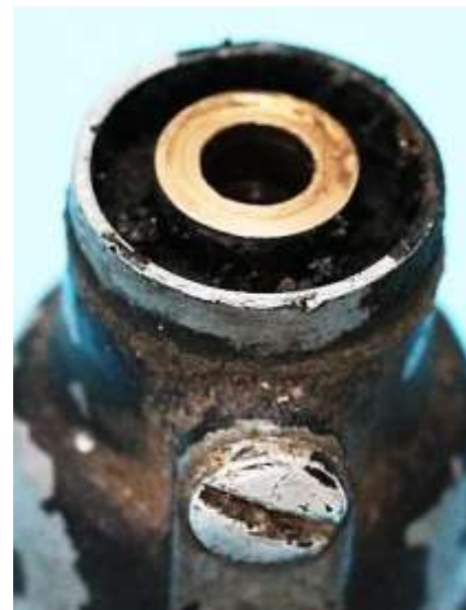
Bild 4.15: Lagerung: a) Unteres Gleitlager, b) Oberes Gleitlager mit Öldepot und Öl- schraube
