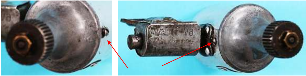
Bild 6.3: Schraubverbindung des Gehäusetopfes mit dem Lagerhals
