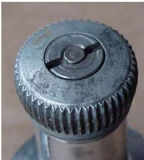
Bild 8.4: Reibrad mit versenkter Schlitzmutter
