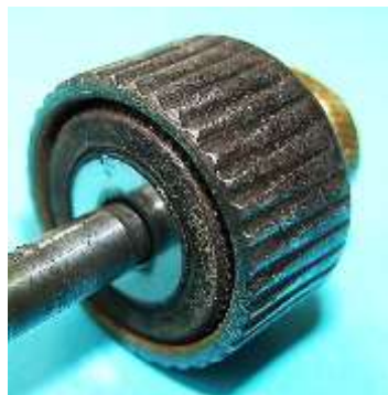
Bild 3.12: Verdecktes Reibrad mit 16 mm Durchmesser: a) Luftspalt zwischen den Reibrädern, b) Untere Reibradseite mit Anlaufscheibe, c) Kontermutter
