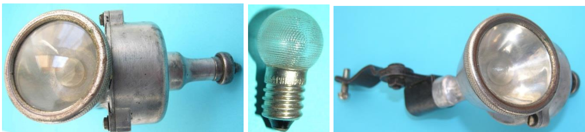
Bild 3.2: a) Lampe mit Dynamo, b) Glühbirne mit Strukturglas, c) Lampe mit Halter und Kippvorrichtung
