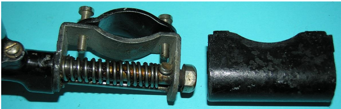
Bild 4.7: Kippvorrichtung: a) Basisblech, b) Abdeckblech
