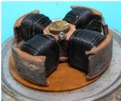
Bild 3.7: Sternanker (Jochdurchmesser 11 mm) mit Massekontakt
