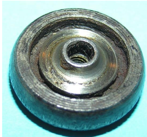
Bild 4.6: Kugellager: a) Lose Kugeln auf der Lagerschale, b) Unterseite der massiven Reibradscheibe als Kugellagerschale ausgebildet
