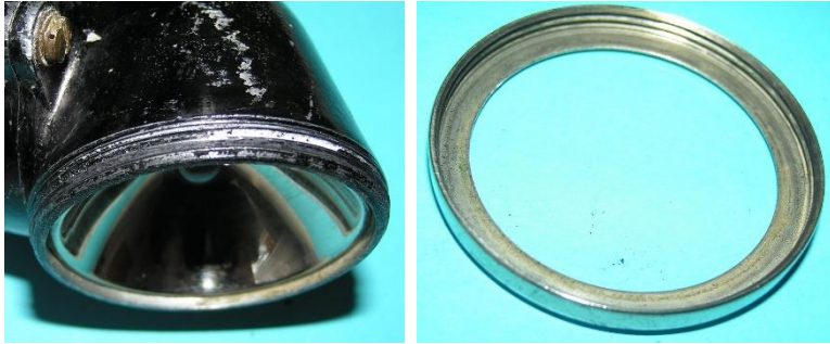
Bild 4.3: Überwurfring zur Sicherung des Lampenglases
