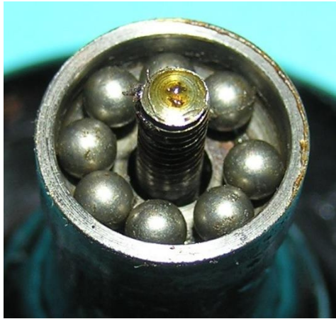
Bild 4.6: Kugellager: a) Lose Kugeln auf der Lagerschale, b) Unterseite der massiven Reibradscheibe als Kugellagerschale ausgebildet
