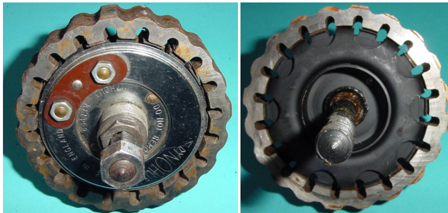
Bild 1.11: Anker und Magnetring: a) Vorderseite ohne Magnetabdeckung, b) Innenseite des Generators
