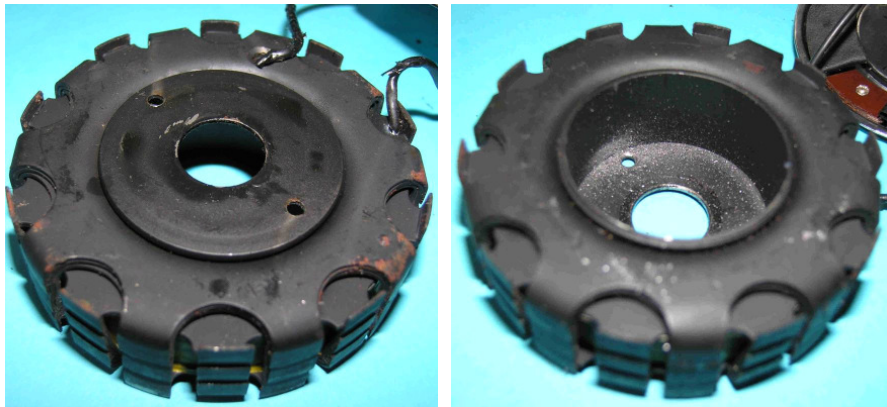
Bild 1.15: Klauenpolanker mit Buchse
