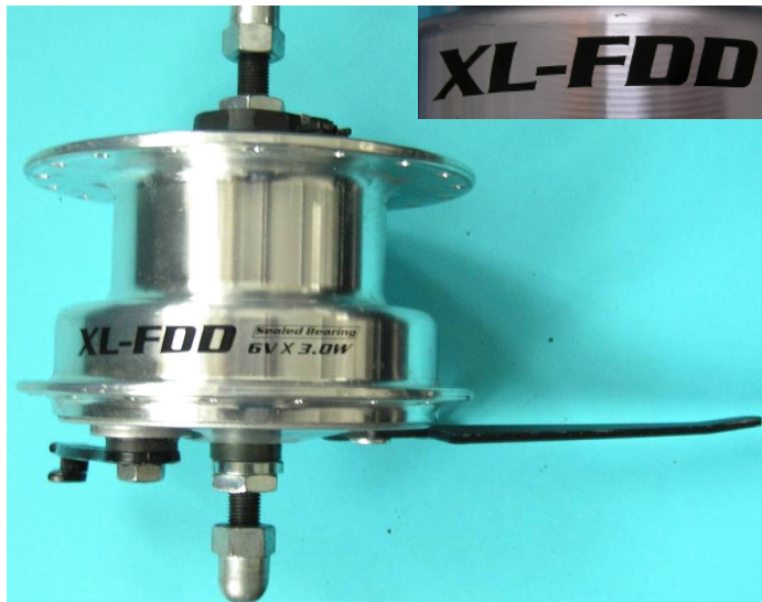
Bild 1.18: Dynamo-Bremsen-Nabe mit gleich großen Lochkränzen
