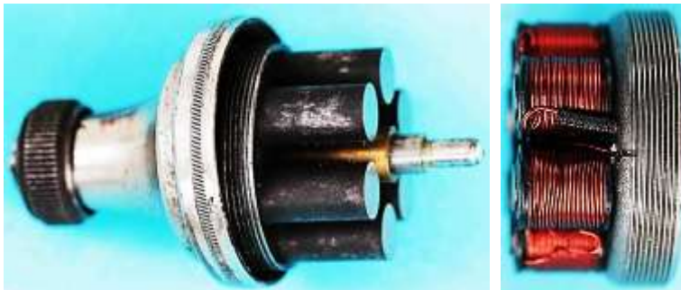
Bild 2.10: Generator: a) Polsystem und Lagerhals b) Ankerspulen und Joch (A1)
