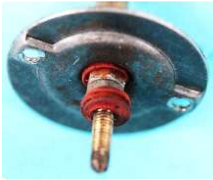
Bild 3.13: Spannteller und Bürstenhalter: a) Bürstenhalter mit Bürste, b) Kabelanschlussbolzen, c) Positionierung der Bürste außerhalb der Drehachse
