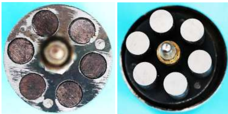
Bild 2.11: Anordnung der Säulenmagnete (A1): a) Verankerung im Joch b) Ansicht der Polflächen
