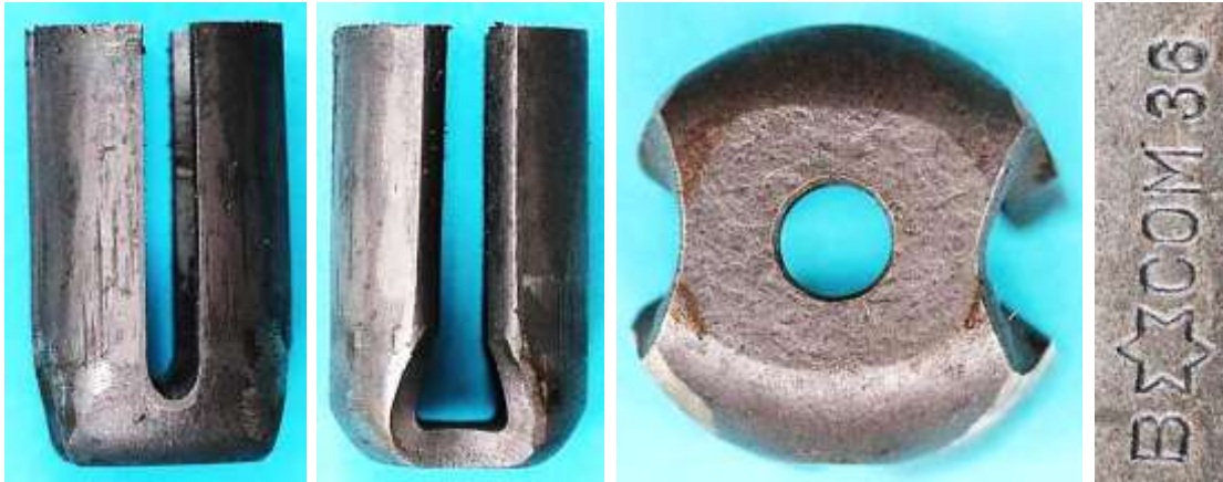
a b c d Bild 3.8: Tulpenmagnet 2,4 W-Ausführung (65mm lang, 5 mm dick): a) und b) Pollücken, c) Joch, d) Stempel der Magnetfirma Böhler-Wien
