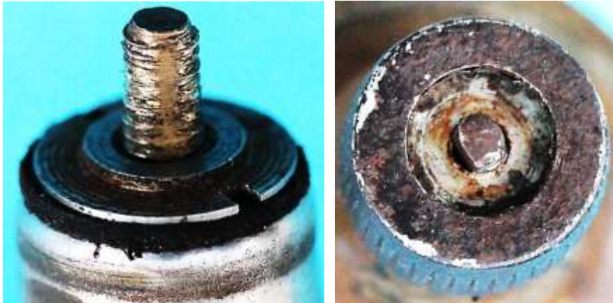
Bild 2.9: Reibrad mit Freiraum zum Versenken der Kontermutter (A2)
