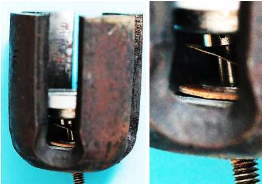
Bild 3.22: Lagerschild mit Bürstenfeder im Polsystem
