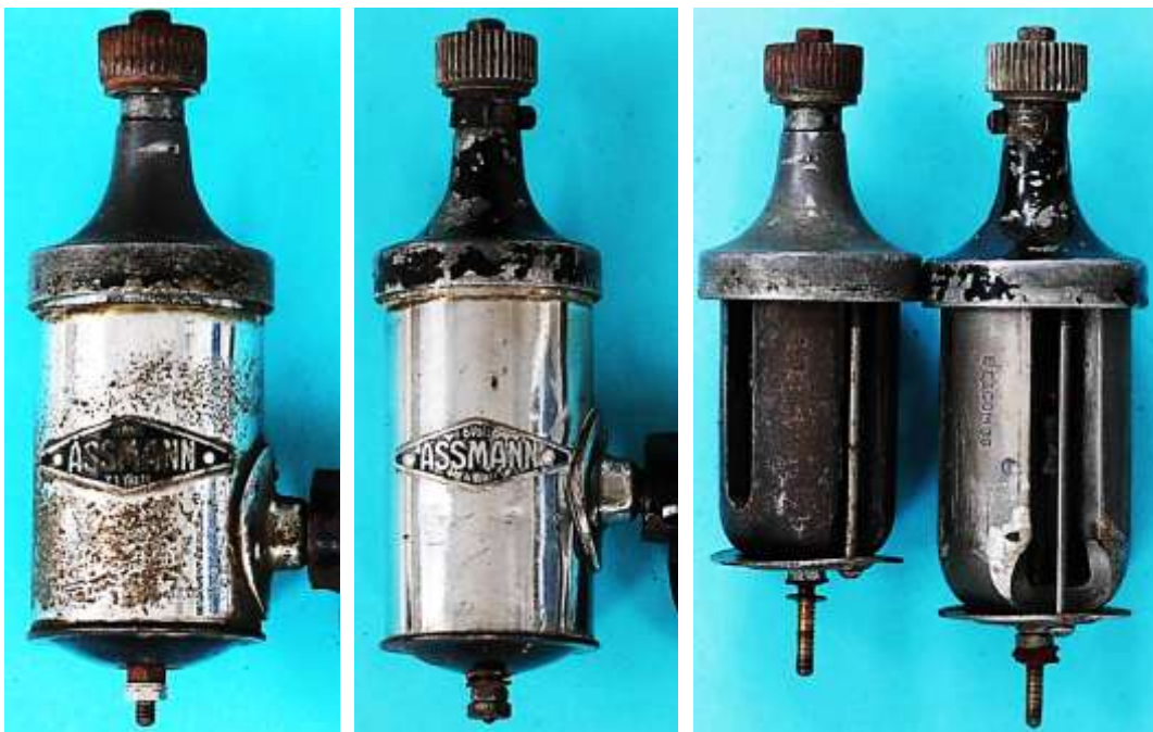
a b c d Bild 3.5: Gegenüberstellung der beiden Ausführungen mit dem dreiteiligen Gehäuse
