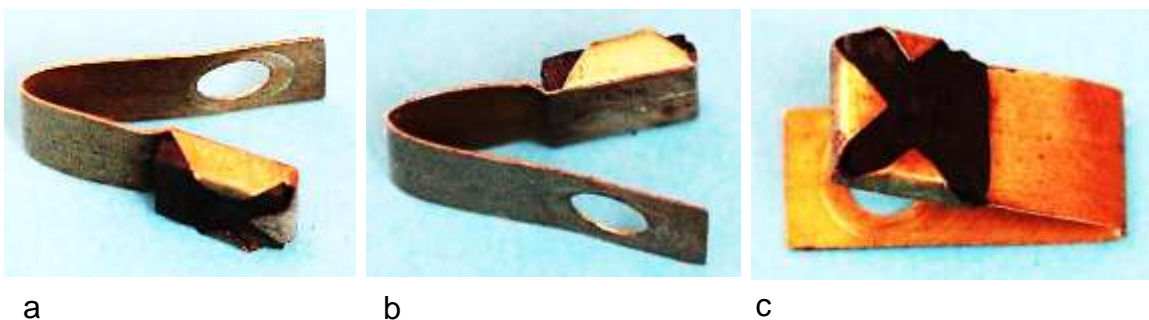
Bild 3.21: Blattfeder mit eingeklemmter Kohlebürste
