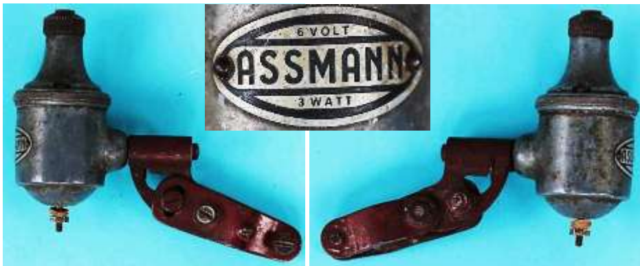
Bild 3.14: Dynamo mit Zinkdruckgussgehäuse
