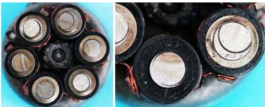
Bild 2.16: Spulenanordnung: a) Spulen mit einer Unterlegscheibe gesichert, b) Eine Unterlegscheibe entfernt, Stempel auf dem Spulenkörper: TN2517 (A1)
