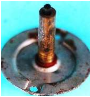
Bild 3.13: Spannteller und Bürstenhalter: a) Bürstenhalter mit Bürste, b) Kabelanschlussbolzen, c) Positionierung der Bürste außerhalb der Drehachse
