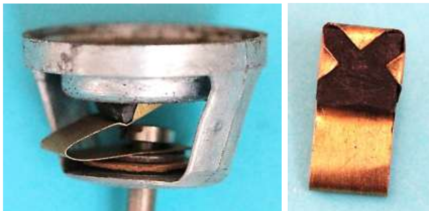
Bild 3.23: Spannung führende Blattfeder: a) Position im Lagerschild, b) Kohleblock am Ende der Blattfeder
