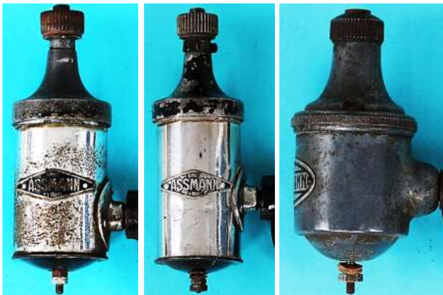
Bild 1.2: Tulpenmagnetdynamos a) 2,1 W, b) 2,4 W, c) 3 W
