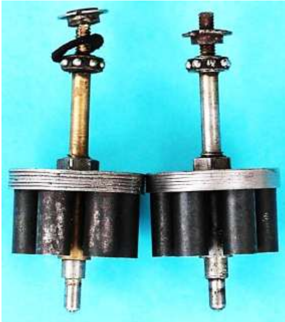
Bild 2.12: Polräder mit Messing (A1) und Stahlwelle (A2), Zusammensetzung des Magnetmaterials Fe = 72.11 Co = 14.38 Cr = 11.13 Mo = 2.26 Au = 0.13
