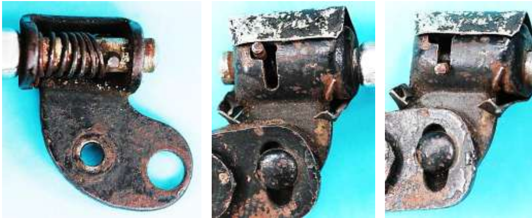
Bild 2.6: Kippvorrichtung: a) Drehbolzen mit Spannfeder und Sperrstift, b) Haltestellung, c) Betriebsstellung
