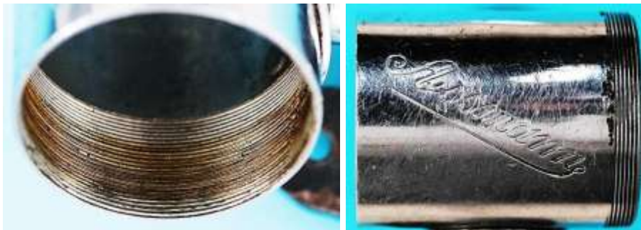
Bild 2.4: Gehäusese- mantel: a) Feingewinde im Lagerhalsfuß b) Mantel mit Feingewinde
