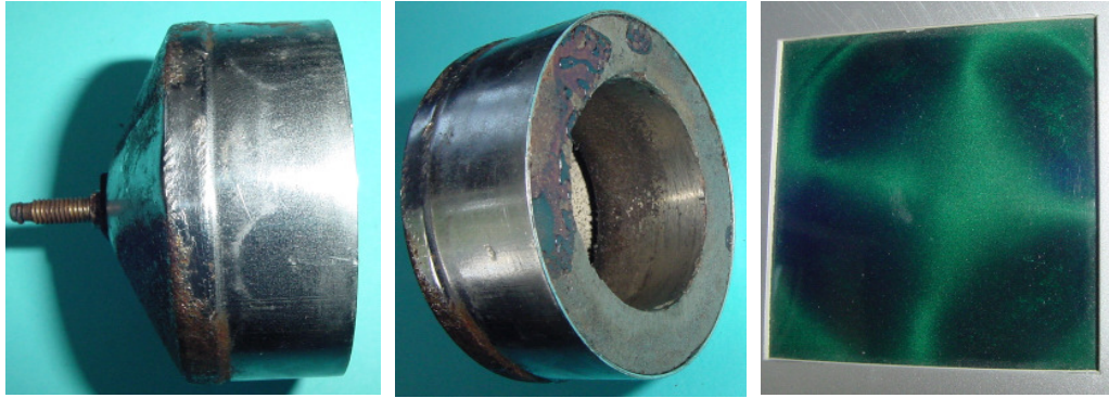
Bild 1.8: Bodentopf mit vierpolig aufmagnetisiertem Ringmagneten
