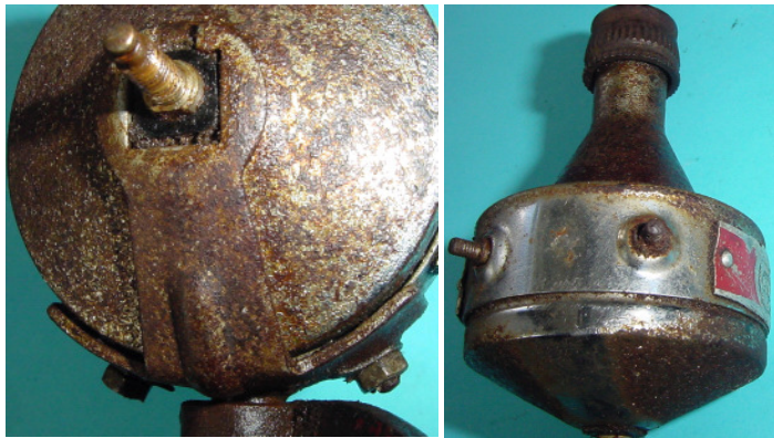
Bild 1.6: Befestigungspunkte a) am Gehäuseboden, b) am Gehäusemantel
