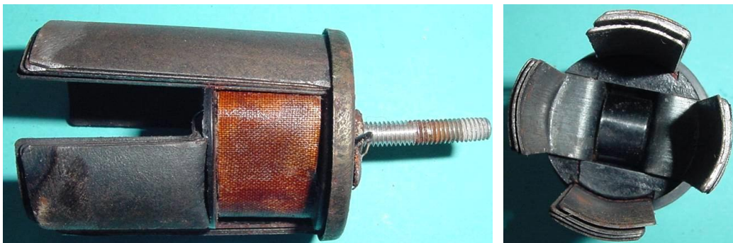
Bild 3.3: Klauenpolanker: a) Langer und kurzer ferromagnetischer Schenkel, b) Von den Schenkeln aufgespannter Raum für das Polrad
