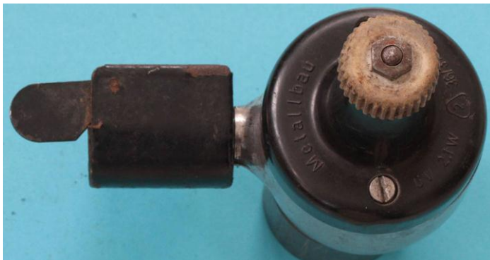
Bild 2.2: Blick auf das Reibrad und den Lagerhalsfuß
