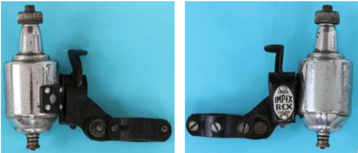
Bild 1.23: Impex-Rex mit dem Kabelanschlussbolzen im Boden
