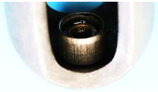
Bild 1.22: Spurlager: a) Welle im Lager, b) Position des Lagers im Magnetjoch, c) Öldepot
