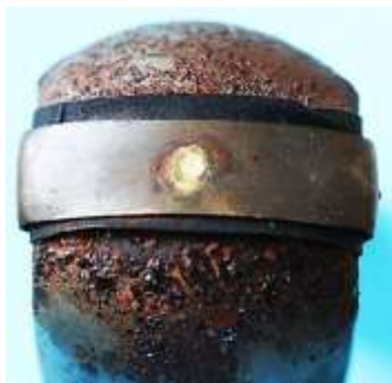
Bild 1.30: Kontaktblechbasis: a) Isolierte Lage auf dem Joch, b) Kontaktblech von unten, c) Oberfläche des Kontaktblechs (Pfeile zeigen auf die gleiche Kontaktblechkante)
