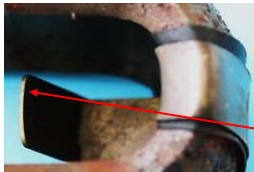
Bild 1.30: Kontaktblechbasis: a) Isolierte Lage auf dem Joch, b) Kontaktblech von unten, c) Oberfläche des Kontaktblechs (Pfeile zeigen auf die gleiche Kontaktblechkante)
