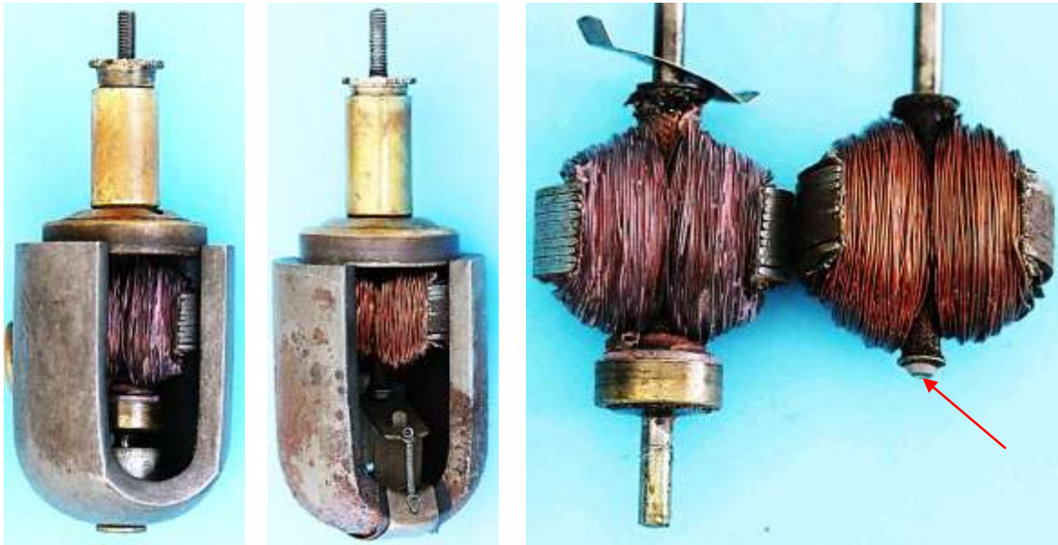
Bild 1.27: Gegenüberstellung der Anker: a) Generator mit zweiseitiger Lagerung, b) Einseitige Lagerung des Läufers, c) Anker mit Schleifring, d) Anker mit Kontaktfläche an er Stirnseite des freien Wellenendes
