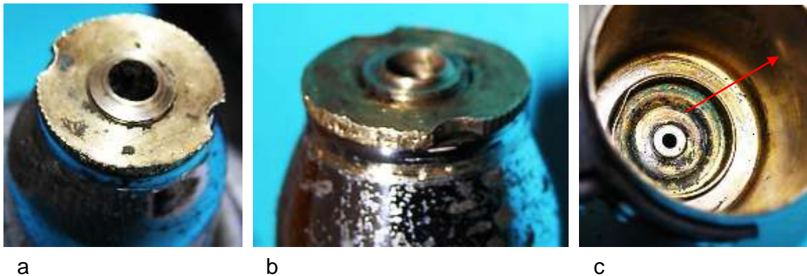
Bild 1.7: Verschraubung des Lagerrohrs: a) Bundmutter zur Befestigung des Lagerrohrs, Riffelung und Schlüsselkerben am Bund, c) Lagerschild
