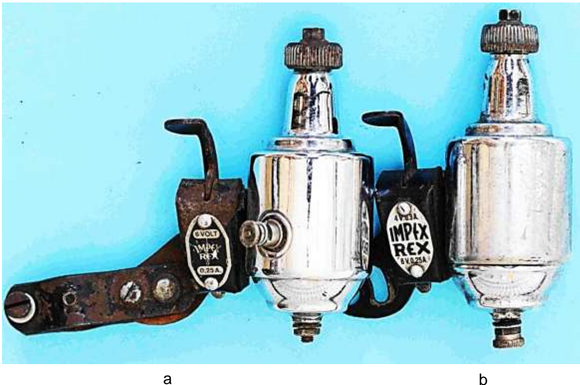
Bild 1.1: Zwei Ausführungen des Typs Impex-Rex: a) Kabelanschluss am Gehäusemantel, b) Kabelanschluss am Boden
