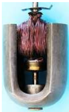
Bild 1.22: Spurlager: a) Welle im Lager, b) Position des Lagers im Magnetjoch, c) Öldepot
