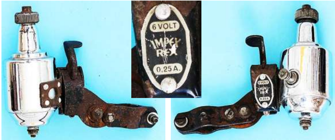
Bild 1.11: Impex Rex für 1,5 W: Dynamokörper mit Kippvorrichtung und Halter
