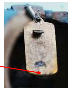
Bild 1.30: Kontaktblechbasis: a) Isolierte Lage auf dem Joch, b) Kontaktblech von unten, c) Oberfläche des Kontaktblechs (Pfeile zeigen auf die gleiche Kontaktblechkante)
