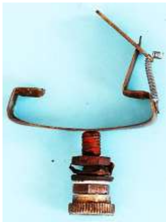
Bild 1.29: Federblechklammer: a) Kontakt mit dem Kabelanschlussbolzen, b) Dreiteiliger Aufbau
