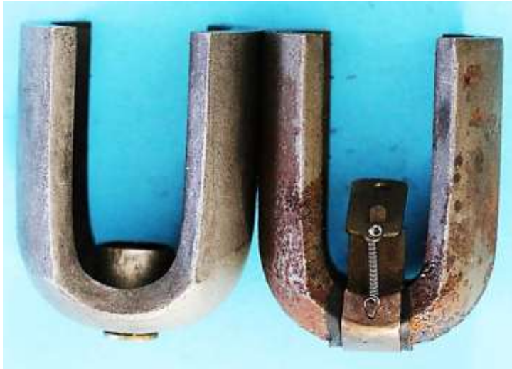
Bild 1.4: Zweipolige Tulpenmagnete: a) Mit Spurlager, b) Mit Schleifkontakt
