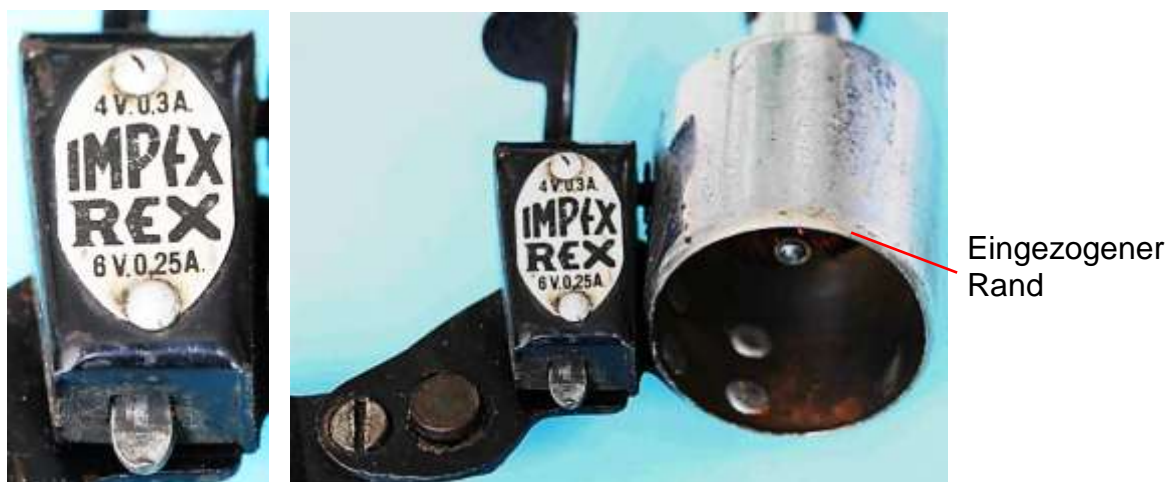
Bild 1.24: Leistungsschild mit den empfohlenen Lampenwiderständen von 13 Ohm und 24 Ohm
