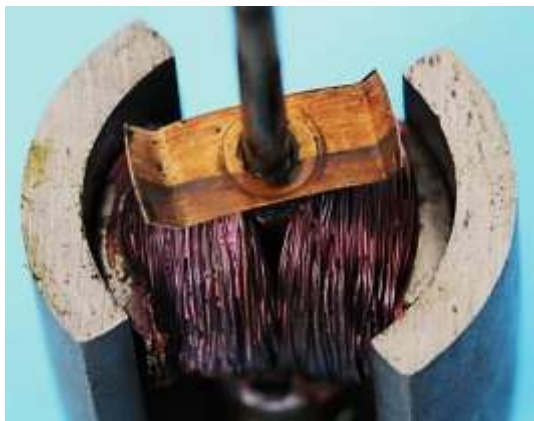
Bild 1.21: Massekontakt: a) Kontaktfeder mit zwei Kontaktstellen, b) Schleifring
