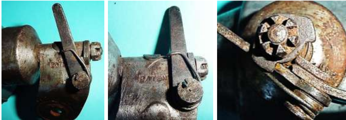
Bild 5.5: Ent- und Verriegelung: a) Betriebsstellung, b) Ruhestellung, c) Nockenscheibe mit dem Hebel in der Ruhestellung
