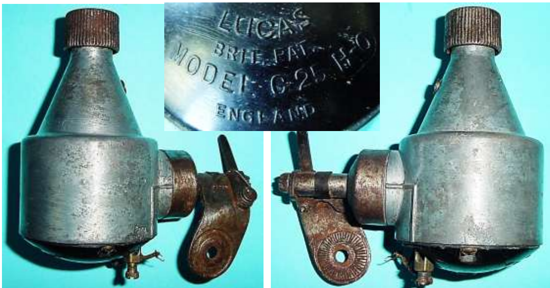
Bild 5.1: Lucas C25 H-O: Durchmesser: 62 mm, Höhe: 116 mm, Gewicht: 680 g
