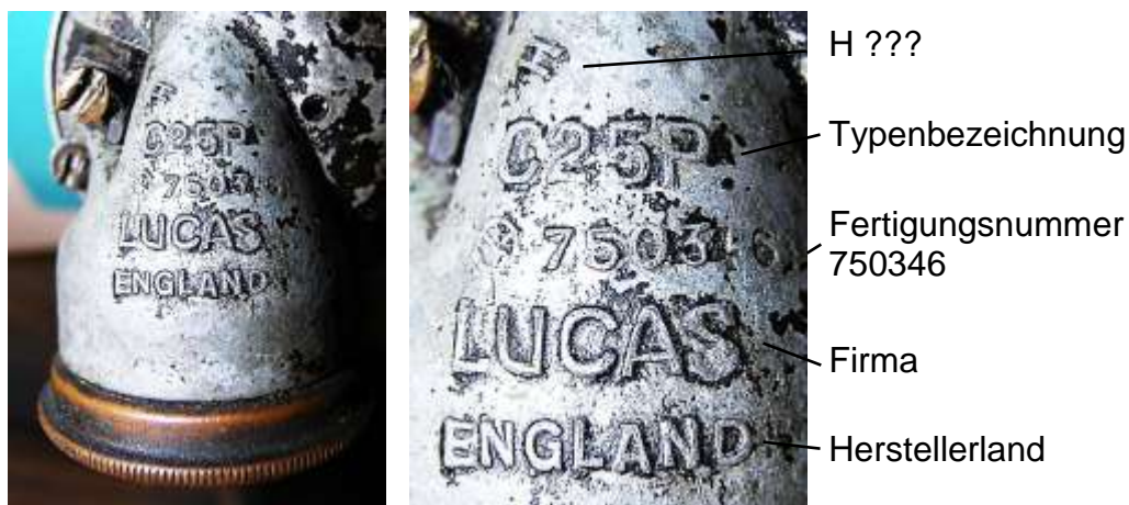
Bild 6.2: Schriftfeld auf dem Gehäuseteil des Rücklichts
