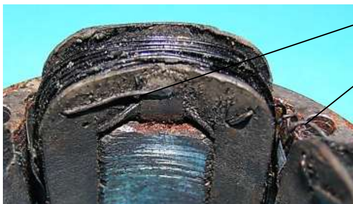
Bild 4.16: Lötstelle am Blechpaket
