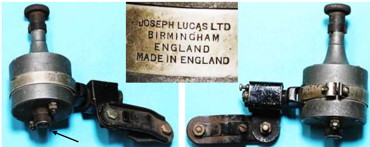
Bild 3.1: Erster Fahrraddynamo von Lucas 2B, Am Boden sind die nicht sicher zu interpretierende Zahlen eingeprägt: 2B- 1768
