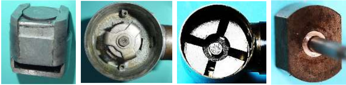
Bild 2.4: Dauermagnetvarianten: a) Zweipoliger Säulenmagnet im No 25 und C25-2, b) Durchbohrter Säulenmagnet im C25 H-0, c) Vierpoliges Stabmagnetpolrad im C175A-O, d) Zweipoliges AlNi-Polrad im CD18 und CD33
