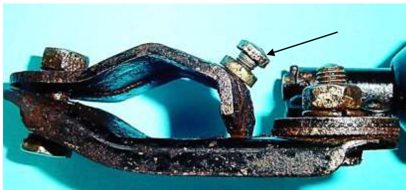
Bild 4.19: Position der Masseschraube
