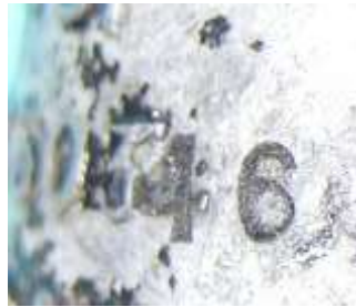
Bild 6.3: Fertigungsnummer a) Vorangestellter dreiteiliger Kreis b) Eingeschlagene Ziffern 46
