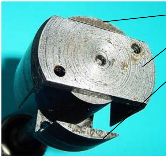
Bild 4.12: Axial magnetisierter Magnet mit Klauenpolen
