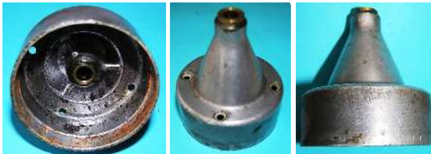
Bild 4.8: Zweiteiliges Gehäuse aus Lagerhalstopf und Bodentopf
