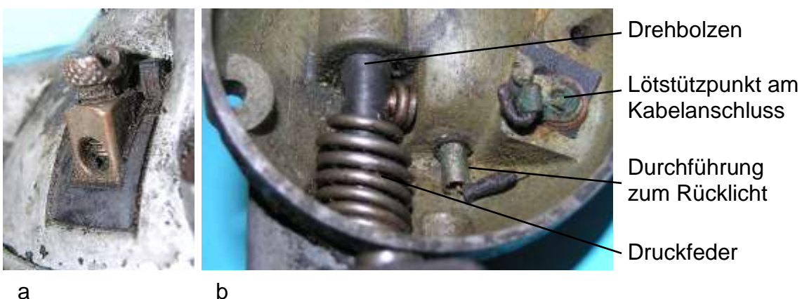
Bild 6.8: Funktionsgruppen im Boden: a) Kabelanschlussklemme, b) Drehbolzen, Druckfeder und Spannung führende Anschlüsse
