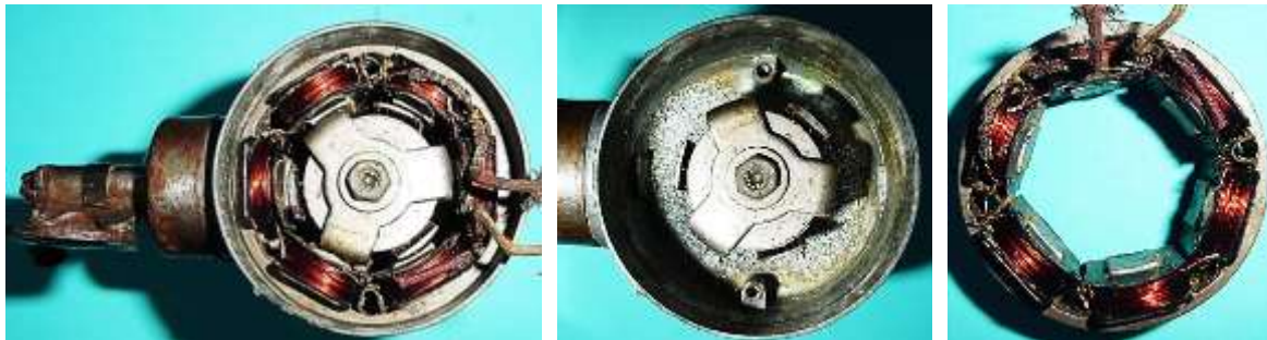
Bild 5.6: Elektromagnetisch aktive Baugruppen des Generators: a) Anker und Läufer bei entferntem Boden, b) Gehäuse mit Polrad, c) Blechpaket mit Ankerspulen
