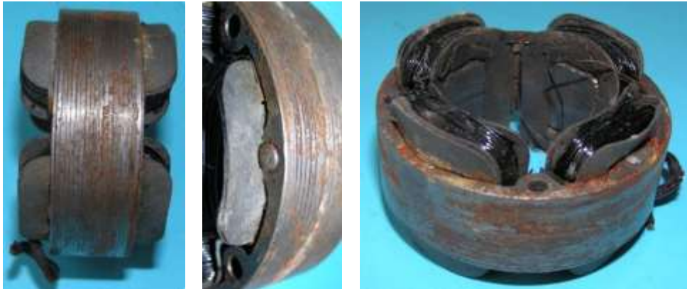
Bild 4.14: Anker: a) 18 mm langes Blechpaket aus 20 Blechen, b) Eine der vier Blechpaketnieten, c) Ausgeprägte Pole mit Kastenspulen
