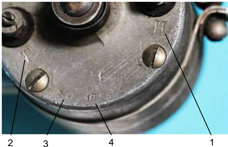
Bild 3.2: Kennzeichnungen am Boden 1: Scheinwerferanschluss: H = head 2: Rücklichtanschluss: T = tail, 3: Mögliche Typenbezeichnung: 2B, 4: Mögliche Fertigungsnummer 1769
