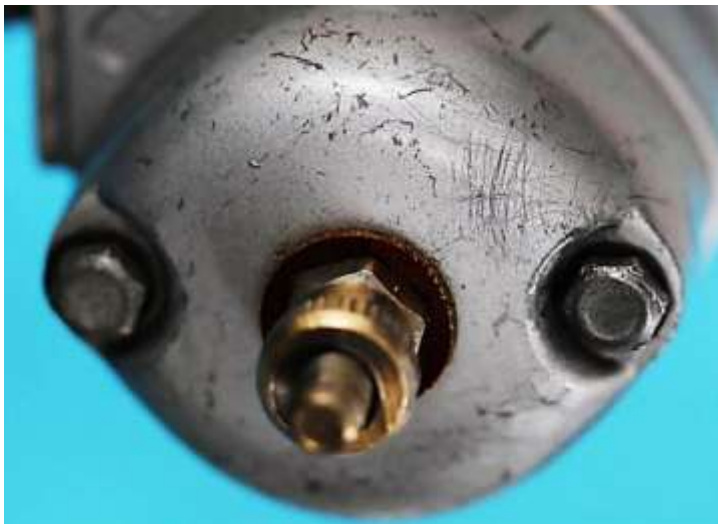
Bild 10.4: Befestigung der Ge- häuseteile mit Schlüsselschrauben
