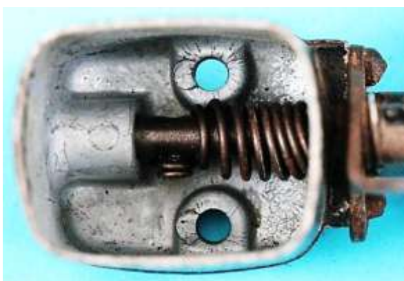
Bild 9.9: Druckfeder im Boden
