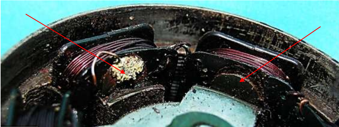
Bild 6.9: Lötstelle an einem der abgerundeten Endbleche
