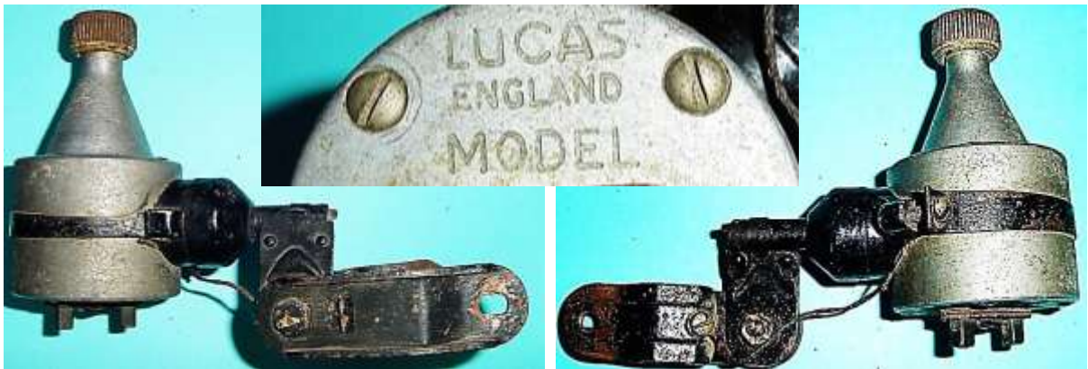
Bild 4.1: Lucas C25C-2: Durchmesser: 63 mm, Höhe: 107 mm, Gewicht: 930 g
