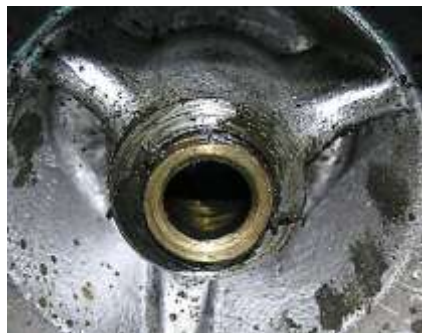
Bild 4.10: Stirnseiten des Lagerrohres: a) 2,5 mm breite Stirnseite des Lagerrohres, b) Lagerrohr mit 2 mm Wandstärke
