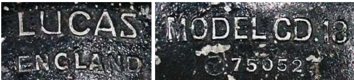
Bild 9.6: Schriftzüge auf dem Boden: Herstellerland, Typenbezeichnung und Fertigungsnummer
