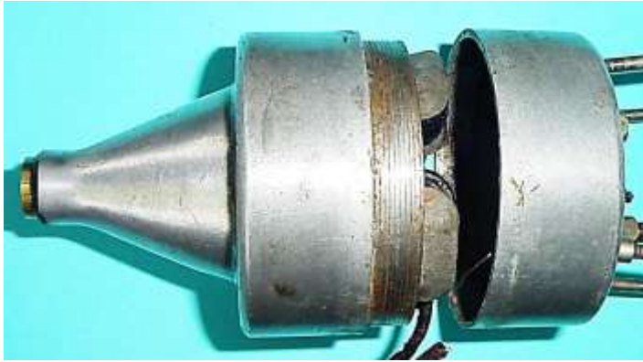
Bild 4.9: Stoßstelle der Gehäuseteile in der Blechpaketmitte
