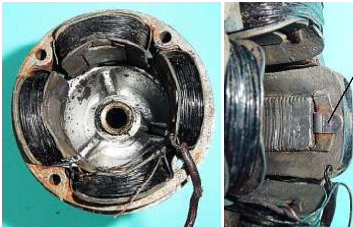
Bild 4.15: Anker a) Anker im Lagerhalsgehäuse, b) Befestigung der Polspulen
