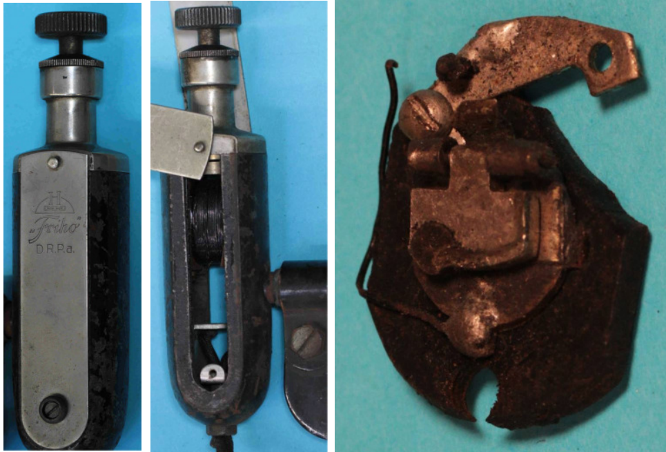
a b c Bild 1.2: Friho mit Fliehkraftschalter: a) Position des Pollückenblechs, b) Freier Bau- raum für den Fliehkraftregler zwischen Anker und Magnetjoch, c) Reste des Flieh- kraftreglers
