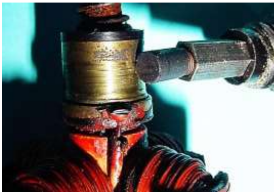
Bild 2.8: Bürstenhalter mit Bürste und Kabelanschlussbolzen
