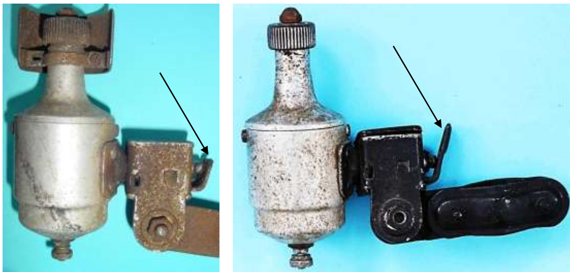
Bild 4.15: Typ L65 mit zwei unterschiedlich langen Bedienungshebeln
