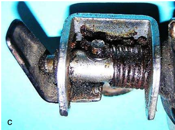
Bild 4.19: Drei Ansichten des Drehbolzens in der Ruhestellung
