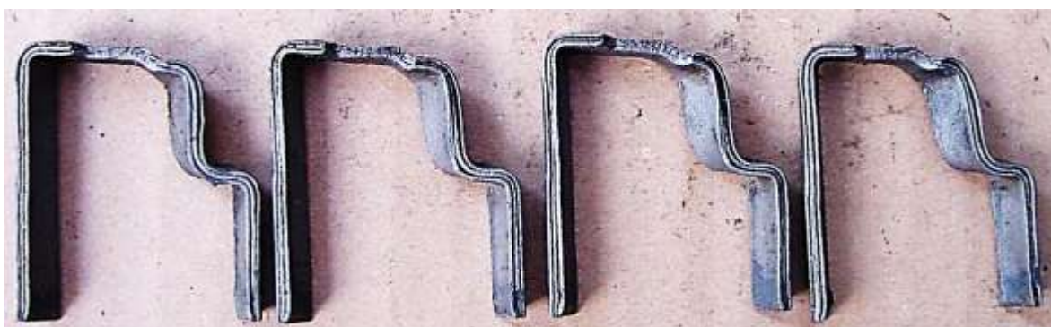
Bild 5.8: Vier Polpaare jeweils aus drei Blechstreifen geformt
