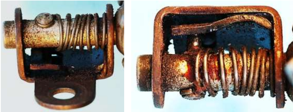
Bild 3.6: Angenietetes Winkelkulisseeblech im Lohmann-Dynamo
