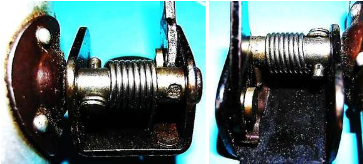
Bild 2.13: Druck und Blattfeder: a) Befestigung am Rahmen und am Drehbolzen, b) Gleitflächen zwischen Hebel und Sperrstift und zwischen Hebel und Blattfeder
