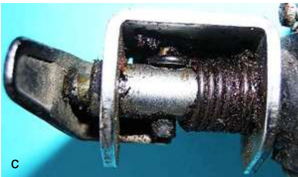
Bild 4.20: Drehbolzen in der Betriebsstellung
