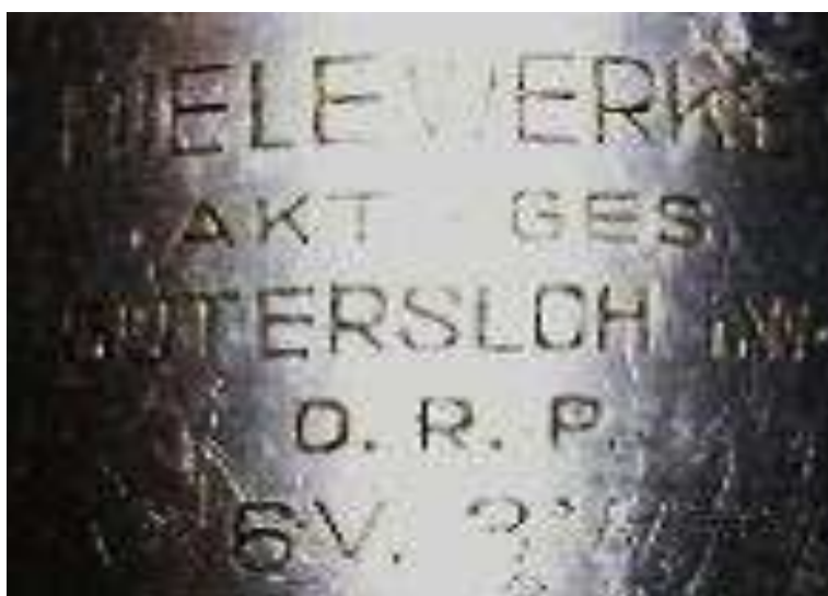
Bild 3.20: Auf dem Gehäusemantel eingepprägtes Firmen- und Leistungsschild: Miele Werke Akt-Ges. Gütersloh D.R.P. 6 V, 3 W
