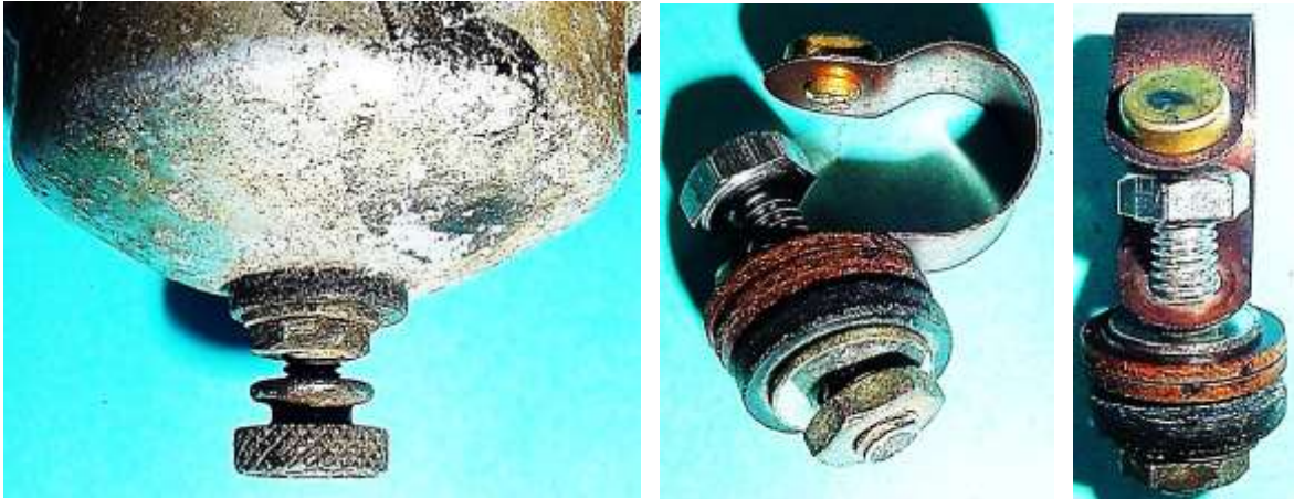
Bild 4.10: Kabelanschlussbolzen: a) Im Boden isoliert eingesetzt, b) Blattfeder, c) Kontaktfläche für dem rotierenden Kontakt am Wellenende
