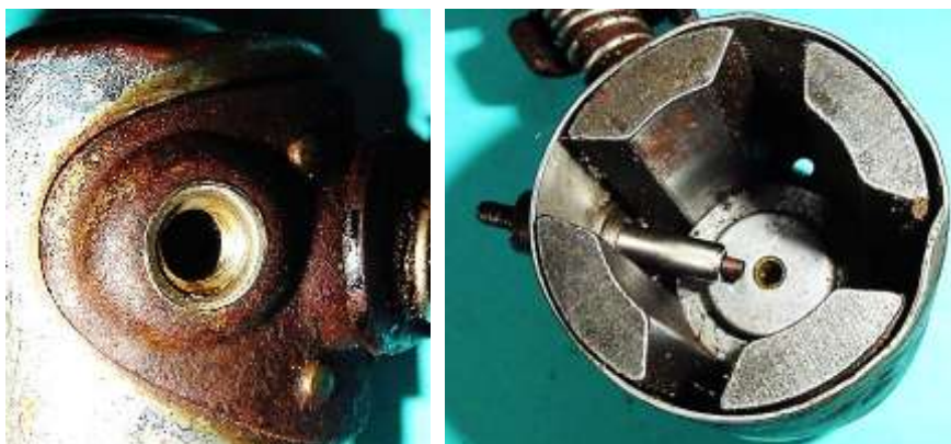
Bild 3.16: Sitz des Kabelanschlussbol- zens a) Buchse mit Innen- gewinde im Flansch b) Eingeschraubter Kabelanschlussbol- zen mit Bürste
