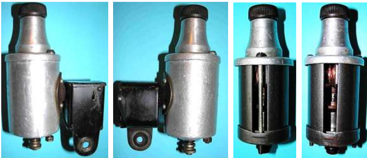
Bild 3.19: Gehäuse, Reibrad und magnetischer Kreis in Übereinstimmung mit den Lohmannmodellen
