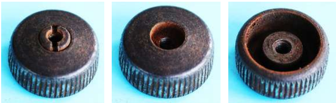
Bild 3.4: Von Miele und Lohmann eingesetzte Reibräder
