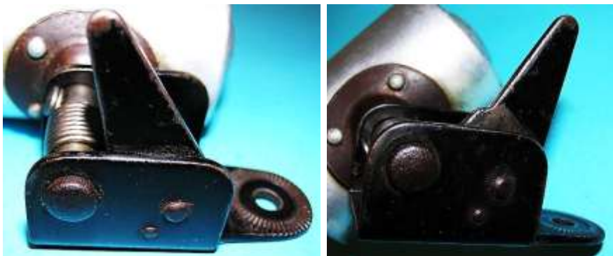
Bild 2.14: Hebelstellungen; a) Eingerastet, b) Ausgerastet
