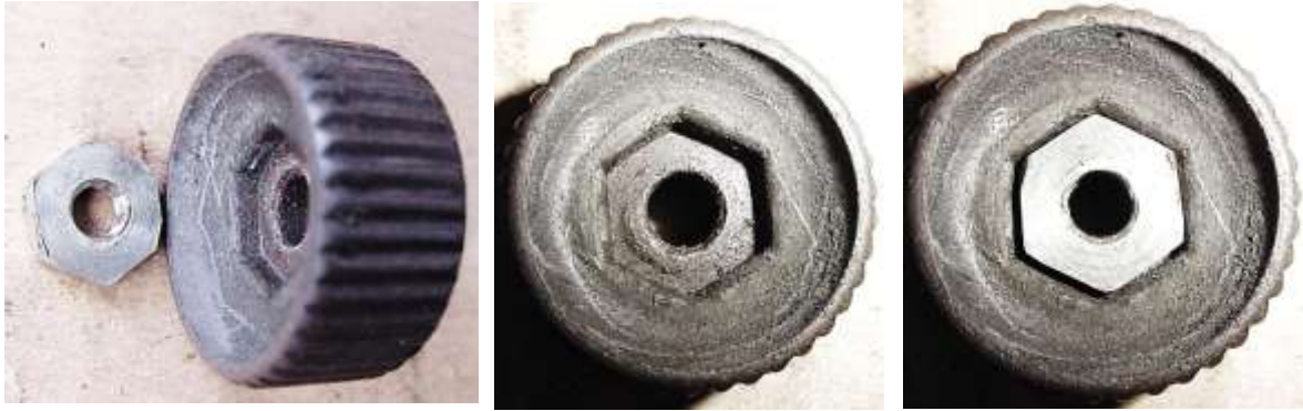
Bild 5.5: Reibrad aus Speckstein mit eingelegter Kontermutter
