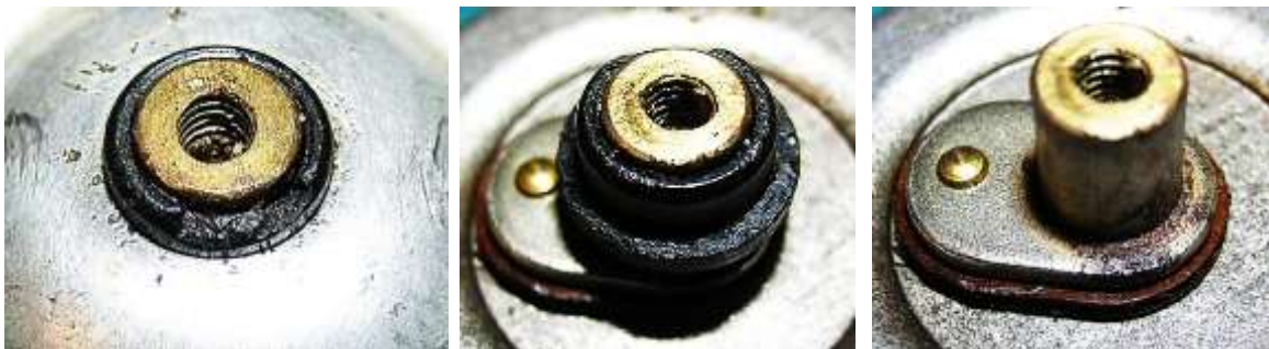
Bild 3.22: Gewindehülse: a) Bodenansicht, b) Adapter mit Isolierhülse, c) Kontaktbrücke mit Adapter am Joch des Erregersystems
