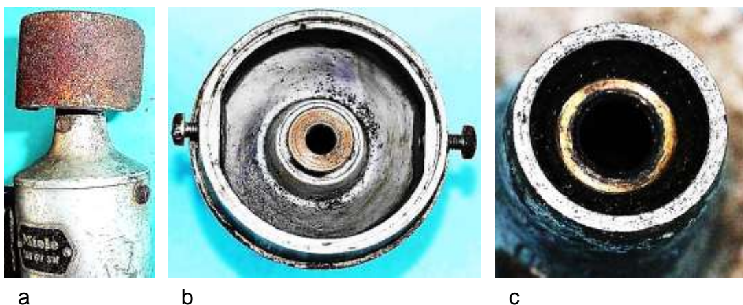
Bild 4.9: Befestigung des Lagerhalses am Gehäusetopf: a) Schnittstelle zwischen den Gehäuseteilen, b) Lagerhalsfuß mit den zwei Schrauben und dem unteren Gleitlager, c) Oberes Gleitlager
