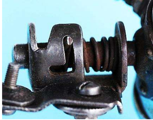
Bild 3.8: Ergänzung des dreiseitigen Basisblechs mit einer abgewinkelten Stirnseite, in der die Winkelkulissee eingeschnitten ist.
