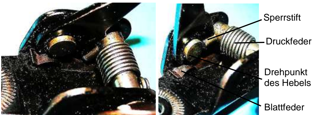
Bild 2.15: Positionsänderung der Blattfeder
