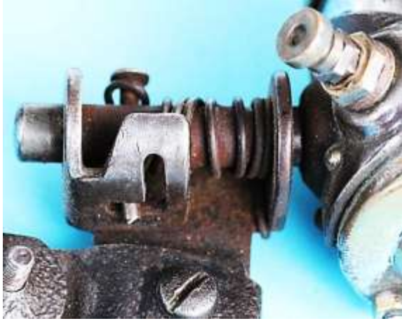
Bild 3.8: Ergänzung des dreiseitigen Basisblechs mit einer abgewinkelten Stirnseite, in der die Winkelkulissee eingeschnitten ist.
