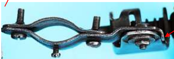
Bild 3.10: Miele-Halter mit abgewinkeltem Anschlag
