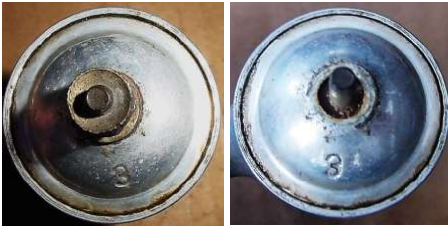
Bild 5.3: Festsitz des Bodens durch Umbörtelung des Lagerhalstopfes
