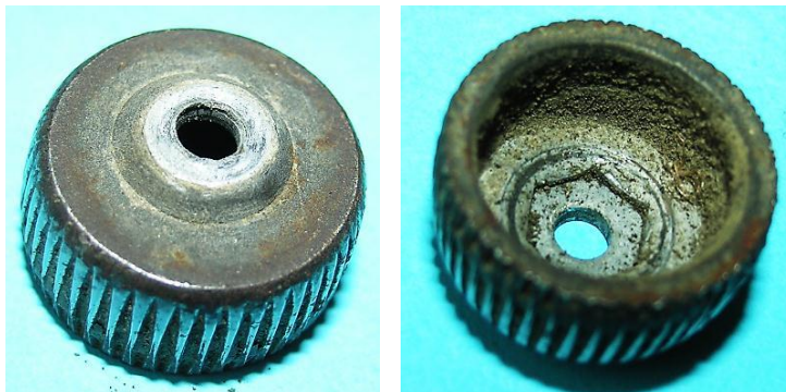
Bild 9.7: Reibrad als Kappe mit einem Innensechskant ausgeführt
