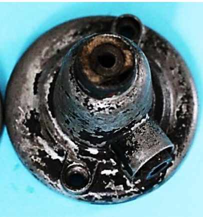
Bild 6.8: Gegossener Lagerhals mit Aluminiumkappe: a) Impex-Super, b) Impex Saba, c) Ansicht mit drei Durchbrüchen
