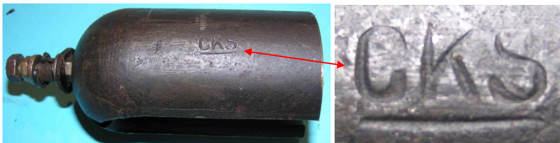
Bild 8.8: Stempel des Magnetherstellers Carl Kuhbier & Sohn, Dahlerbrück (ab 1975 zu Thyssen Edelstahl Magnetfabrik Dortmund), Magnetgewicht 235 g, Wandstärke 5 mm, Höhe 60 mm
