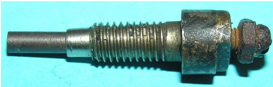
Bild 6.38. Bürstenhalter mit Kabelanschlussbolzen: 1-Bürstenfeder, 2-Kupferbürste 3-Bürstenhalter 4-Kabelanschlussbolzen
