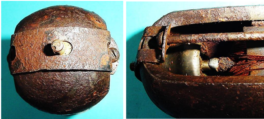
Bild 7.26: Befestigung des Spurlagers in der Mitte des Magnetjochs
