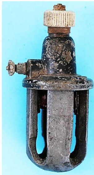
Bild 10.24: Vierpoliger Magnet: a) Dynamokörper, b) Am Lagerhalsfuß angespresster Magnet, c) Firmenlogo der Magnetfabrik Bonn
