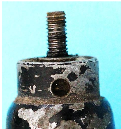
Bild 7.5: Lagerhals mit und ohne Reibrad
