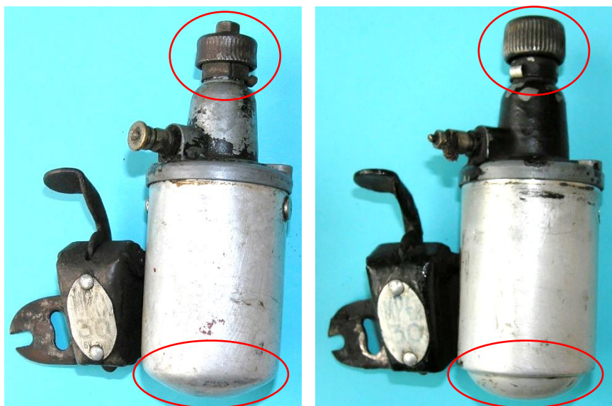
Bild 6.14: Unterschiede der Muster mit gleicher Typenbezeichnung: a) Impex 30, K 34320, b) Impex 30, E 66346
