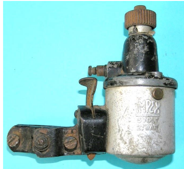
Bild 10.17: 2,1 W-Variante (Gewicht 390 g) mit reduzierten Abmessungen der Kippvorrichtung
