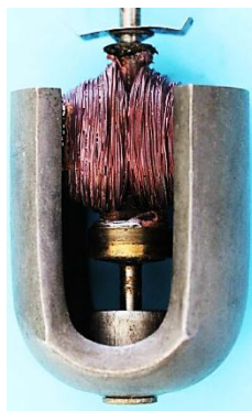
Bild 9.23: Spurlager: a) Welle im Lager, b) Position des Lagers im Magnetjoch, c) Öldepot
