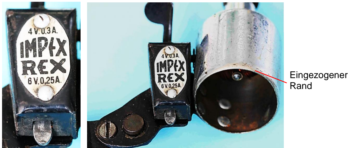
Bild 9.25: Leistungsschild mit den empfohlenen Lampenwiderständen von 13 Ohm und 24 Ohm
