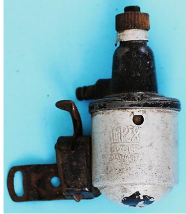
Bild 10.17: 2,1 W-Variante (Gewicht 390 g) mit reduzierten Abmessungen der Kippvorrichtung
