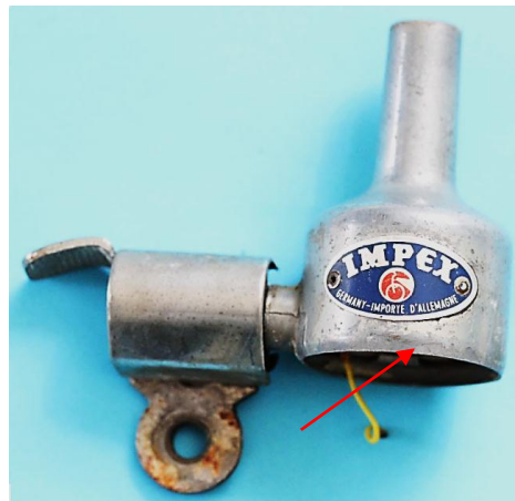
Bild 12.74: La- gerhalstopf mit eingezogenem unterem Rand
