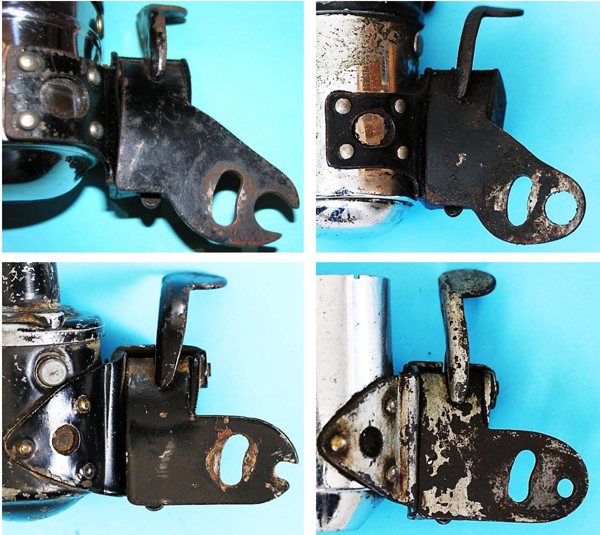
Bild 3.11: Halterarmvarianten der Impex-Dynamos
