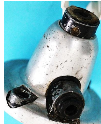
Bild 6.8: Gegossener Lagerhals mit Aluminiumkappe: a) Impex-Super, b) Impex Saba, c) Ansicht mit drei Durchbrüchen
