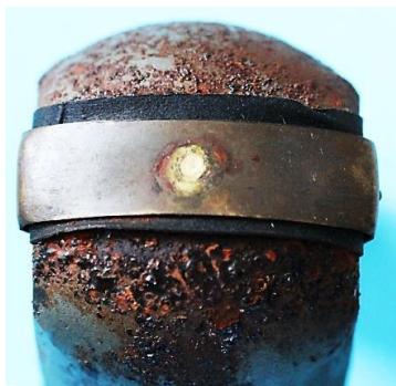
Bild 9.31: Kontaktblechbasis: a) Isolierte Lage auf dem Joch, b) Kontaktblech von unten, c) Oberfläche des Kontaktblechs (Pfeile zeigen auf die gleiche Kontaktblechkante)
