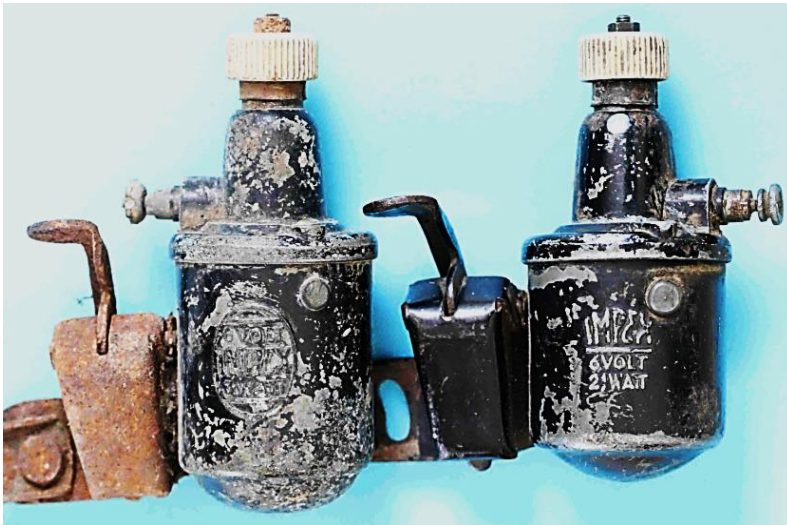
Bild 10.14: Verkleinerung der Gehäuselänge bei kleinerer Leistung: a) 3 W, b) 2,1 W
