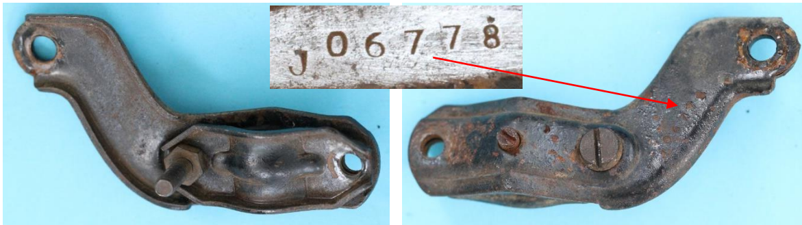
Bild 12.7: Halter mit abgewinkelten Rändern und der Fertigungsnummer 06778
