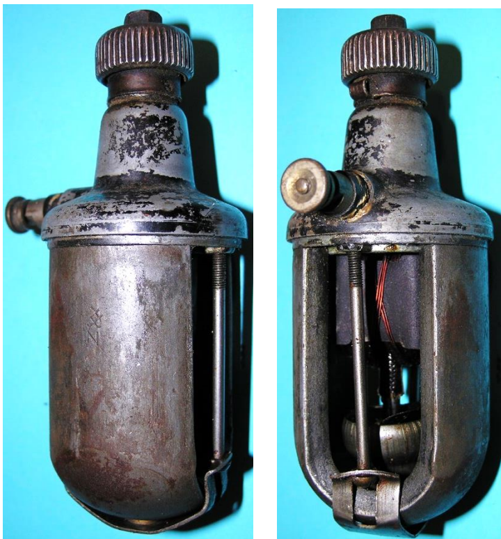
Bild 7.34: Zweipoliger Magnet mit Spannbolzen am Lagerhalsfuß angeschraubt
