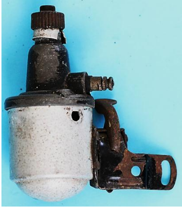
Bild 10.17: 2,1 W-Variante (Gewicht 390 g) mit reduzierten Abmessungen der Kippvorrichtung
