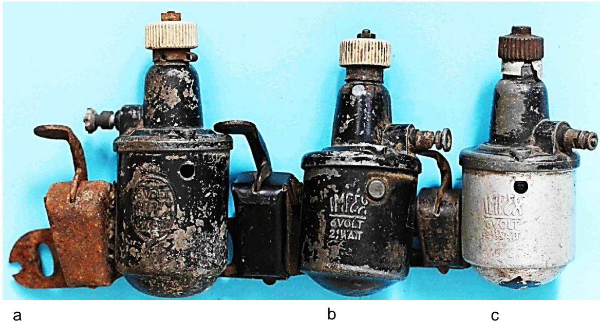
Bild 10.12: Vierpolige Impex-Varianten: a) 3 W, b) 2,1 W, c) 2,1 W mit kleinerer Kippvorrichtung
