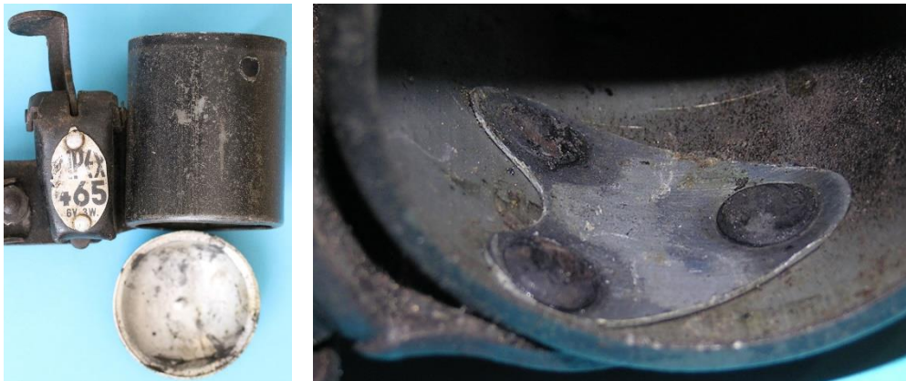
Bild 10.2: Gehäusemantel: a) Einlegbarer Boden, b) Drei Nieten und ein untergelegtes Blech zur Befestigung des Flansches
