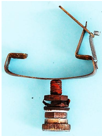
Bild 9.30: Federblechklammer: a) Kontakt mit dem Kabelanschlussbolzen, b) Dreiteiliger Aufbau
