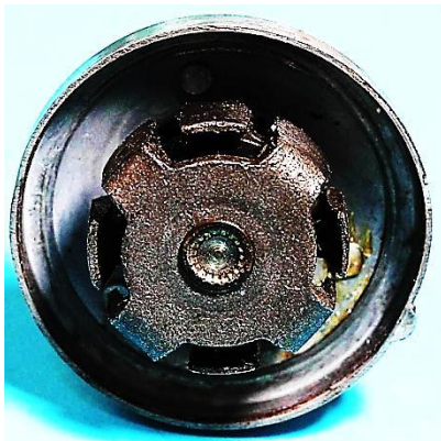
Bild 12.32: Baugruppen: a) Achtpoliges Klauenpolrad mit zweipoligem Magneten. b) Gehäusetopf mit der Kippvorrichtung
