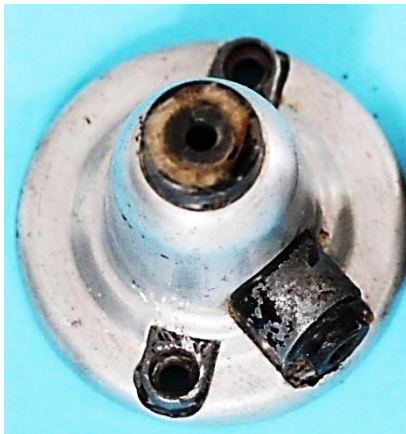
Bild 6.8: Gegossener Lagerhals mit Aluminiumkappe: a) Impex-Super, b) Impex Saba, c) Ansicht mit drei Durchbrüchen
