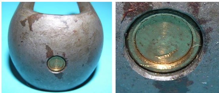
Bild 6.32: Befestigung des Axiallagers am durchbohrten Magnetjoch
