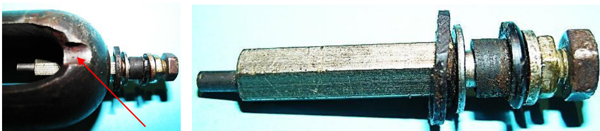
Bild 8.9: Kombination aus Kabelanschlussbolzens und Bürstenhalter
