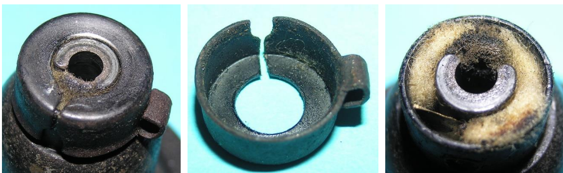
Bild 10.3: Befestigung des Specksteinreibrades zwischen zwei Kontermuttern: a) Montiertes Reibrad, b) Wellenende mit der unteren Kontermutter, c) Innenseite mit Sechskantprofil, d) Oberseite des Reibrades
