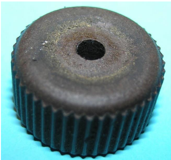
Bild 12.24: Reibrad aus Speckstein
