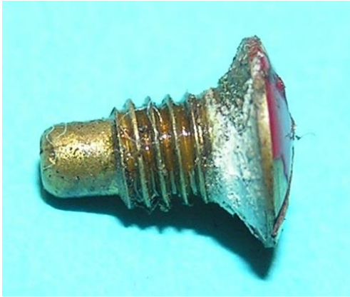
Bild 12.23: Spezialschraube zum Verschluss der Ölbohrung
