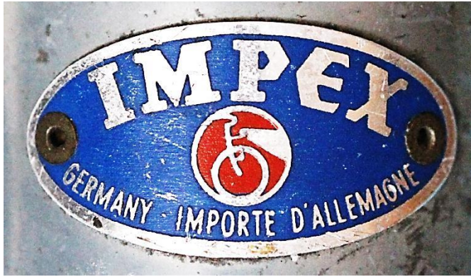
Bild 12.50: Mit Hohlknoten am Gehäusemantel angenietetes Firmenschild
