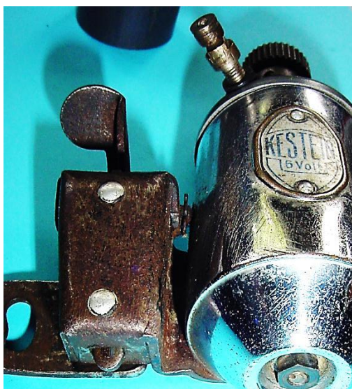
Bild 7.25: Sichtbares Stößelende unter der Kippvorrichtung
