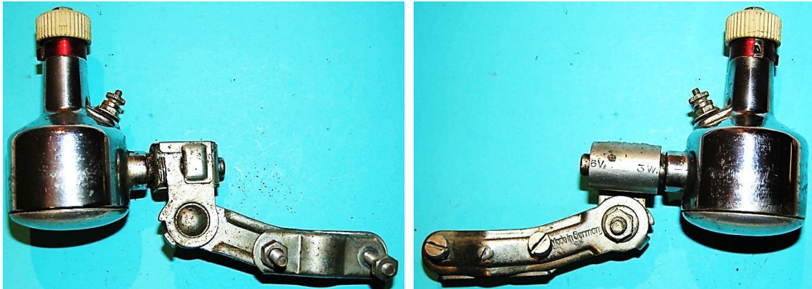
Bild 12.33: Impex Astoria mit dem Kabelanschluss am Lagerhalsfuß
