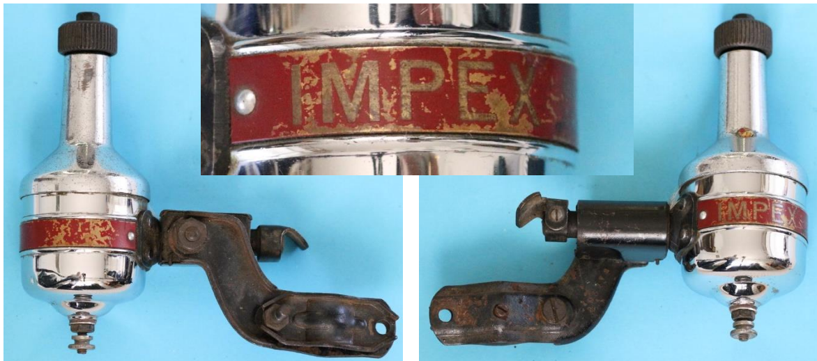
Bild 12.1: Impex mit zweipoligem AlNi-Polrad, Gewicht ohne Halter 440 g
