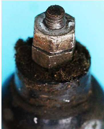
Bild 6.4: Reibrad mit Innensechskant zwischen zwei Muttern befestigt
