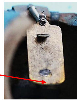
Bild 9.31: Kontaktblechbasis: a) Isolierte Lage auf dem Joch, b) Kontaktblech von unten, c) Oberfläche des Kontaktblechs (Pfeile zeigen auf die gleiche Kontaktblechkante)
