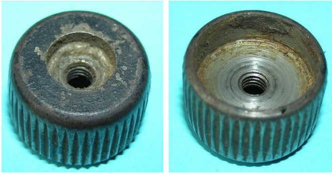
Bild 6.16: Zweitbestückung mit einem Reibrad mit zu großem Innengewindedurchmesser
