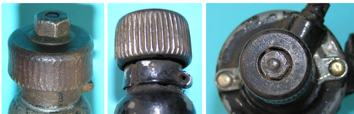
Bild 6.15: Reibräder der vorliegenden Muster: a) Impex 30, K 34320, b) und c) Impex 30, E 66346
