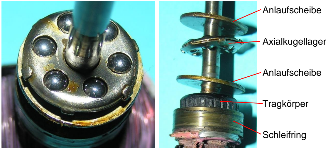
Bild 6.36: Axialkugellager mit sechs Kugeln und zwei Anlaufscheiben
