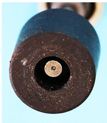
Bild 12.25: 8-polige Polräder: a) Klauenpolrad b) Walzenmagnet
