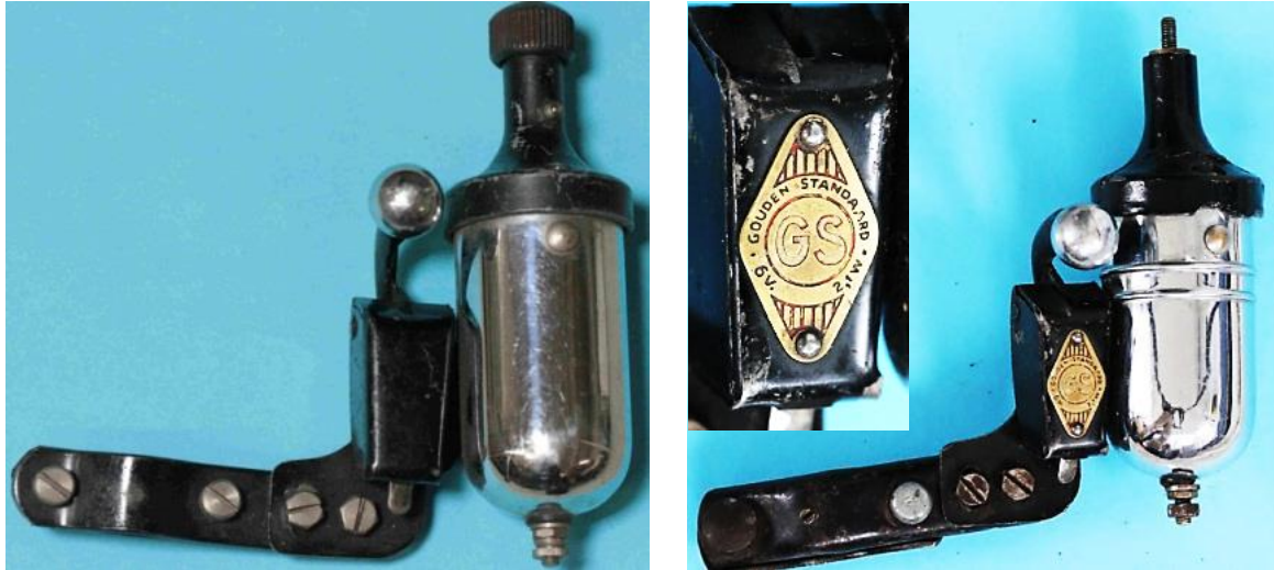
Bild 3.6: Gouden Standard, 6 V, 2,1 W: a) Unbeschriftetes Exemplar, b) Gouden Standard, niederländisches Produkt
