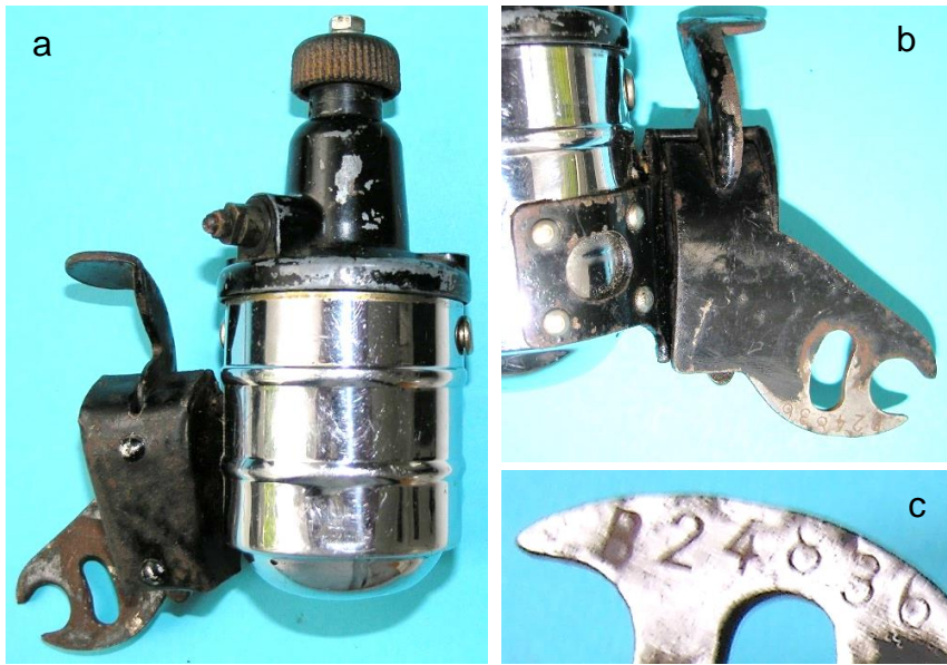
Bild 6.29: Eingestempelte Fertigungsnummer im Halterarm: a) Vorderseite des Dynamos, b) Rückseite der Kippvorrichtung, c) Fertigungsnummer
