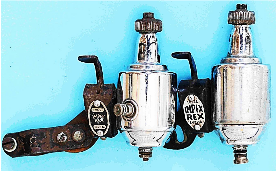
Bild 9.1: Zwei Ausführungen des Typs Impex-Rex: a) Kabelanschluss am Gehäusemantel, Nr. E 02440, b) Kabelanschluss am Boden, Nr. E 34627
