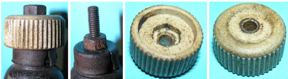
Bild 10.3: Befestigung des Specksteinreibrades zwischen zwei Kontermuttern: a) Montiertes Reibrad, b) Wellenende mit der unteren Kontermutter, c) Innenseite mit Sechskantprofil, d) Oberseite des Reibrades
