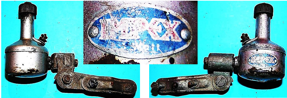
Bild 12.42: Kleinster Impex-Dynamo mit einem Klauenpolrad
