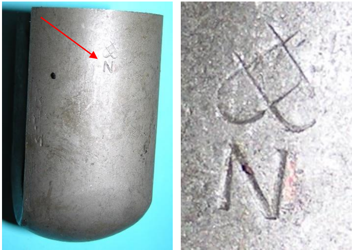
Bild 6.31: Logo der Magnetfabrik Bonn mit der Kennzeichnung der Polarität
