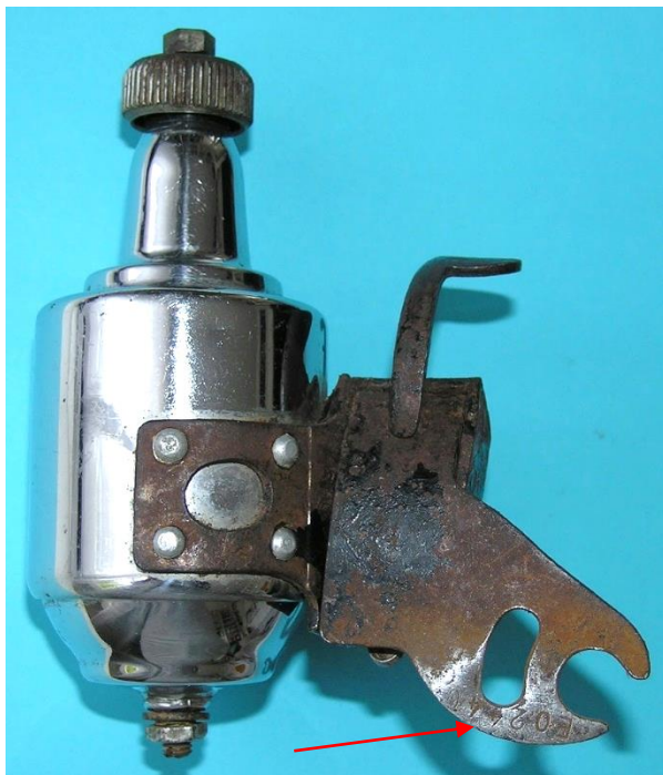
Bild 9.2: Fertigungsnummern und Lagerhalse: a) Nr. E 02440, b) Nr. E 34627
