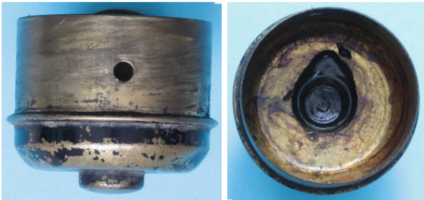
Bild 4.6: Bodentopf, a) Sichtbarer und ver- deckter Bereich, b) Kugellagersitz
