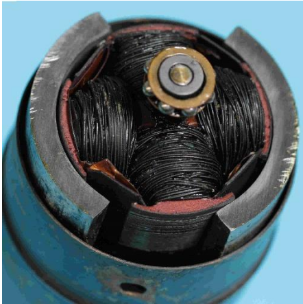
Bild 2.8: 4-nutiger Anker im zweipoligen Magnetfeld
