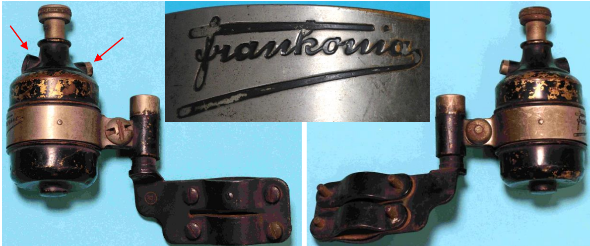
Bild 2.1: Gleichstromdynamo mit den Bürsten und Kabelanschlüssen im Lagerhals
