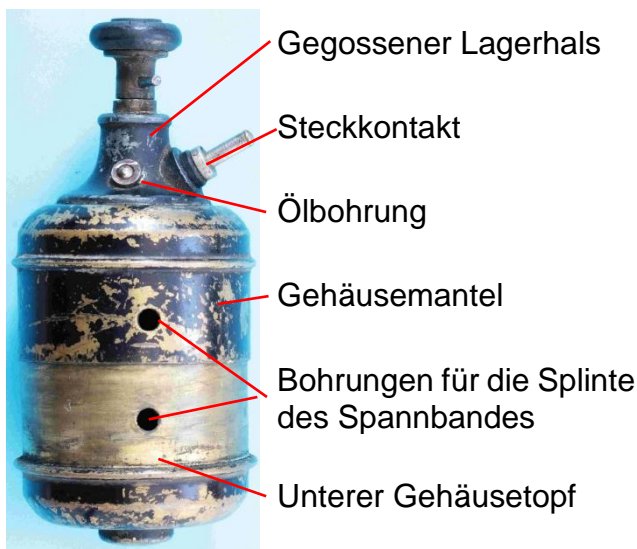
Bild 4.2: Aus dem Gehäusemantel herausgezogener Bodentopf
