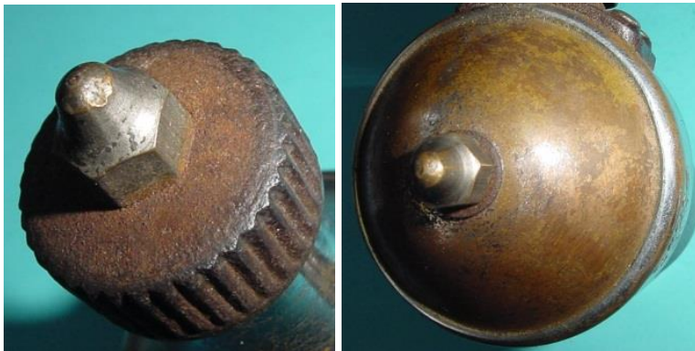
Bild 4.20: Hutmutter zur Befestigung des Reibrades und des Gehäusebodens
