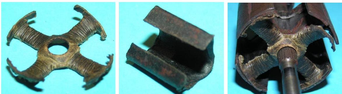
Bild 2.16. Ankereisenisolation: a) Stirninsolation, b) Nutisolation, c) Ankereisen mit Stirninsolation
