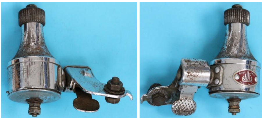
Bild 4.43: Klappenhebelkippvorrichtung von K 830 in der Betriebsstellung
