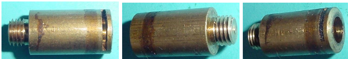
Bild 4.18: Spurlager mit Ölschlitz und Gewindezapfen zur Befestigung am Bodens
