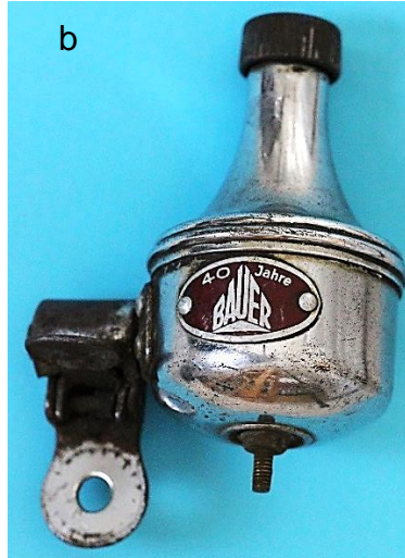
AINi 6 V, 3 W, 8 poliger AINi-Magnet Gewicht: 280 g, Durchm.: 51 mm, 1951 um 1951
