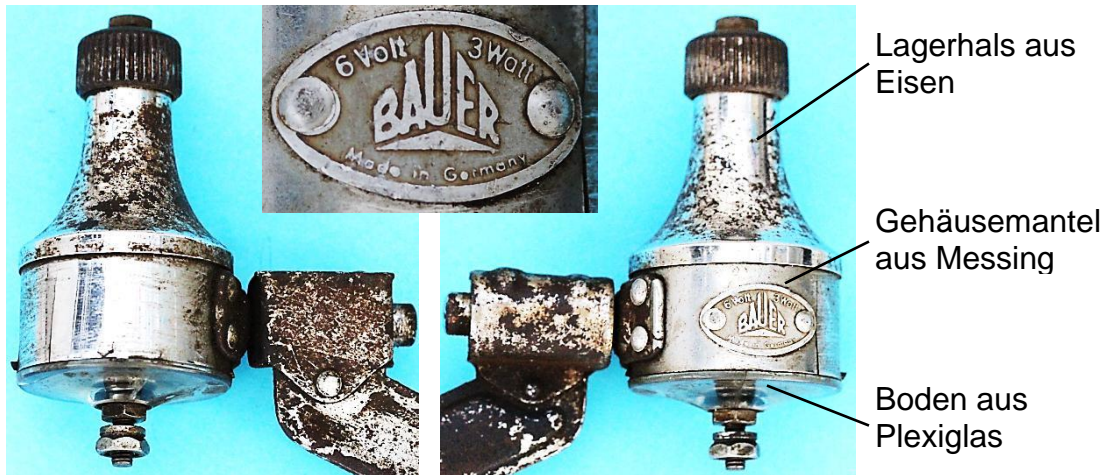
Bild 4.40: Dynamogehäuse bestehend aus drei verschiedenen Materialien
