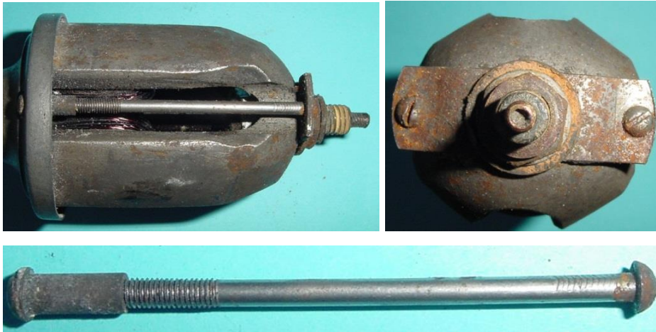
Bild 2.21: Spannbolzen und Spannstege zur Befestigung des Magneten am Lagerhals
