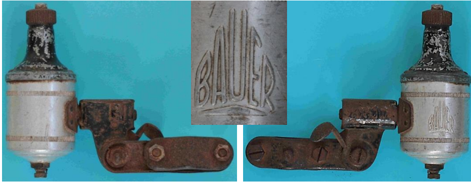
Bild 3.20: Bauer-Dynamo mit sechspoligem Stabmagnetsystem, 2,1 W
