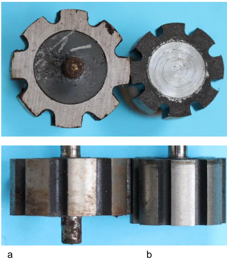
Bild 4.47: Reduzierung des Polradvolumens um 27 % a) D=30\text{ mm} , l=14\text{ mm} b) D=24\text{ mm} , l=16\text{ mm}
