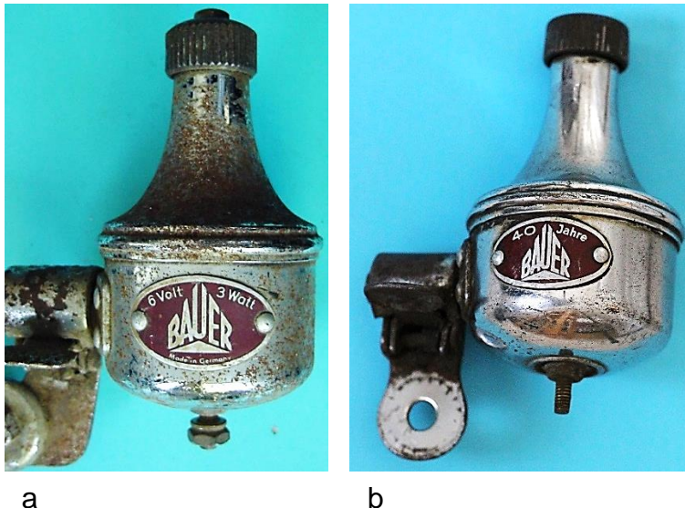
Bild 4.23: Dynamo mit Klauenpolanker und AlNi-Magnetwalze (Bild 4.1b und c)
