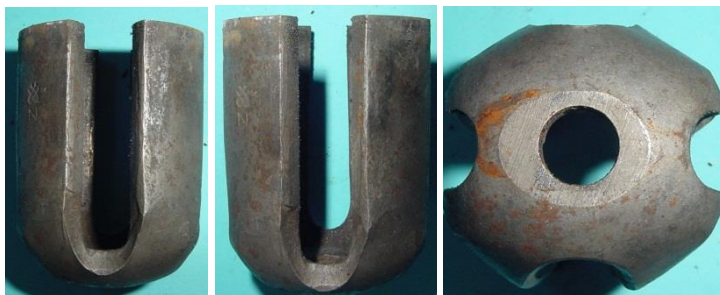
Bild 2.20: Vierpoliger Stahlmagnet mit unterschiedlich breiten Pollücken
