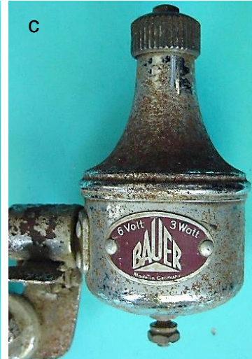
AINi 6 V, 3 W, 8 poliger AINi-Magnet Gewicht: 280 g, Durchm.: 51 mm, 1951 um 1951
