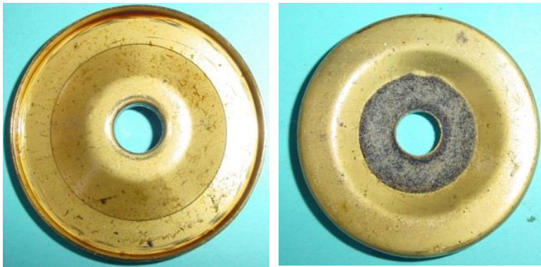
Bild 4.19: Lagerschild: a) Untere Ansicht, b) Lagerschild mit Öldepot
