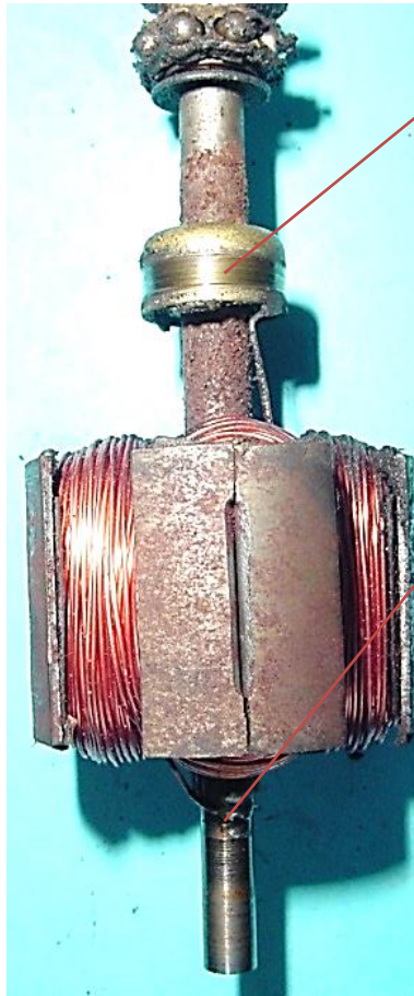
Bild 2.18: Masseanschluss an der Welle und Spannung führender Anschluss am Schleifring
