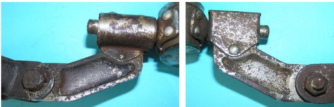
Bild 4.3: Kippvorrichtung des Dynamos im Bild 4.1e mit langem Halterarm und angenietetem Abdeckblech
