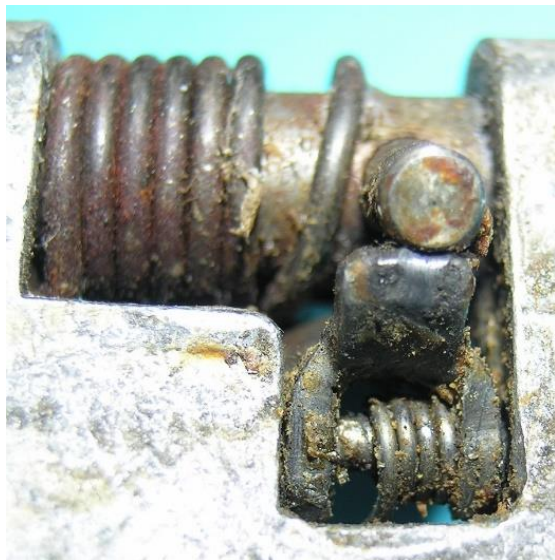
Bild 4.13: Sperrstift und Hebelzunge: a) Arretierung des Sperrstifts in der Ruhelage, b) Hebelzunge hinter dem Sperrstift in der Betriebsstellung
