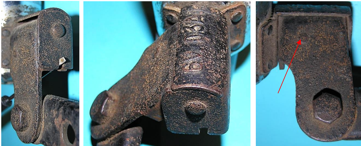
Bild 3.4: Kippvorrichtung mit vom Basisblech getrennten Halterarm
