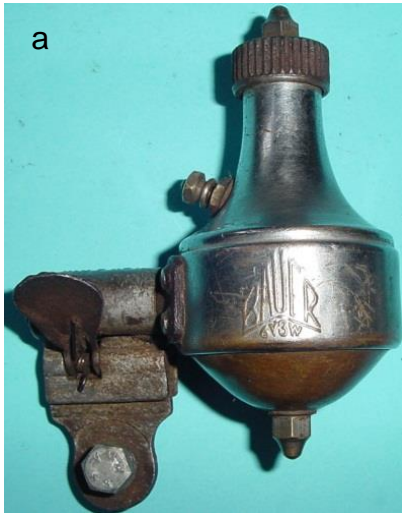
AINi 6 V, 3 W 2 poliger AINi-Magnet Gewicht: 335 g Durchm.: 47 mm
