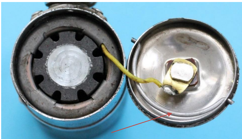
Bild 4.45: Im Boden eingeklinkte Feder: a) Herausführung des Spulenendes, b) Drahtfeder im Boden eingesetzt
