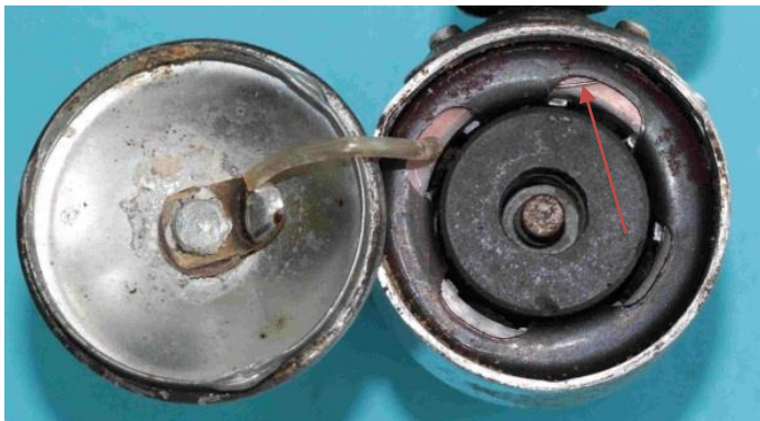
Bild 4.56: Masseanschluss zwischen dem Klauenpolring und dem Spulenkörper
