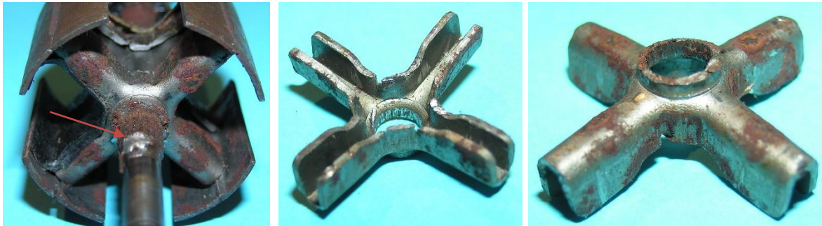
Bild 2.15: 1 mm dicke Ankerblechklammern: a) Geklammerte Stirnseite mit Masselötstelle, b) Nuten für die Polschäfte, c) Wellenbohrung der Ankerblechklammer
