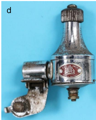
Typ K 830, Gewicht 240 g Durchm.: 39 mm 8-poliger AINi Magnet 1956 bis 1958
