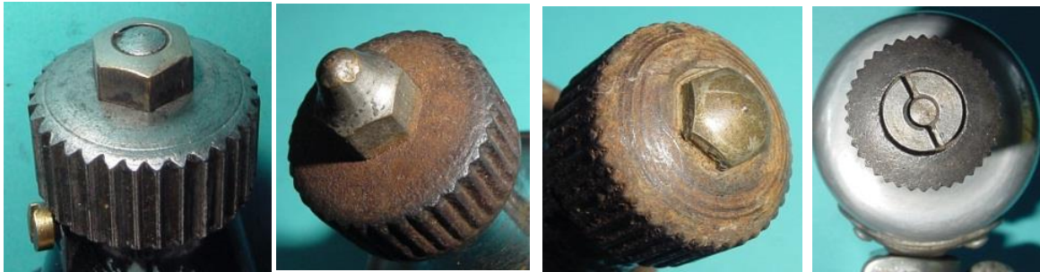
Bild 1.8: Gestaltung und Befestigung der Reibräder
