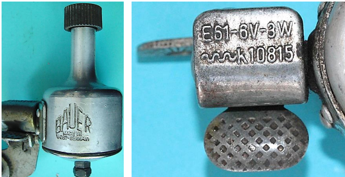
Bild 4.48: Dynamo Typ E 61 mit keramischem Magneten, K-10815
