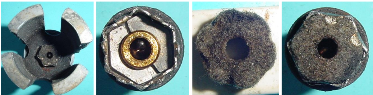
Bild 2.22: Isoliert eingesetztes Spurlager mit Öldepot
