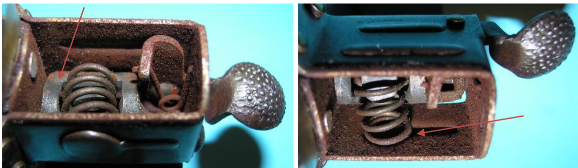
Bild 2.34: Druckfeder in der Betriebsstellung: a) Abstützung am Halterarm, b) Abstützung am Basisblech
