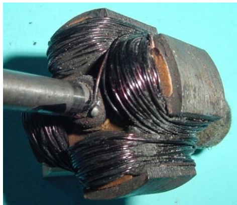
Bild 2.25: Massekontakt: a) Bürstenhalter im Lagerhals, b) Lötstelle auf der Welle, c) Kupferbürste
