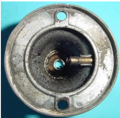
Bild 2.25: Massekontakt: a) Bürstenhalter im Lagerhals, b) Lötstelle auf der Welle, c) Kupferbürste
