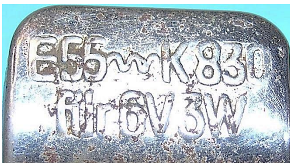
Bild 4.39: Typenbezeichnungen auf dem Abdeckblech: Typ E55, Registriernummer K-830, 6 V, 3 W
