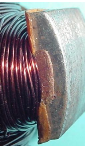
Bild 2.46: Isolierung des Blechpakets V3
