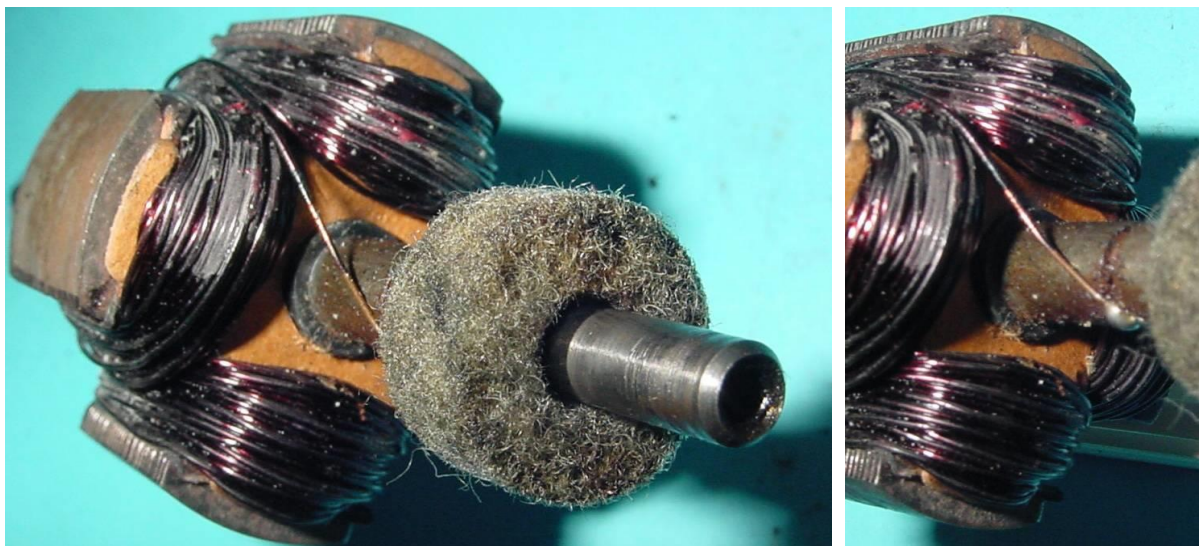
Bild 2.23: Isoliert angesetztes Wellenende als Spannung führendes Leiterelement im Stromkreis: a) Öldepot und Drahtführung, b) Lötstelle am aufgesetzten Wellenende
