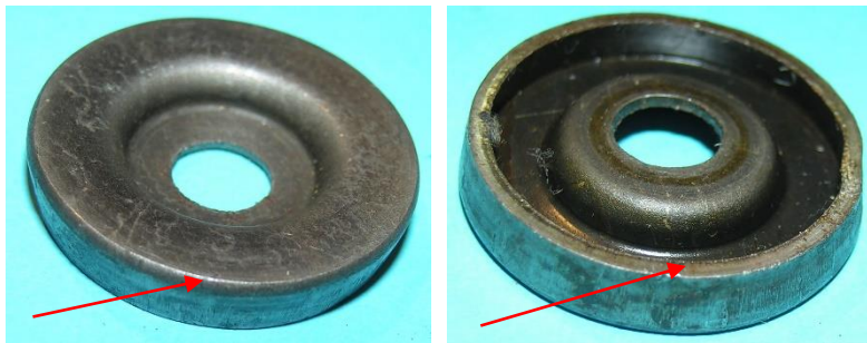
Bild 3.8: Jochtopf: a) Innere Ansicht, b) Bodenansicht, c) Position des Jochtellers im Jochtopf
