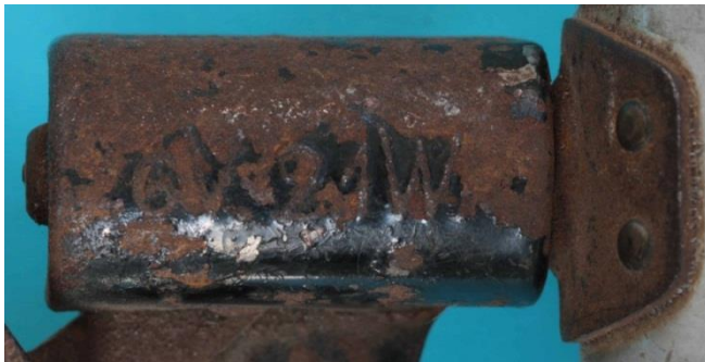
Bild 3.21: Einprägung der Nenndaten auf der Kippvorrichtung (6 V, 2,1 W)
