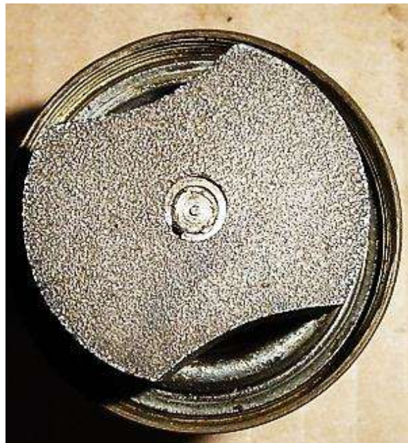
Bild 1.7: Walzenpolrad mit ausgeschliffenen Pollücken im Balaco-Blätterpoldynamo
