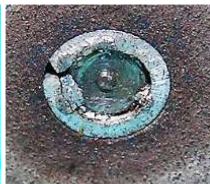
Bild 1.32: Polradvariante: a) Anlaufscheibe, b) Magnetunterseite, c) Welle mit einer geschlitzten Hülse in der Magnetbohrung eingepresst
