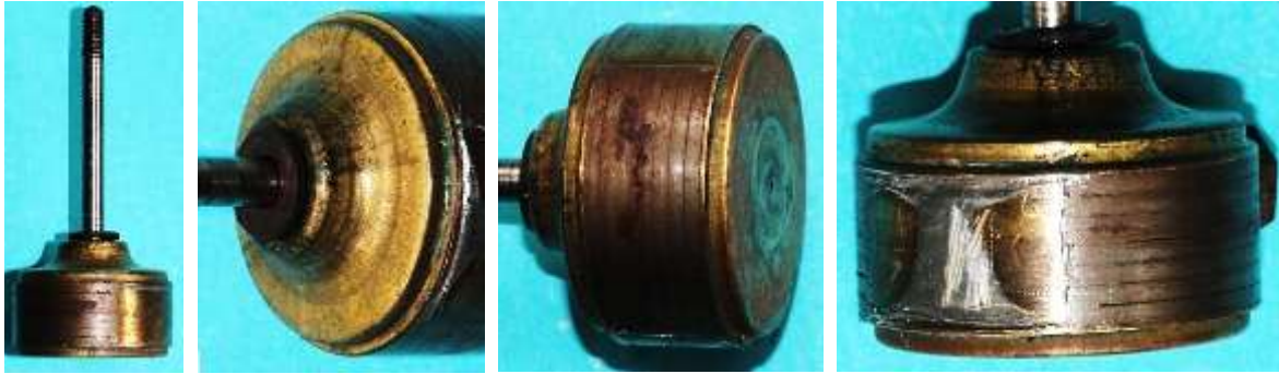
Bild 1.17: 7 Polschuhbleche 1,6 mm dick, Polraddurchmesser 31,3 mm
