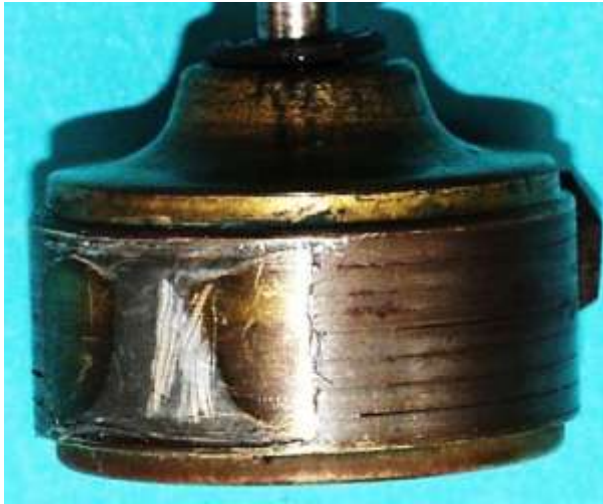
Bild 1.6: Polradgestaltung des Typs „Simplex“: a) Zylindrische Oberfläche, b) Magnetquader mit geblechten Polschuhen
