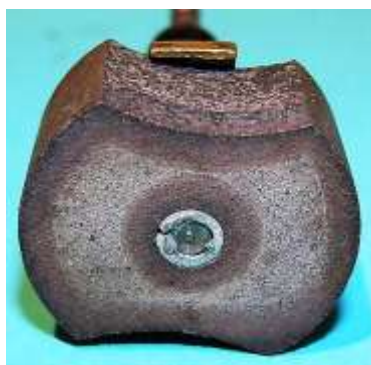
Bild 1.32: Polradvariante: a) Anlaufscheibe, b) Magnetunterseite, c) Welle mit einer geschlitzten Hülse in der Magnetbohrung eingepresst
