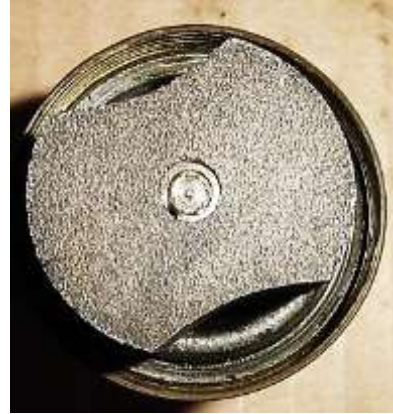
Bild 1.30: Lagerhals mit Polrad: a) Seitenansicht, b) Zweipoliger Walzenmagnet mit zurückgesetzten Pollücken
