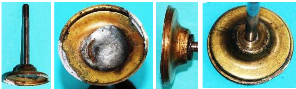
Bild 1.18: Welle mit oberer Scheibe verlötet
