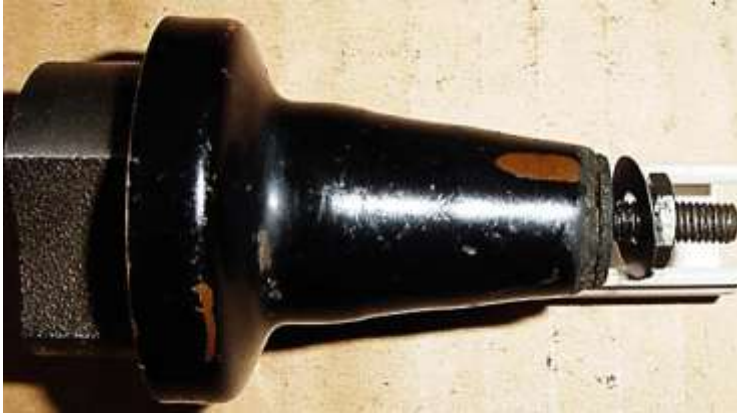
Bild 1.30: Lagerhals mit Polrad: a) Seitenansicht, b) Zweipoliger Walzenmagnet mit zurückgesetzten Pollücken
