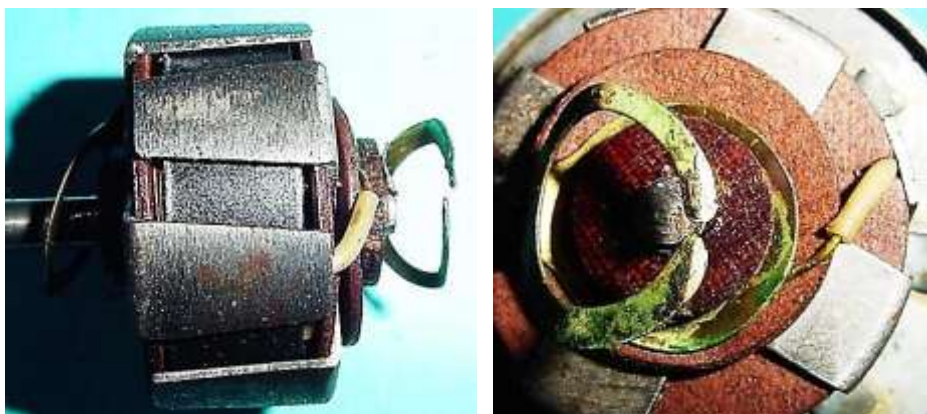
Bild 2.18: Balaco-Block-3 W: Anker und Blattfederbürsten
