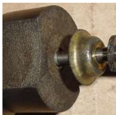
Bild 1.31: Welle: a) Welle mit Anlaufscheibe, b) Geschlitztes Rohr zwischen Welle und Magnet, c) Lagerteller mit gerolltem Messingrohr
