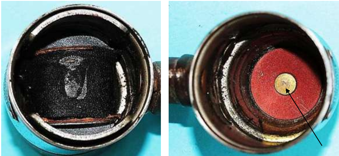
Bild 1.13: Gehäusetopf: a) Eingebauter Anker, b) Isoliert eingesetzter Kabelanschlussbolzen
