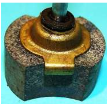
Bild 1.32: Polradvariante: a) Anlaufscheibe, b) Magnetunterseite, c) Welle mit einer geschlitzten Hülse in der Magnetbohrung eingepresst
