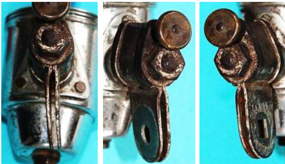
Bild 1.12: Halterarm: a) Halterarmgabel, b) Seite der Mutter, c) Quadratische Ausnehmung für die Verdrehsicherung des Bolzens
