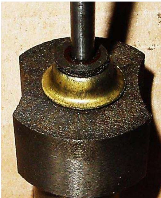
Bild 1.7: Walzenpolrad mit ausgeschliffenen Pollücken im Balaco-Blätterpoldynamo
