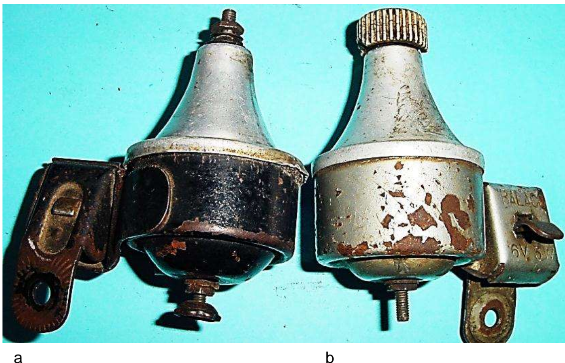
Bild 2.1: Zwei Blockkeramikmagnet-Dynamos mit unterschiedlich langem Gehäusenumantel: a) 2,1 W, b) 3 W
