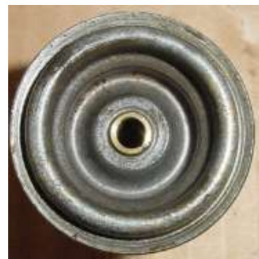
Bild 1.31: Welle: a) Welle mit Anlaufscheibe, b) Geschlitztes Rohr zwischen Welle und Magnet, c) Lagerteller mit gerolltem Messingrohr
