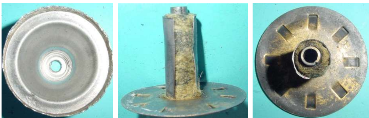
Bild 2.10: a) Lagerhals, b) und c) Lagerhülse und Lagerschild
