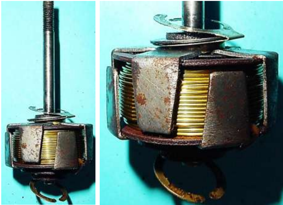
Bild 2.8: Klauenpolanker mit den Federbürsten
