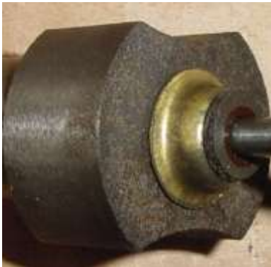
Bild 1.31: Welle: a) Welle mit Anlaufscheibe, b) Geschlitztes Rohr zwischen Welle und Magnet, c) Lagerteller mit gerolltem Messingrohr
