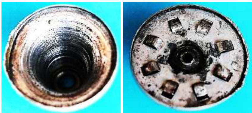
Bild 2.14: Lagerhals: a) Innenraum, b) Lagerschild im Lagerhalsfuß
