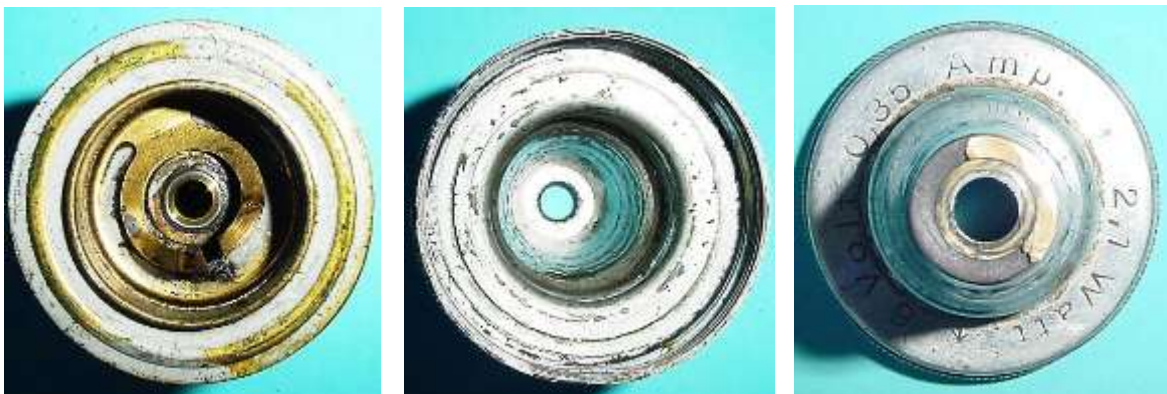
Bild 1.29: Lagerhals: a) Lagerhals mit eingesetztem Lager und angenieteteter Massefeder, b) Innenraum des Lagerhalses, c) Lagerhals mit Schriftzug
