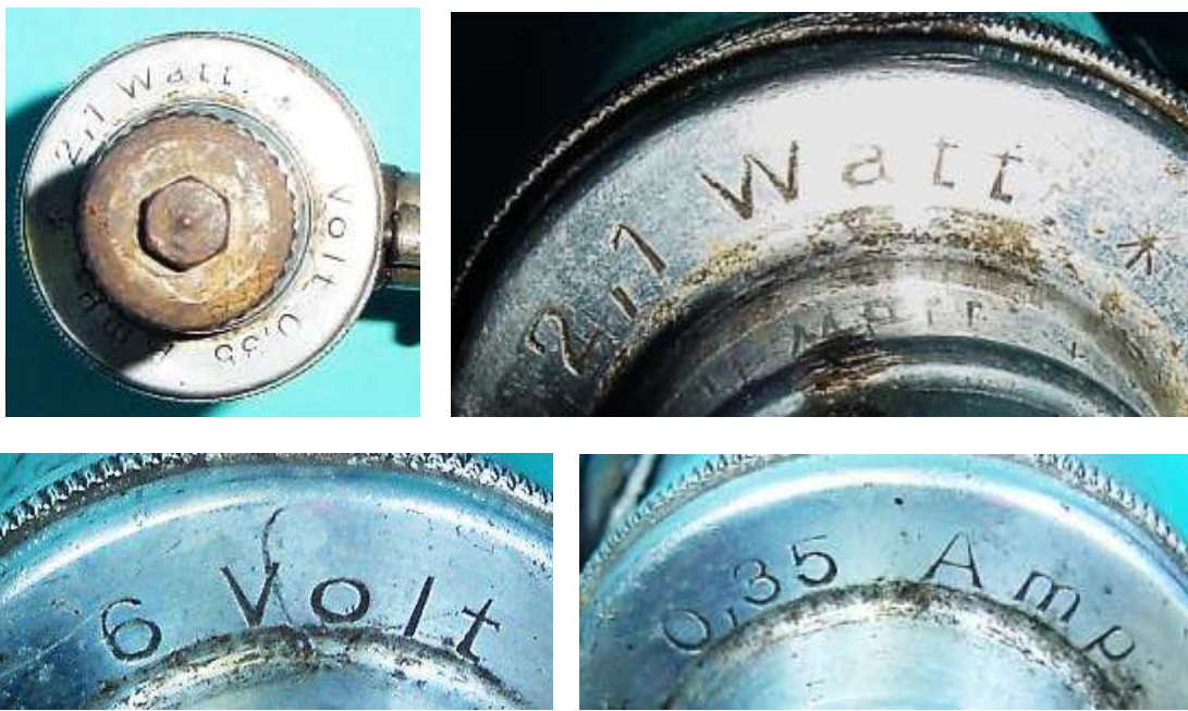
Bild 1.21: Nenndaten auf dem Lagerhalsfuß
