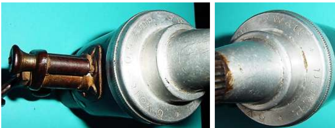
Bild 2.21: Beschriftung des Lagerhalsfußes mit den Nenndaten: 6 V; 0,3 A; 3 W
