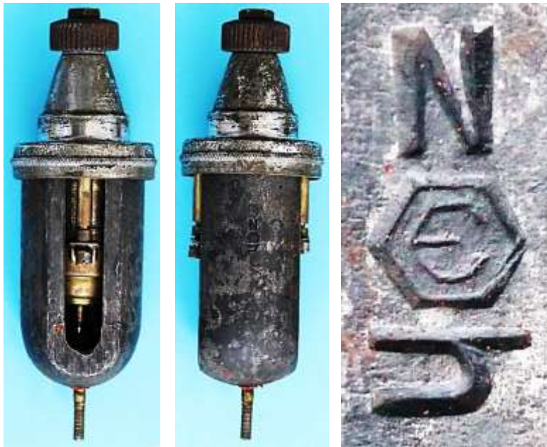
Bild 1.9: Zweipoliger Tulpenmagnet: a) Pollücke b) Polschenkel c) Logo des Magnetherstellers
