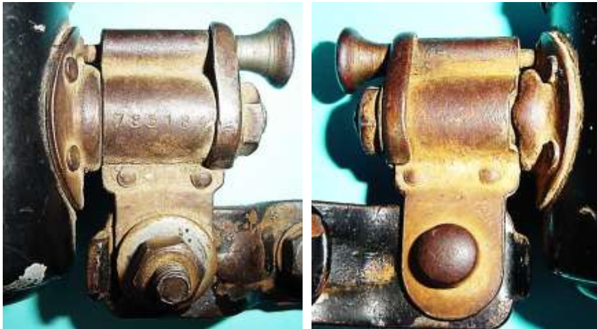
Bild 2.22: Kippvorrichtung mit der eingepprägten Nummer 785184
