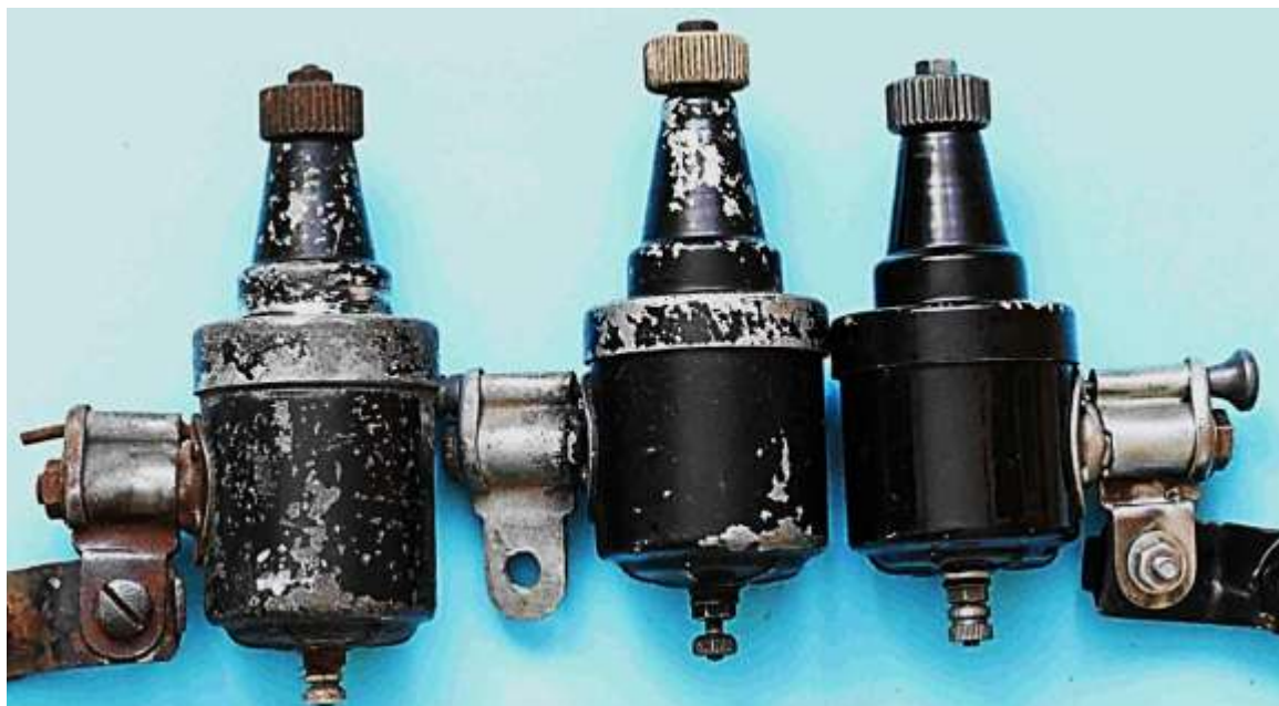
Bild 2.42: Gleiche Dynamokonstruktionen, die sich hauptsächlich durch die Magnetlänge unterscheiden: a) 3 W, Gewicht: 560 g, b) 2,1W, Gewicht: 480 g c) 2,1 W Gewicht: 442 g
