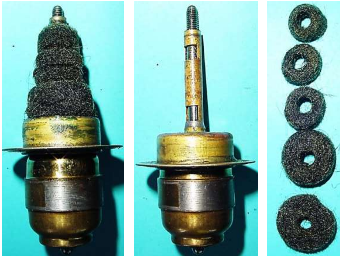
Bild 1.28: Öldepot und Gleitlager: a) Baugruppe aus Anker, Lagerschale, Lager und Öldepot, b) Anker im Gleitlager, c) Filzscheiben des Öldepots
