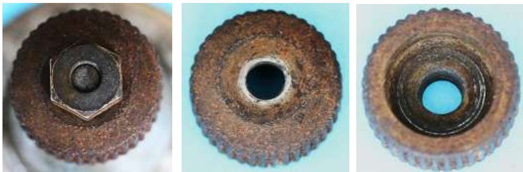
Bild 1.10: Reibrad: a) Kontermutter aus Messing, b) Kleinste Öffnung der konischen Bohrung, c) Innenraum mit konischer Bohrung
