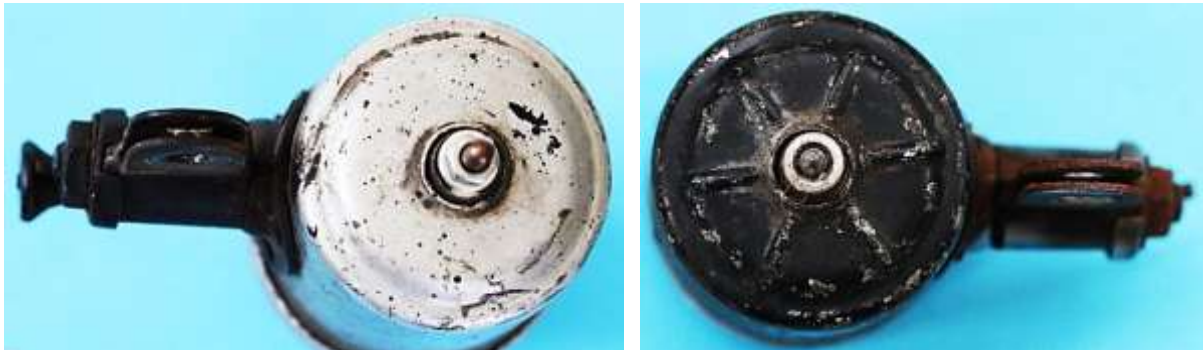
Bild 2.41: Bodengestaltung: a) Fertigungsnummer 967666 mit glattem Boden b) Schwarzer Dynamo mit radialen Rippen
