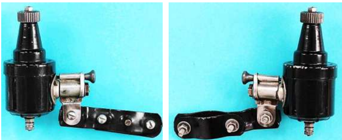
Bild 2.48: BALACO, 2,1 W der „Schwarzen Serie“ (kleinste Abmessungen)
