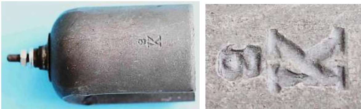
Bild 2.33: Kennzeichen des Magnetherstellers (Gewicht: 233 g, axiale Länge: 62 mm)
