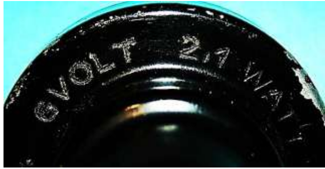
Bild 2.49: Beschriftung des Lagerhalses der 2,1 W Varianten mit dem Firmennamen und den Nenndaten
