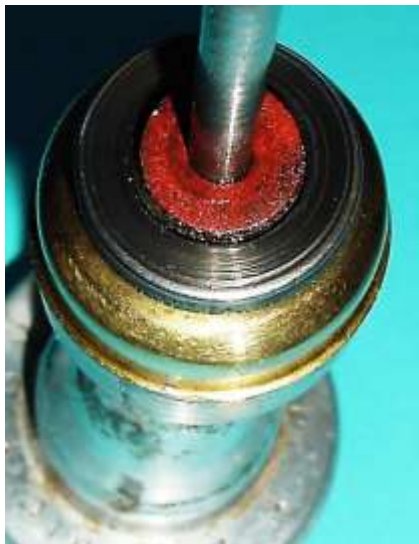
Bild 1.30: Schleifring: a) Schleifring mit Anlaufscheibe, b) Schleifringkappe auf der oberen Verschlusskappe
