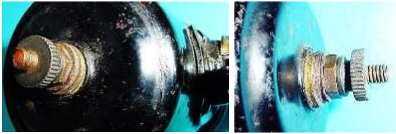
Bild 2.16: Spannung führender Kontakt im Gehäuseboden
