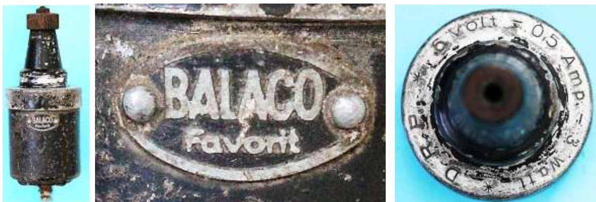
Bild 2.47: Balaco-Favorit, 3 W: a) Vorderansicht , Firmen- und Typenschild, c) Beschrifteter Lagerhalsfuß (schwarze Farbe entfernt)
