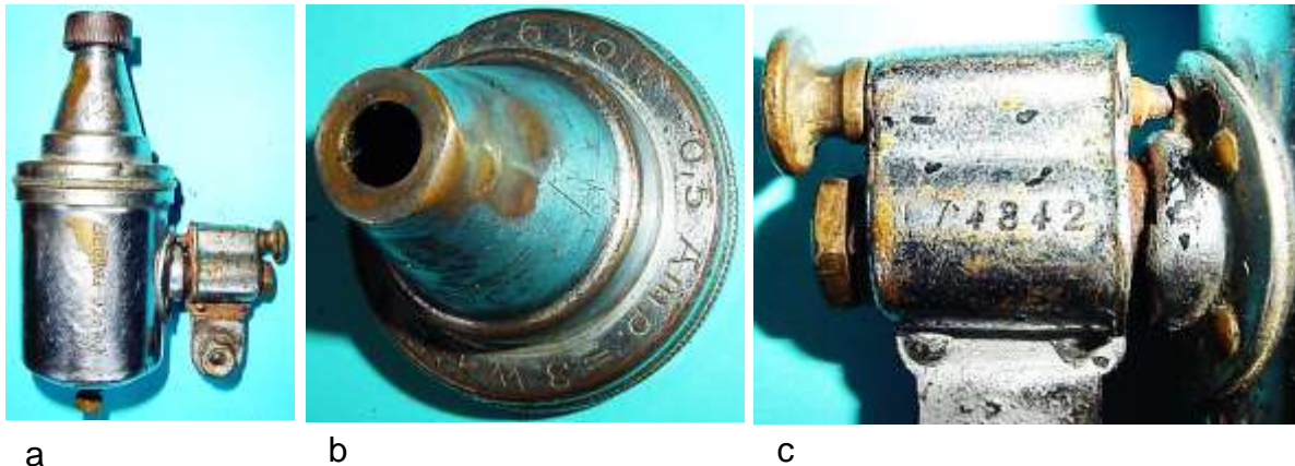
Bild 2.1: BALACO-FAVORIT mit der Fertigungsnummer 174842: a) vollständige Ansicht, b) Lagerhals mit der Beschriftung auf dem Lagerhalsfuß, c) Fertigungsnummer auf der Schutzkappe der Kippvorrichtung
