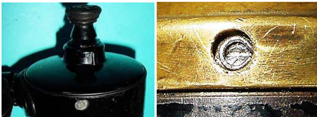
Bild 5.2: Geöffnete und versiegelte Einziehbohrung des Befestigungsdrahtes a) Berko-Schuhcremedosen-Dynamo, b) Berko-Säulenmagnet-Dynamo
