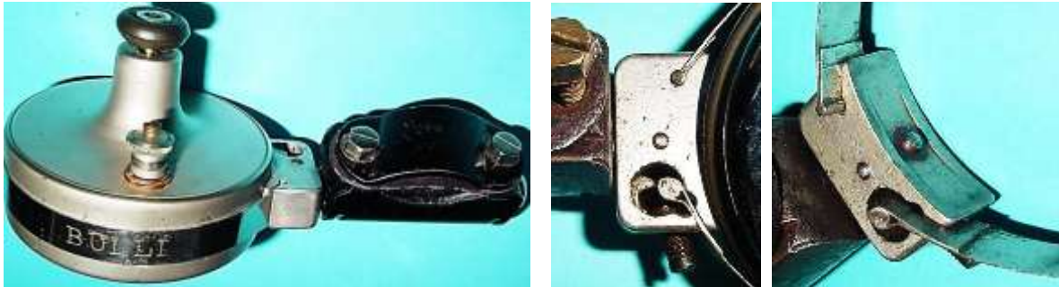
Bild 3.1: Spannbandbefestigung des Bulli-Dynamos
