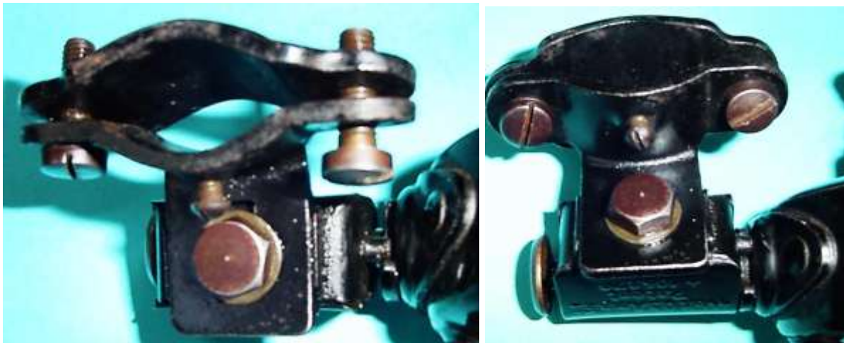
Bild 3.2: Kippvorrichtung der Berko-Schuhcremedosen-Dynamos ohne Nietköpfe am Gehäusemantel
