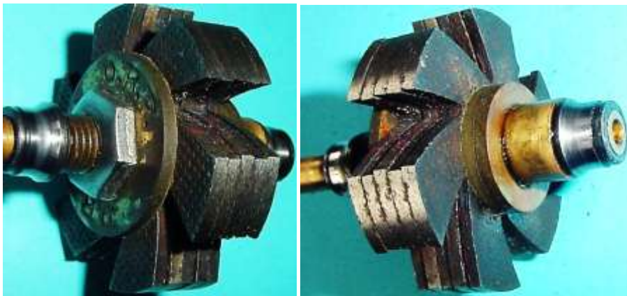
Bild 4.11: Befestigung der Stahlmagnetscheiben auf der Welle
