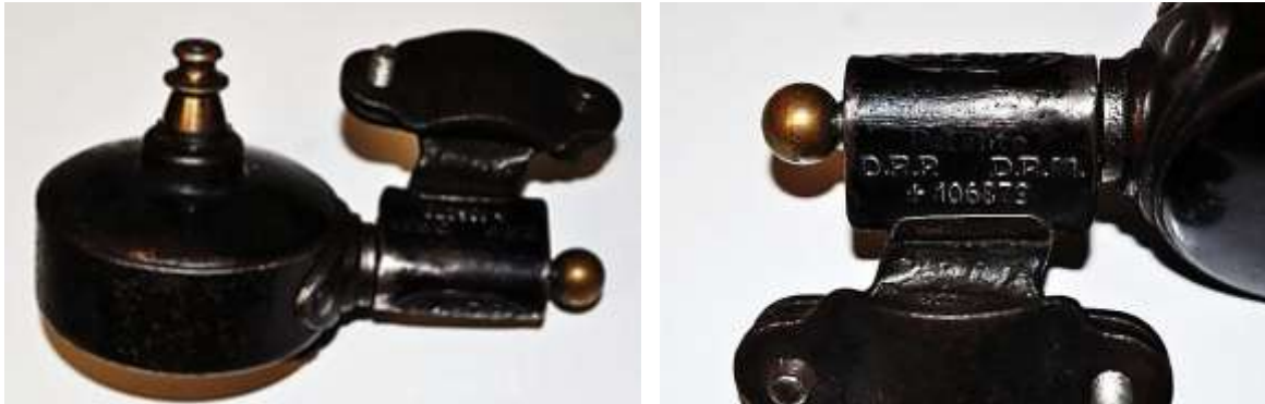
Bild 3.3: Kugel statt flache Bedienungsfläche, eine Modifikation des Bedienungsknopfes
