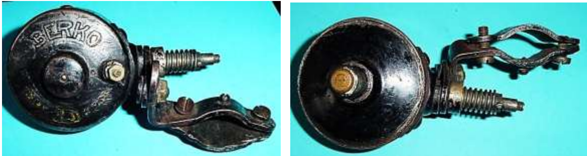
Bild 4.1: Laufradseite und Boden des Dynamos Berko D mit Nietköpfen
