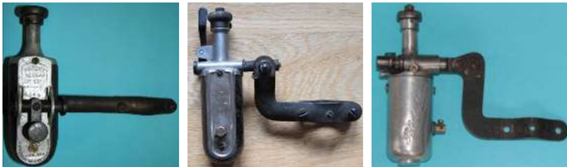
Bild 1.2: Entwicklungsstufen der Lucifer-Dynamos: a) Lucifer 6059, b) 618 738 VT Lucifer, c) Polestar Luxe 12348
