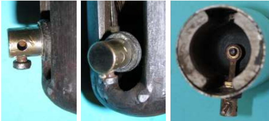
Bild 4.6: Kabelanschluss in der Pollücke
