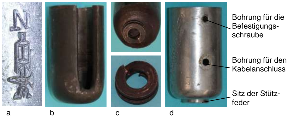
Bild 2.6: Magnet und Gehäusetopf: a) Firmenlogo des Magnetherstellers, b) Zweipoliger Topfmagnet, c) Stützfeder zwischen Gehäusetopf und Magnetjoch, d) Gehäusetopf
