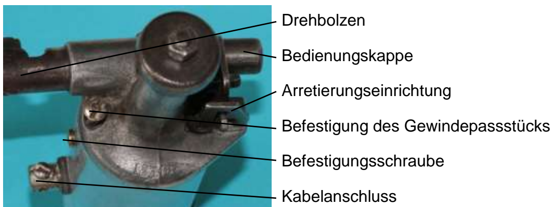
Bild 3.1: Funktionselemente am Lagerhals und Gehäusetopf
