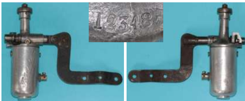
Bild 2.1: Dynamo mit stark gekröpftem Halter
