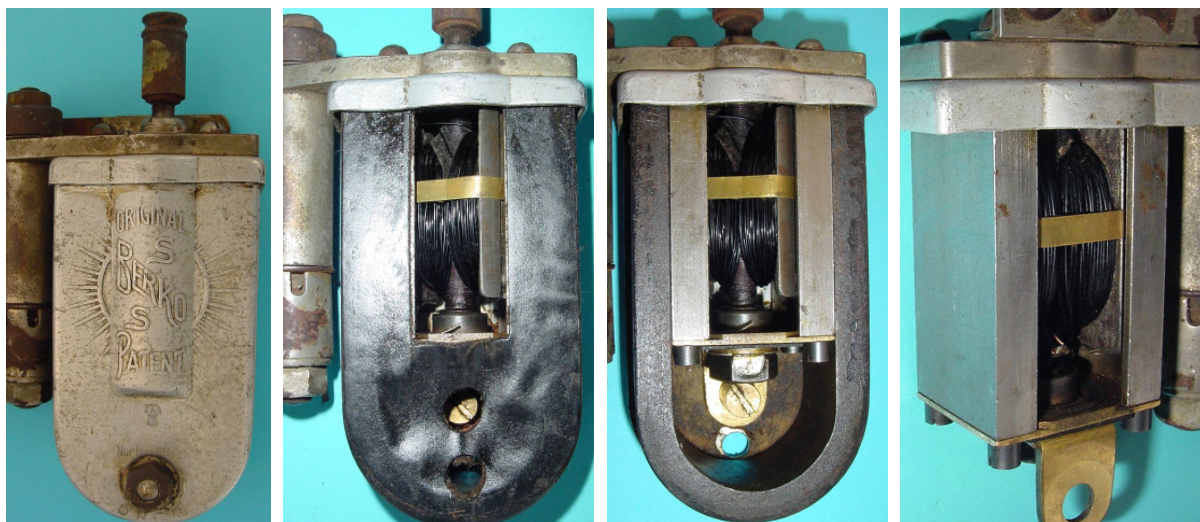
Bild 1.6: Berko 7: Pol-lückenabdeckung, b) Abgenommene Abdeckung, c) Polsystem und Anker, d) Anker mit den Polschuhen des Ständers
