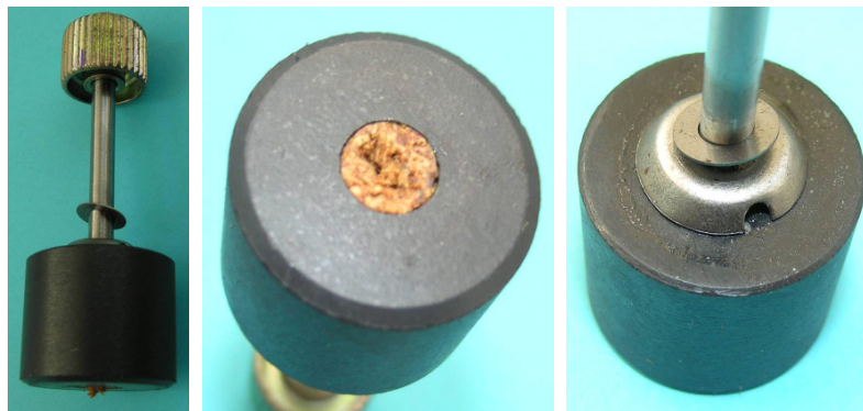
Bild 1.17: Polrad: a) Polrad mit Welle und Reibrad, b) Untere Stirnseite, c) Obere Stirnseite mit Anlaufscheibe
