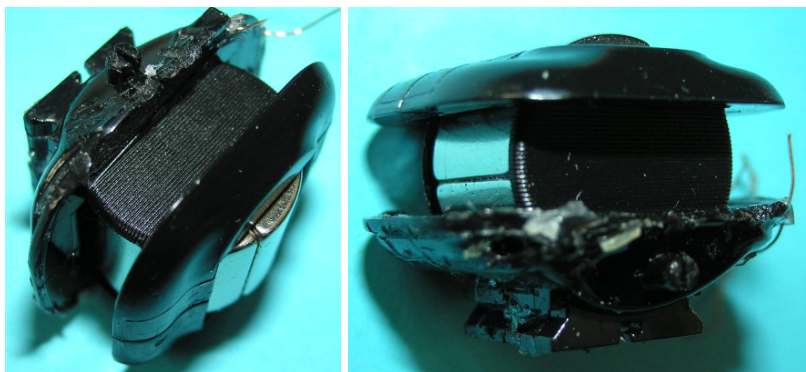
Bild 1.11: Der gekrümm- ten Polradkontur ange- passte Wickelfensterge- staltung
