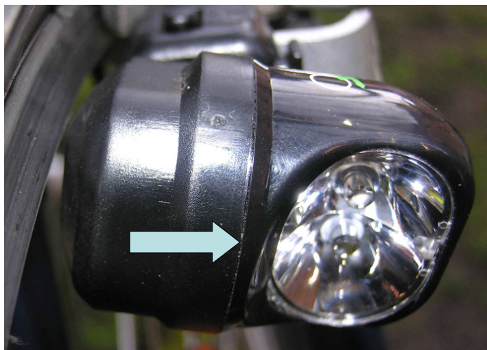
Bild 1.3: Fügspalt zwischen den Generator- und Lampenteilen
