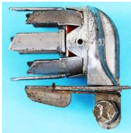
Bild 2.9: Generatorbaugruppen: a) Polrad im Lagerhalstopf, b) Anker mit Boden
