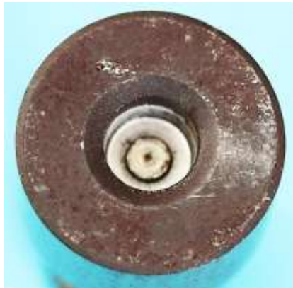
Bild 2.15: Im Magneten eingepresste Welle
