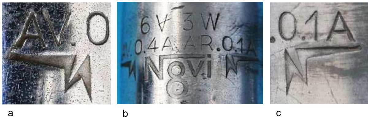
Bild 2.2: Beschriftung des Gehäusemantels: a) Spiegelbild des nachgestellten N, b) Typenbezeichnung und Nenndaten
