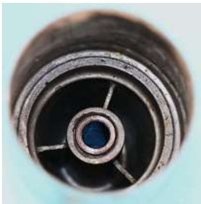
Bild 2.16: Lagerung: a) Lagerhals mit Gleitlagerhülse, b) Lagersitz, c) Lagerhülse
