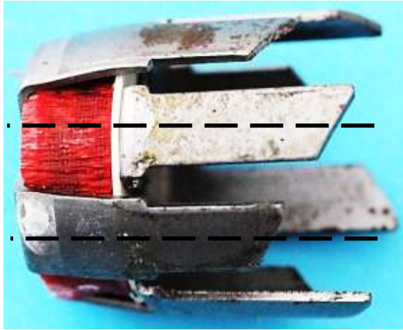
Bild 2.12: Schnitt durch zwei nebeneinander liegende Polschuhe
