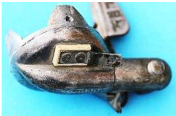
Bild 2.13: Spannung führender Kontakt im Boden: a) Flachstecker für den Kabelanschluss, b) Isolierstück an der Innenseite des Bodens
