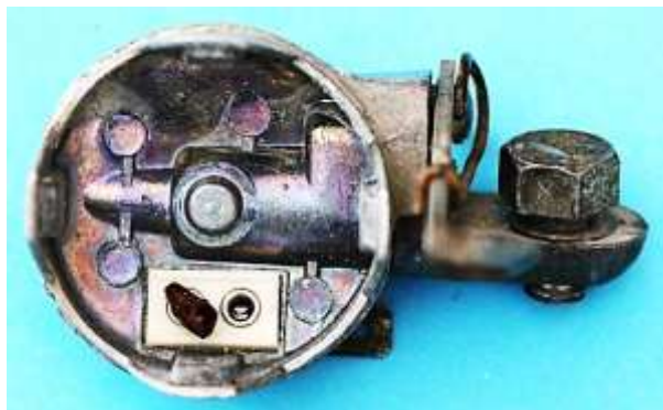
Bild 2.13: Spannung führender Kontakt im Boden: a) Flachstecker für den Kabelanschluss, b) Isolierstück an der Innenseite des Bodens
