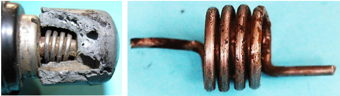
Bild 5.30: Druckfeder: a) Abstützungen der Druckfeder am Gehäuse und an der Aluminiumkappe, b) Ab Kröpfungen der Federenden für die Abstützung
