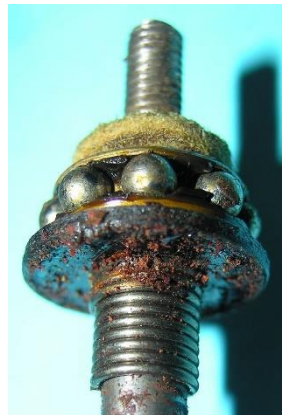
Bild 6.25: Obere Lagerung: a) Lagerhals mit Zentrierring b) Verschiebbares Kugellager mit Axialspielausgleichsfeder
