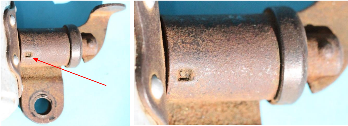
Bild 8.9: Im Abdeckblech eingebrachte Delle
