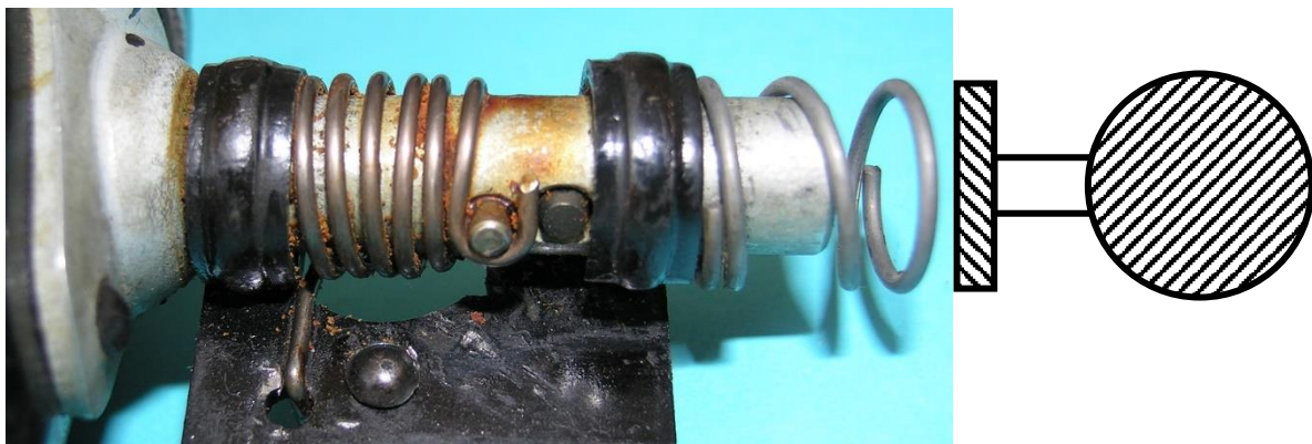
Bild 2.27: Aufbau der Kippvorrichtung mit axial bewegbaren Stößel
