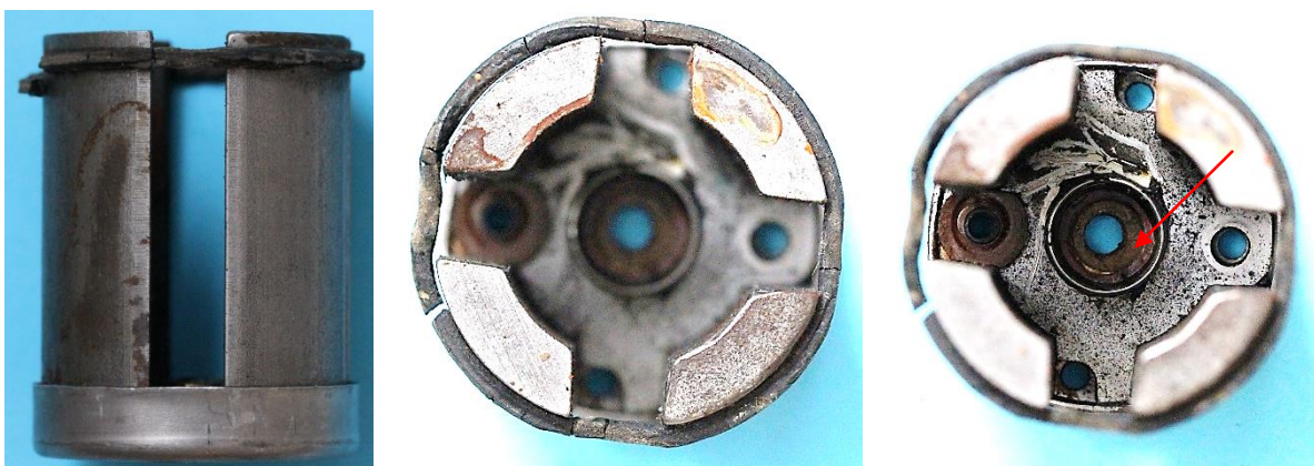
Bild 7.30: Magnetsystem: a) Seitenansicht, b) Stirnseiten der Magnetstäbe, c) Gestaltung des Jochs mit Lagerschale
