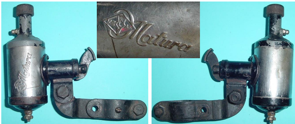
Bild 4.54: „Melas-Matura 1“ mit dreiteiligem Gehäuse
