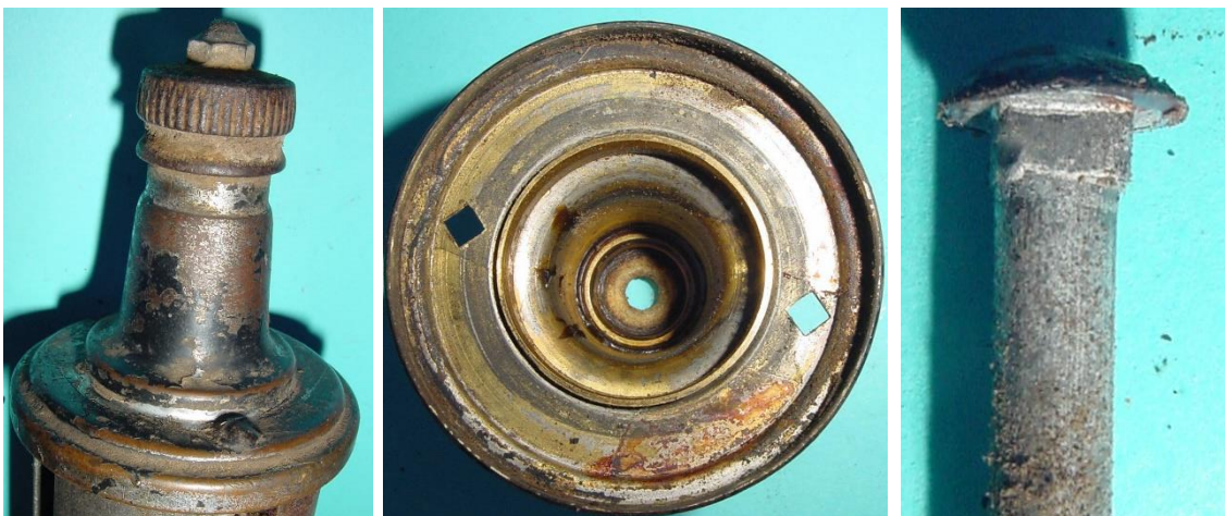
Bild 7.15: Lagerhals und Spannbolzen: a) Schraubenköpfe auf dem Lagerhalsfuß, b) Quadratische Durchbrüche für die Bolzen, c) Quadratischer Schraubenkragen
