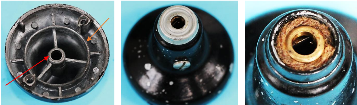
Bild 11.14: Lagerhals: a) Lagerhalsfuß, b) Schutzkappe, c) Öldepot unter der Schutzkappe
