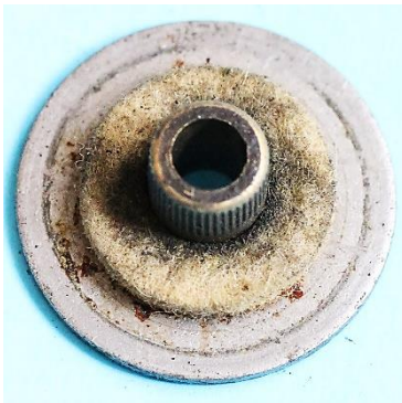
Bild 4.71: Unteres Öldepot: a) Lagerschild mit eingebautem Lager, b) Filzscheibe auf dem Lagerschild, c) Positionierung des Ölfadens
