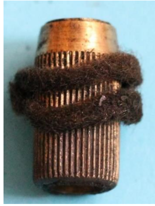
Bild 4.70: Oberes Gleitlager mit Öldepot
