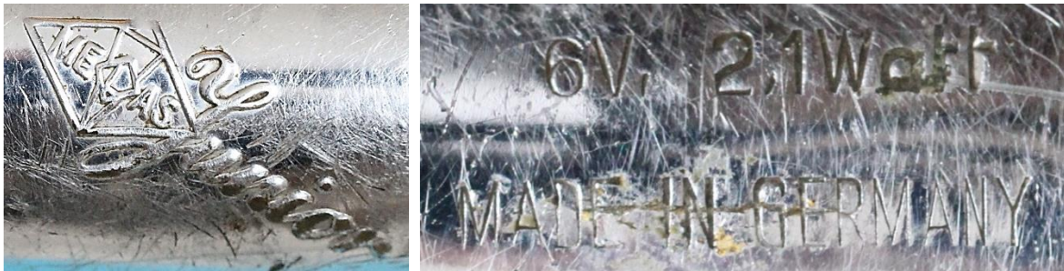
Bild 4.26: Einprägungen des Firmenlogos, des Typennamens und der Nenndaten auf dem Gehäusemantel
