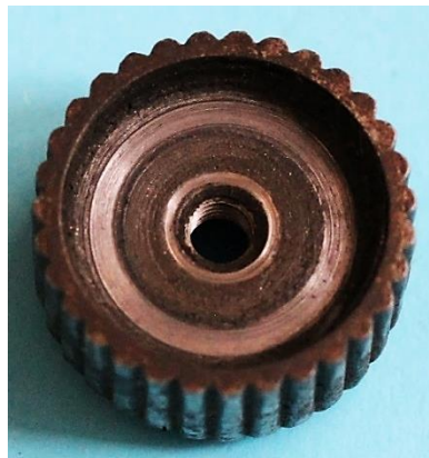
Bild 4.73: Reibrad mit Einlassungen für die Kontermutter und dem Lagerhalsrand, Durchmesser: 20 mm
