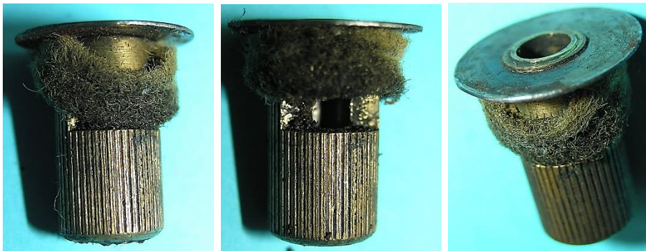
Bild 4.84: Oberes Gleitlager mit Öldepot
