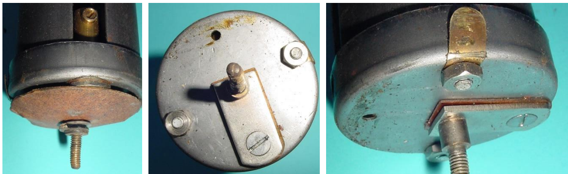
Bild 7.17: Spannung führender Kontaktbolzen: a) Isolierpappe zwischen dem Joch und dem Gehäuseboden, b) Kontaktbolzen mit isoliertem Steg und Muttern auf den Spannbolzen, c) Blech für den Kontakt zwischen Magnetsystem und Gehäusemantel
