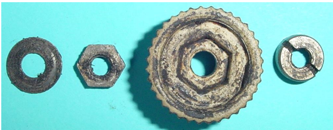
Bild 12.43: Einzelteile der Reibradbefestigung: a) Scheibe zur Abdeckung der Axialspielausgleichsfeder, b) Sechskantmutter für den Formschluss mit dem Reibrad, c) Keramisches Reibrad, d) Schlitzmutter
