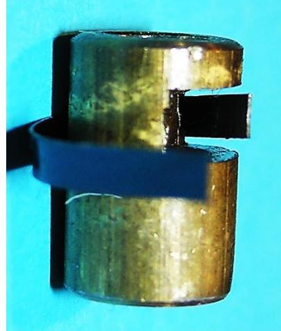
Bild 11.17: Gleitlager: a) Gleitlagersitz, b) Ausnehmung im Gleitlager für die Massefeder, c) Gleitlager mit Massefeder
