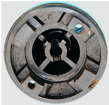
Bild 5.38: Öldepots: a) Obere Ölchamber, b) Untere Ölchammern, c) Wollknäule in den unteren Ölchammern
