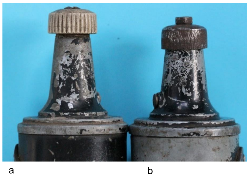
Bild 10.2: Gleiche Lagerhälse mit unterschiedlichen Reibrädern: a) Keramikreibrad mit zwei Kontermuttern, b) Weit übergreifendes Stahlreibrad mit Gewinde und einer Kontermutter
