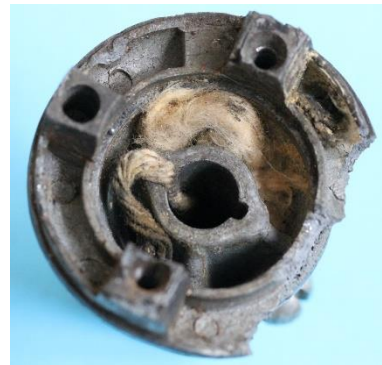
Bild 4.71: Unteres Öldepot: a) Lagerschild mit eingebautem Lager, b) Filzscheibe auf dem Lagerschild, c) Positionierung des Ölfadens
