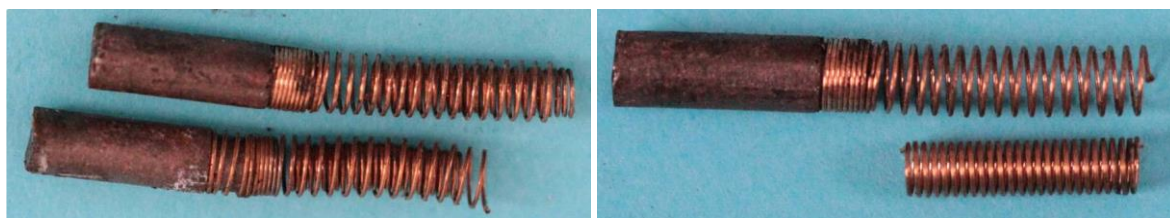
Bild 6.28: Metallbürsten: a) Federn mit Massebürste und Spannung führende Bürste, b) Äußere und innere Schraubenfeder
