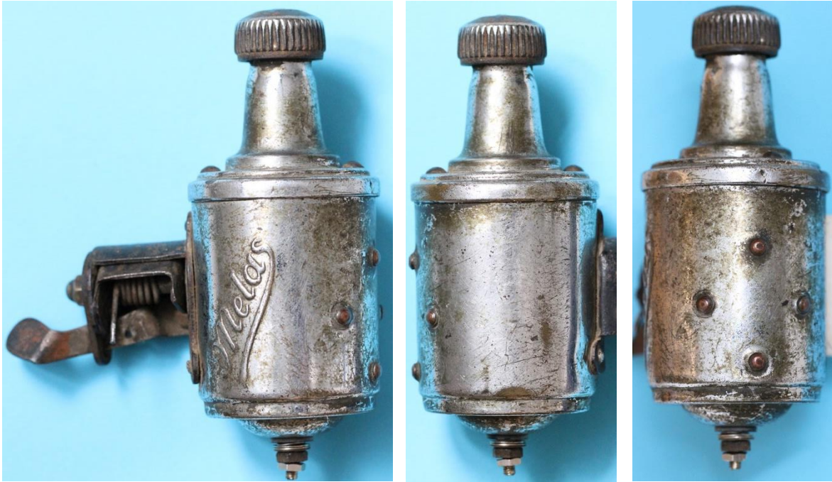
Bild 7.26: Melas 5 W mit ausgewechselter Kippvorrichtung: a) Seitenansicht mit Markennamen, b) Seitenansicht ohne Markennamen, c) Nietenverteilung der fabrikmäßigen Kippvorrichtung
