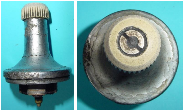
Bild 12.42: Lagerhals: a) Lagerhals mit Anker und Reibrad, b) Reibrad mit Schlitzmutter
