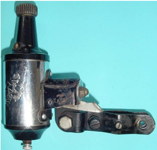
Bild 2.16: Melas-Record 1,8 W mit einem Lagerhals und einem Boden aus Duroplastwerkstoffen
