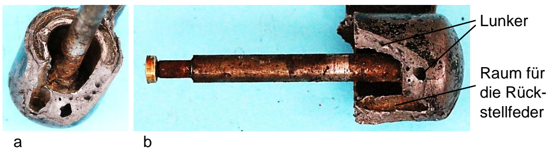
Bild 5.23: In einer Aluminiumkappe eingegossener Drehbolzen,
