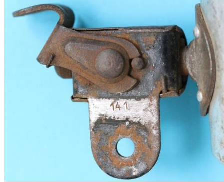
Bild 9.5: Beschriftungen: a) Keine Beschriftung auf dem Lagerhalsrand, b) Fertigungsdatum (April 1941) auf dem Halterarm
