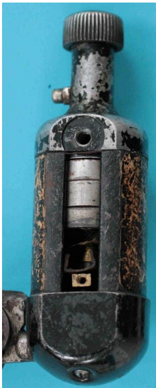
Bild 4.8: Positionierung der Magnete im Bodentopf.
