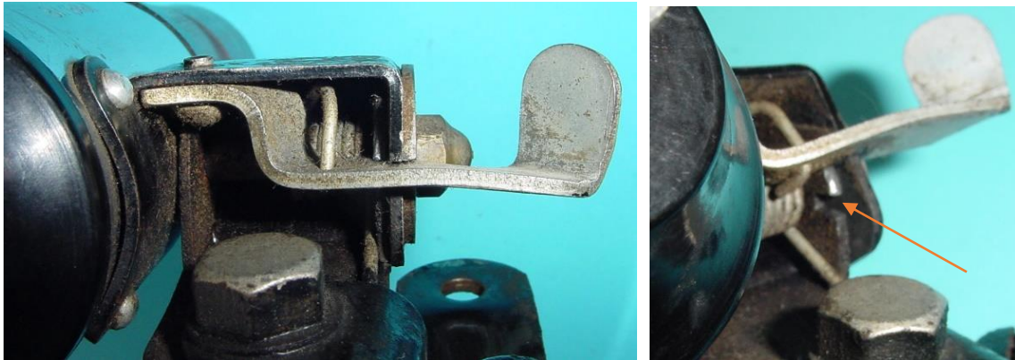
Bild 5.6: Hebelpositionen: a) Ruhestellung, b) Betriebsstellung
