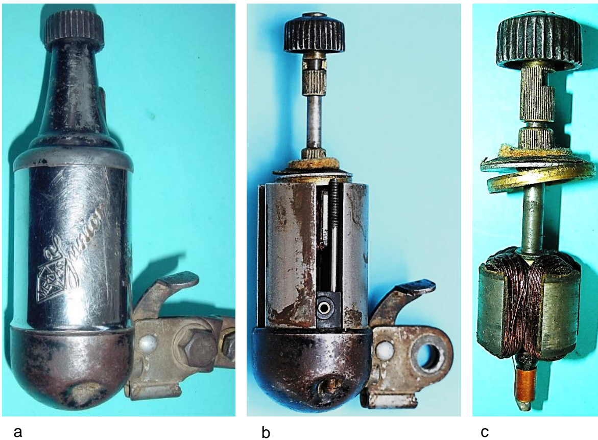
Bild 4.32: Baugruppen: a) Vollständiger Dynamokörper, b) Lagerhals und Gehäuse- mantel entfernt, c) Rotierende Baugruppe
