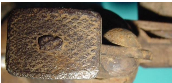
Bild 7.13: Formschlüssige Verbindung des Bedienungshebel mit der Bedienungsplattform
