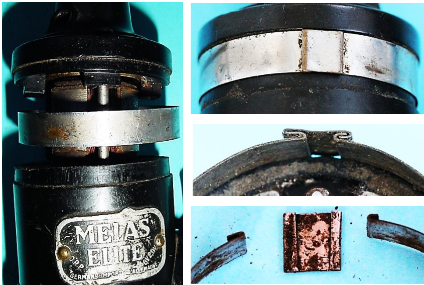
Bild 5.18: Verdeckung und Abdichtung der Stoßstelle zwischen Lagerhals und Gehäusetopf mit einem Zierband
