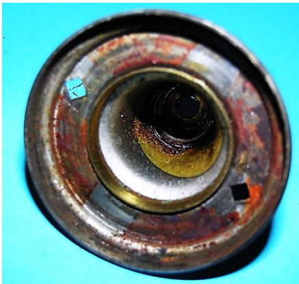
Bild 6.24: Magnetischer Rückschluss (Joch): a) Kontaktbrücke auf der Unterseite der Jochschüssel, b) Viernutiges Jochinnenteil mit Lagerschale
