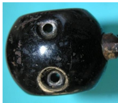
Bild 4.6: Messingsteg zur Befestigung der Pollückenbleche a) Messingsteg mit Gewindebolzen b) Bohrungen im Bodentopf
