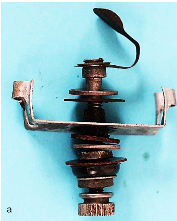
Bild 11.11: Kontakte: a) Armaturen auf dem Kabelanschlussbolzen b) Spulenanschluss und Kupferbürste
