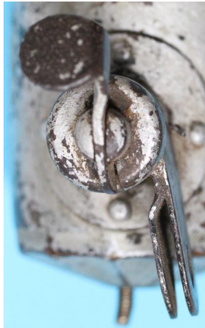
Bild 7.4: Kippvorrichtung: a) Eingriff des Bedienungshebels im Drehbolzen, b) Geteilter Halterarm
