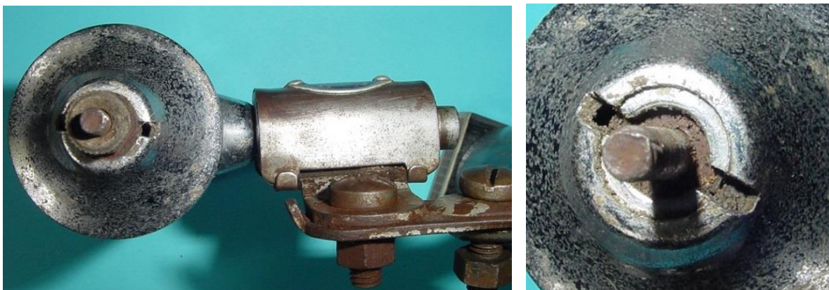
Bild 13.19: Bodenansicht mit den Schlüsselnuten zum Verschrauben des Bodens mit dem Lagerhalstopf
