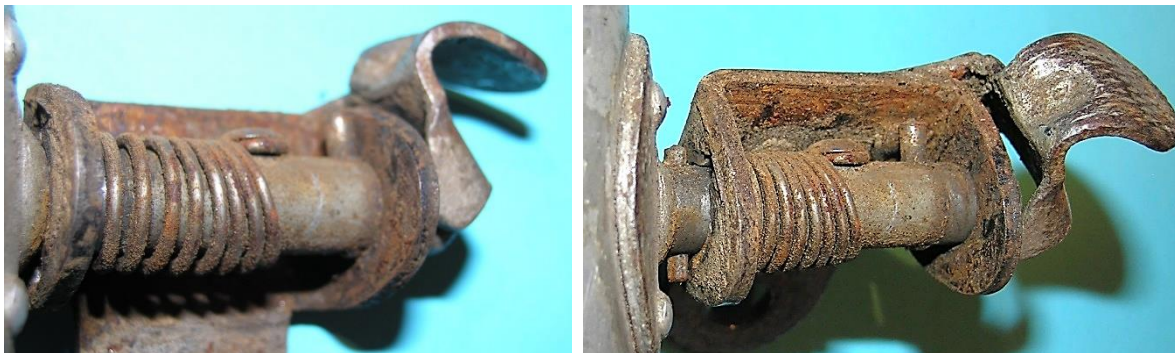
Bild 9.11: Ausgeprägte Positionen des Drehbolzens: a) Ruhestellung, b) Betriebsstellung
