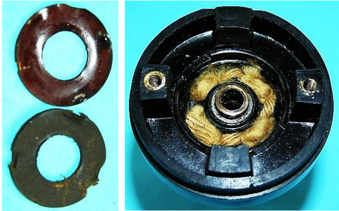
Bild 5.45: Öldepot: a) Kunststoff- und Papierscheibe zum Abdichten des Öldepots, b) Eingelegter Wollfaden
