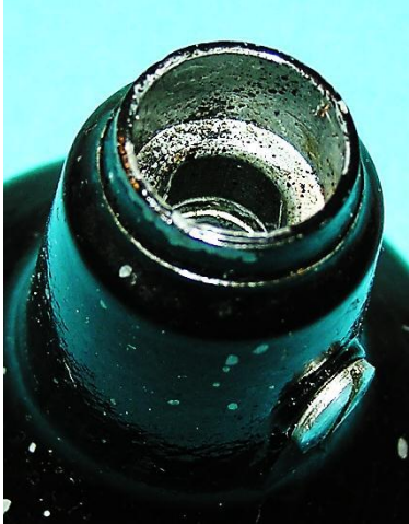
Bild 11.17: Gleitlager: a) Gleitlagersitz, b) Ausnehmung im Gleitlager für die Massefeder, c) Gleitlager mit Massefeder
