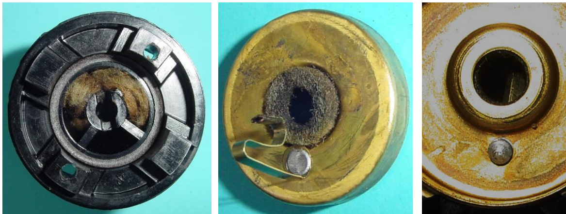
Bild 5.11: Unteres Öldepot: a) Fadenknäuel, b) Filzring und Massekontaktfeder am Öldepotdeckel, c) Nietkopf der Massekontaktfeder
