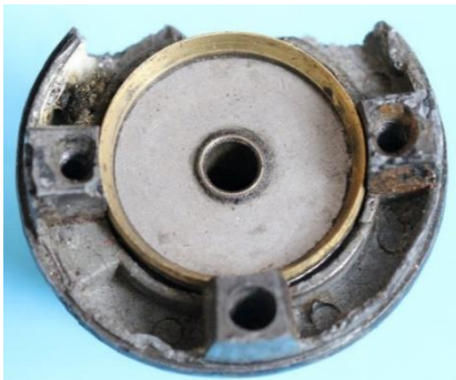
Bild 4.71: Unteres Öldepot: a) Lagerschild mit eingebautem Lager, b) Filzscheibe auf dem Lagerschild, c) Positionierung des Ölfadens
