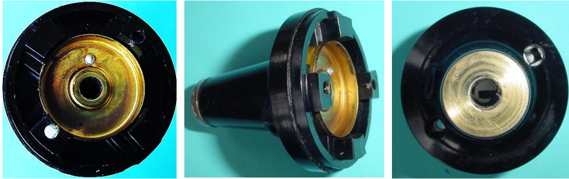
Bild 5.10: Abdeckungen der Öldepots: a) Abdichtung des unteren Öldepots, b) Justier­rand an der Messingscheibe, c) Abdeckung des oberen Öldepots
