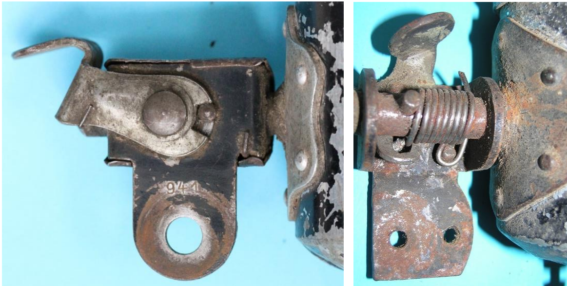
Bild 9.3: Kippvorrichtungen der Gruppe 3: a) Klappenhebel-Kippvorrichtung, b) Kulissenhebel-Kippvorrichtung
