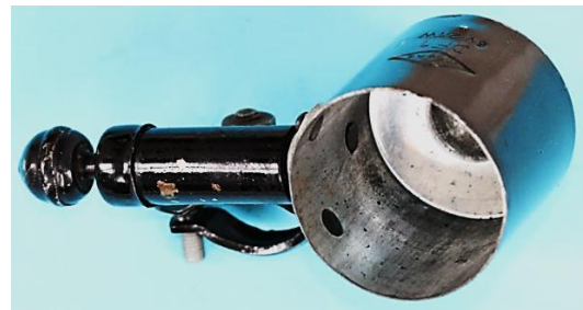
Bild 11.7: Gehäusetopf: a) Boden ohne stabilisierende Rippen, b) Innenansicht mit den Nietköpfen des Flansches der Kippvorrichtung
