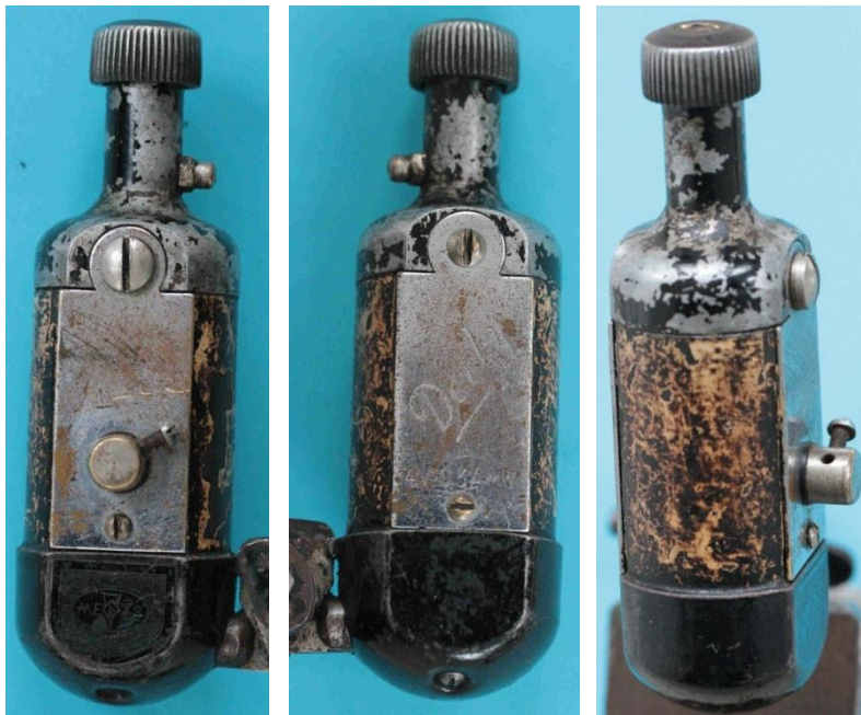
Bild 4.5: Oberflächen a) Pollückenblech mit Kabelanschluss b) Pollückenblech mit Typenbezeichnung c) Sichtbarer Stabmagnet zwischen Lagerhals und Boden
