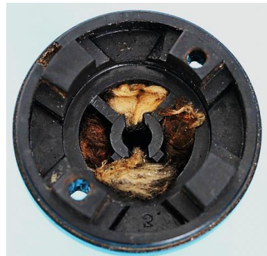
Bild 5.38: Öldepots: a) Obere Ölchamber, b) Untere Ölchammern, c) Wollknäule in den unteren Ölchammern
