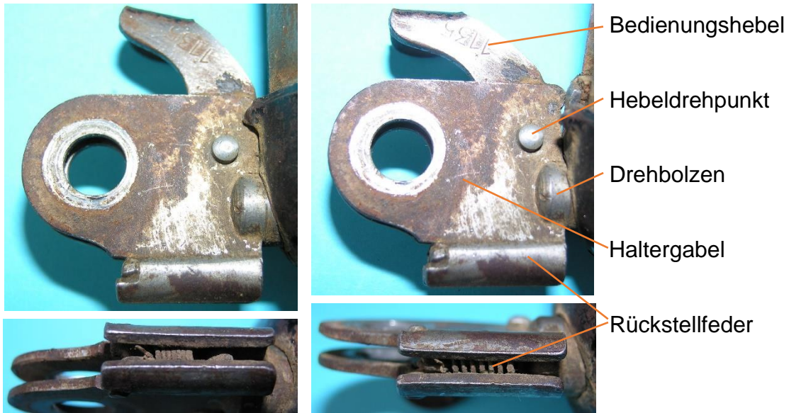
Bild 4.31: Aufbau der Kippvorrichtung: a) Ruhestellung, b) Betriebsstellung
