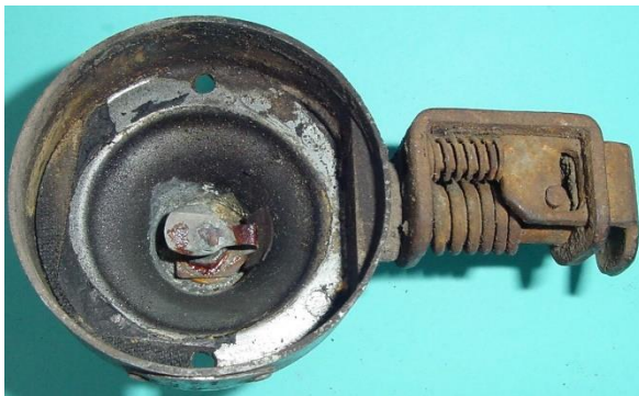
Bild 12.14: Blattfeder zur Kontaktierung der Kupferbürste am Gehäuseboden
