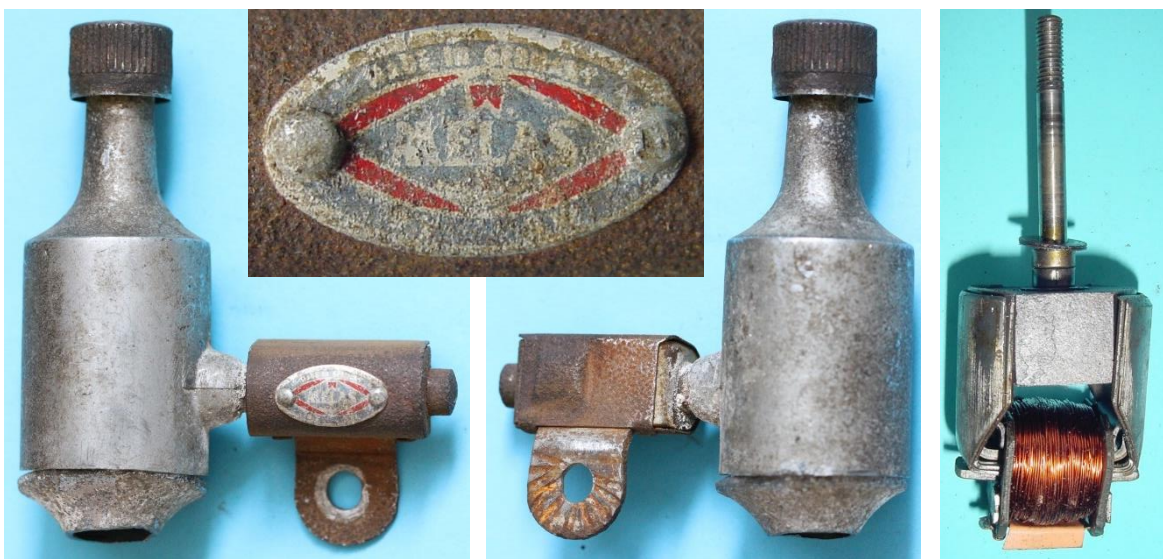
Bild 13.12: Melas-Dynamo mit eingegossenem Drehbolzen und verstärktem Joch
