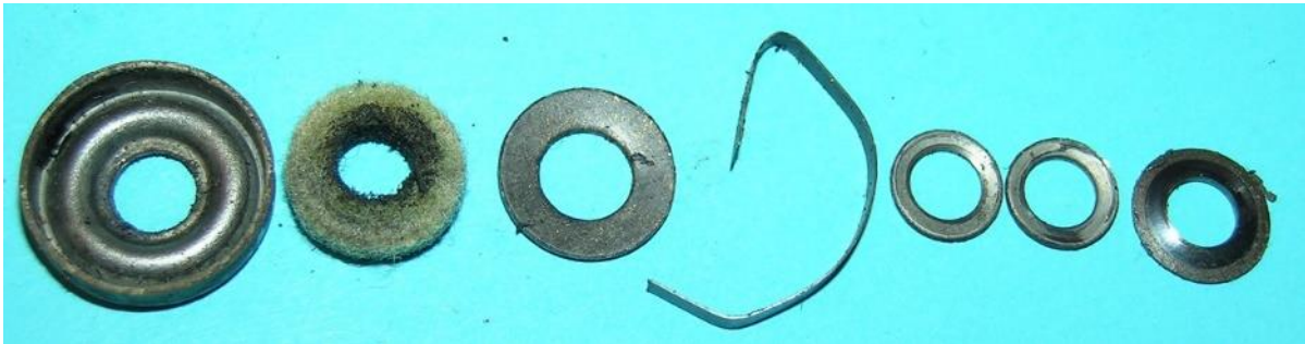
Bild 10.12: Elemente des Öldepots: a) Schutzkappe, b) Ölfiltz, c) Stützscheibe über der Massefeder, d) Massefeder, e) Scheiben unter der Massefeder
