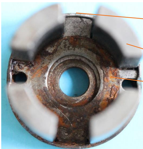
Bild 4.67: Verspannung der Magnete durch das ferromagnetische Joch
