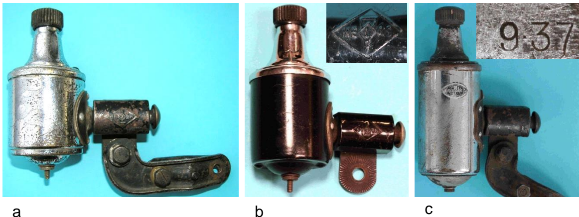
Bild 6.1: Leistungsstufen der Dynamos mit einer pilzschirmförmigen Bedienungsfläche: a) 1,2 W bzw. 1,5 W, b) 5 W, c) 8 W
