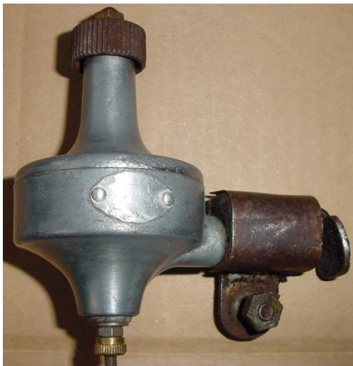
Bild 12.20: Verschraubung beider Gehäuseteile durch ein Außengewinde im Lagerhals und ein Innengewinde im Gehäusetopf
