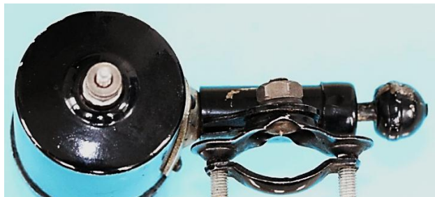
Bild 11.7: Gehäusetopf: a) Boden ohne stabilisierende Rippen, b) Innenansicht mit den Nietköpfen des Flansches der Kippvorrichtung
