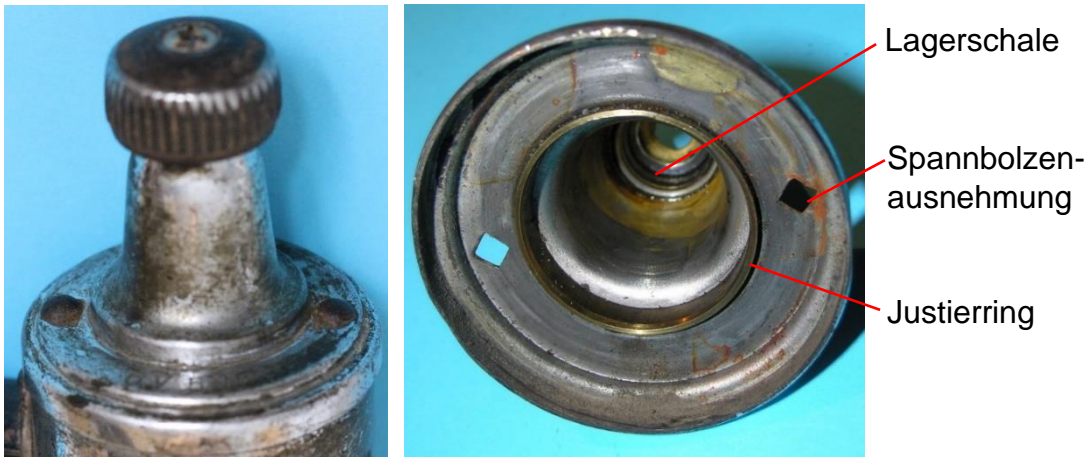
Bild 7.29: Lagerhals: a) Schraubenköpfe auf dem Lagerhalsfuß, b) QUADRATISCHE Ausnehmungen für die Spannbolzen
