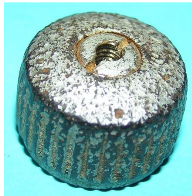
Bild 7.5: Reibrad mit versenkter Kontermutter
