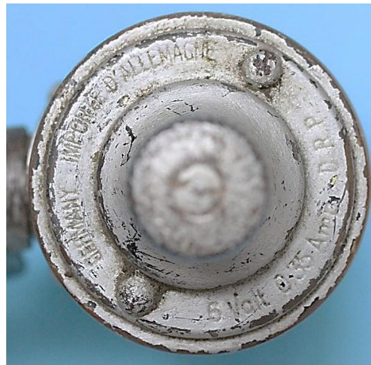
Bild 7.6: Platzierung der Nenndaten auf dem Lagerhalsfuß, 2,1 W
