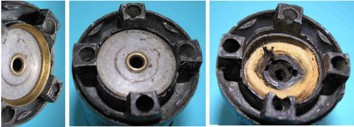
Bild 4.86: Lagerschild: a) Messingring zur Befestigung des Lagerschilds, b) Position des Lagerschilds im Lagerhalsfuß, c) Öldepot oberhalb des Lagerschilds
