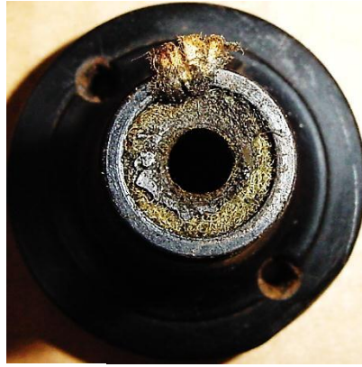
Bild 5.37: Öldepot: a) Abdeckung des Filzringes unterhalb des Reibrades, b) Filzring,
