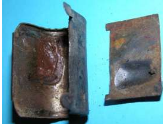
Bild 2.17: Abdeckung der Kippvorrichtung a) Basisblech, b) Backblech c) Schutzblech für die Kulissenbahn
