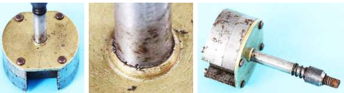
Bild 2.15: Befestigung der Welle senkrecht auf der oberen Messingplatte
