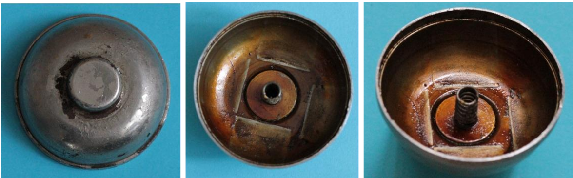
Bild 1.17: Boden: a) Ausstülpung des Lagersitzes, b) Innenseite des Bodens, c) Feder für den Axialspelausgleich
