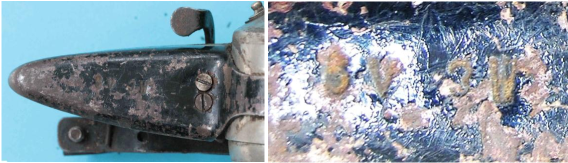
Bild 1.15: Nenndaten3 V und 3 W auf der Abdeckung der Kippvorrichtung
