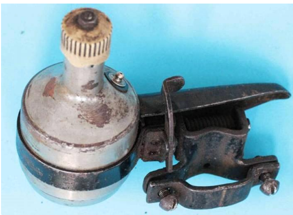
Bild 1.8: Dynamoansichten: a) Halterseite, b) Großflächiges Ende des Spannbandes
