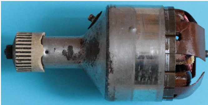
Bild 1.16: Dynamokörper mit abgeschnittenem Boden
