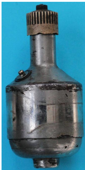
Bild 1.5: Dynamokörper und Spannband mit Kippvorrichtung
