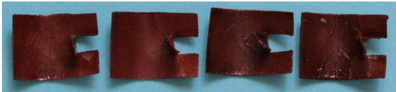
Bild 1.21: Vier Iso-lie-elemente für die Wicklungsköpfe auf jeder Stirnseite des Ankers
