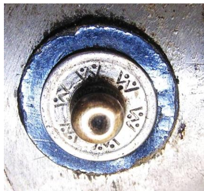
Bild 1.14: Spannung führender Kontakt am Lagerhalsfuß
