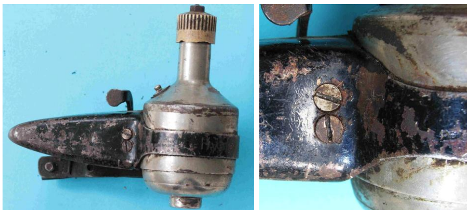
Bild 1.4: Befestigung des Spannbandes: a) Großflächiges Ende des Spannbandes, b) Schlitzschrauben zum Lösen des Spannbandes
