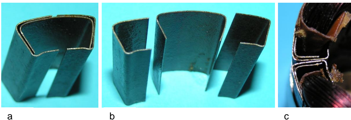
Bild 1.25: Elemente des magnetischen Kreises: a) Umhüllung einer Spulenseite, b) Zwei Polschuhbleche und ein Jochblech, c) Vier Bleche des Polschafts
