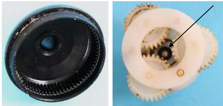
Bild 2.11: Planetengetriebe- stufe: a) Hohlrad, b) Planetenträger mit Axiallager
