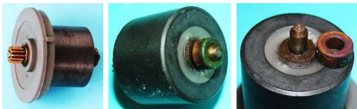
Bild 2.13: Lagerung: a) Getriebeseitiges Gleitlager mit Lagerschild, b) Lager im Generatorgehäuse
