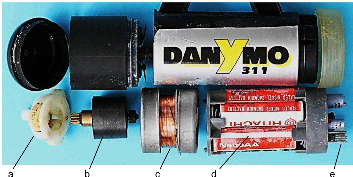
Bild 2.18: Baugruppen des Gehäuses: a) Planetengetriebebestufe, b) Polrad, c) Anker (Klauenpolringe auseinandergeschoben), d) Akkubatterie, e) Elektronische Bauteile und Kontaktstifte)
