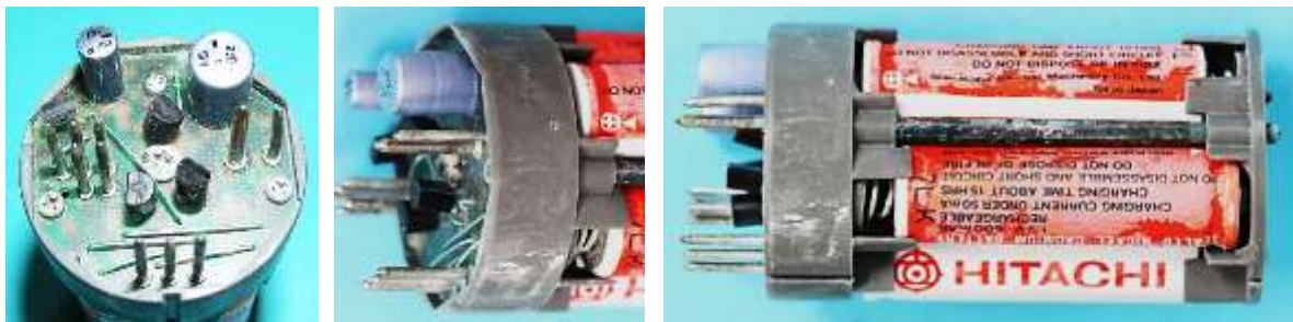
Bild 2.17: Akkubatterie mit der Elektronikbaugruppe
