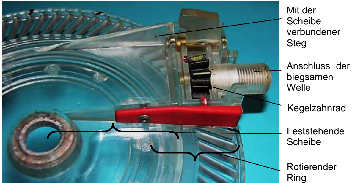
Bild 2.3: Gegeneinander verdrehbare Teile des Dynamoantriebs
