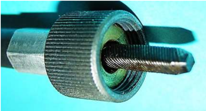
Bild 2.5: Zum Vierkant geformte Drahtwendel
