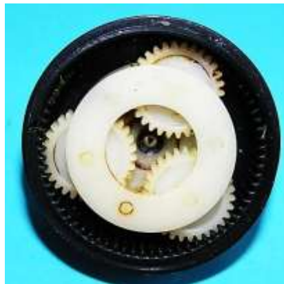
Bild 2.7: Getriebestufen a) Winkelgetriebestufe b) Planetengetriebe- stufe
