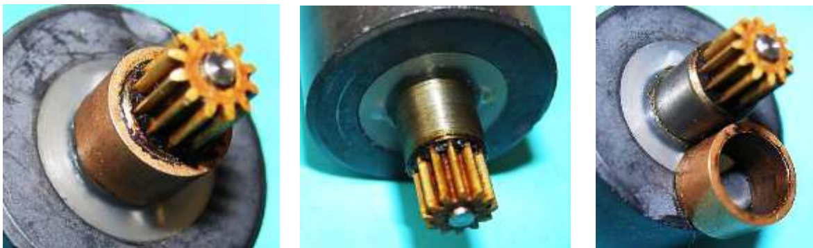
Bild 2.12: Gleitlager am Sonnenrad: a) Aufgeschobenes Lager, b) Welle ohne Lager, c) Welle und Lager
