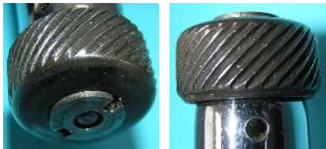
Bild 3.4: Reibrad in Vorgängervarianten ohne Schleuderkante
