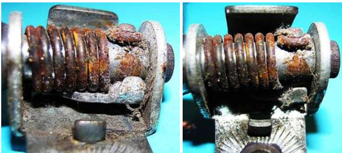
Bild 3.10: Veränderung der relativen Lage von Sperrstift und Fußhebel: a) Ruhestellung, b) Betriebsstellung
