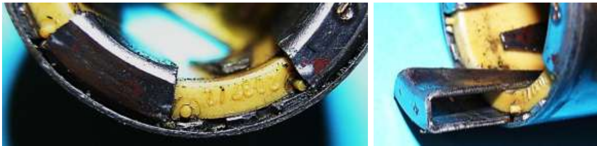
Bild 3.13: Polelemente des Ankers: a) Stirnansicht der Einzelpole und des Ständerjochs, b) Herausgezogenes Polelement
