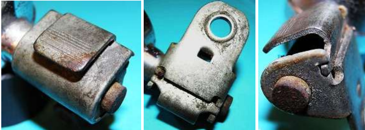
Bild 3.9: Kippvorrichtung mit Fußhebel: a) Fußhebel, b) und c) Lagerung des Fußhebels im Basisblech
