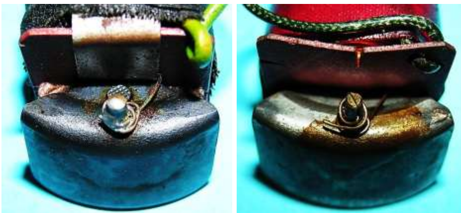
Bild 2.27: Masseanschluss: a) Lucifer 800 D b) Lucifer 800a S
