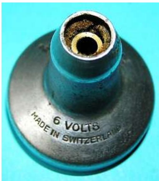
Bild 1.27: Oberes Lager: a) Lagerhals mit eingezogenem Rand, b) Filzring über den Filzmatten zum Abschluss des Öldepots
