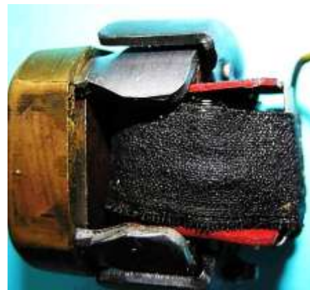
Bild 1.43: a) Lagerhals mit Polrad, b) Anker, c) Polrad und Anker
