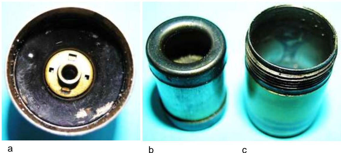
Bild 2.16: Lager: a) Lagerhals mit Lagereinheit, b) Rohr mit zwei Lagersitzen, c) Lagergehäuse
