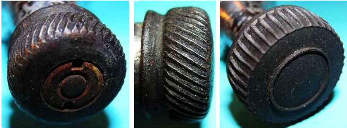
Bild 3.3: Reibrad (22 mm Durchmesser): a) Versenkte Schlitzmutter, b) Geschrägte Rippen und Schleuderkante, c) Gummikappe mit 31 mm Durchmesser
