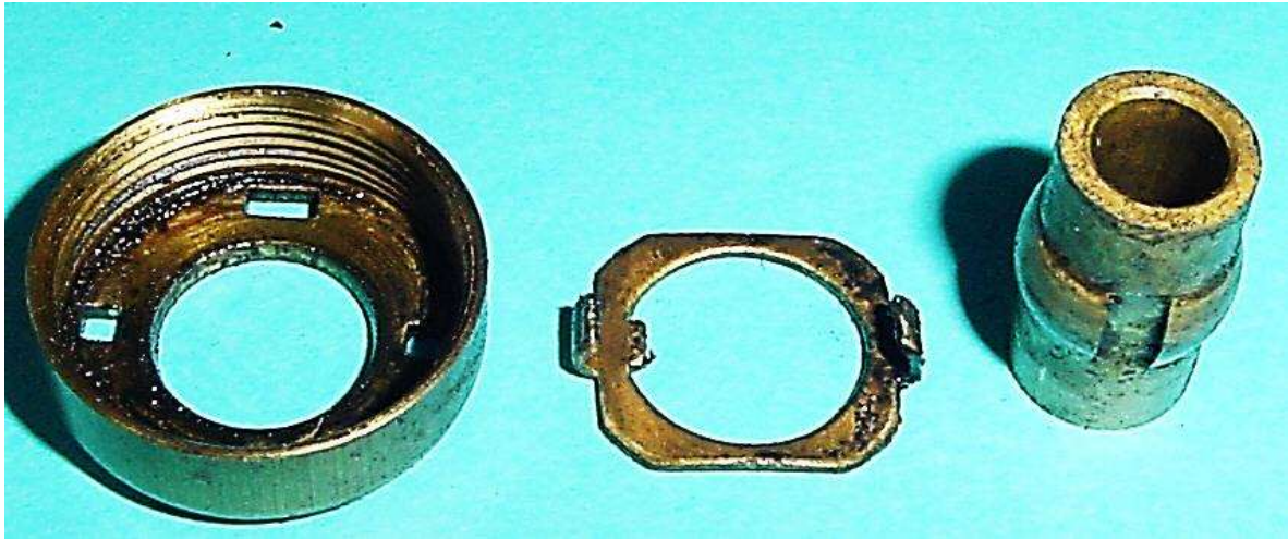
Bild 2.17: Unteres Lager: a) Lagergehäuseverschraubung, b) Lagerbrille, c) Kalotte
