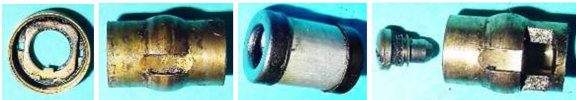
Bild 2.18: Lagereinheit: a) Gehäuseverschraubung mit Lagerbrille, b) unteres Kalottenlager, c) Rohr mit zwei Lagersitzen, d) Ölschraube, e) Lagergehäuse
