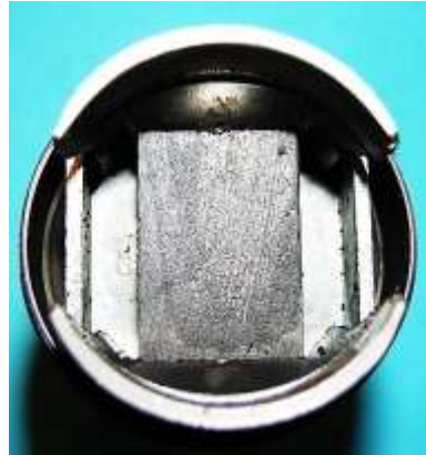
Bild 2.22: Polrad Lucifer 800a S403953 (Fe 57 %, Co 22 %, Ni 15 %, Cu 6 %)
