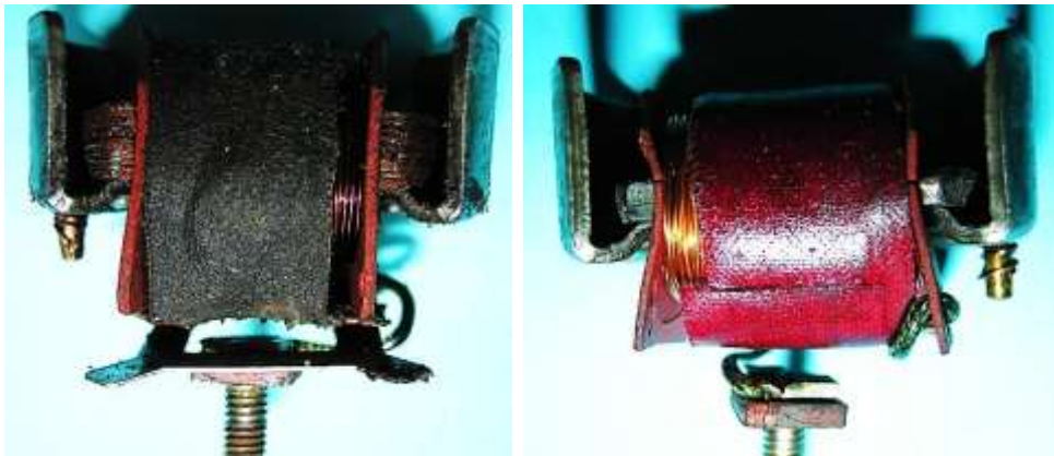
Bild 2.29: Ersatz des 6 mm starken Blechpakets durch ein 3 mm dickes Blech
