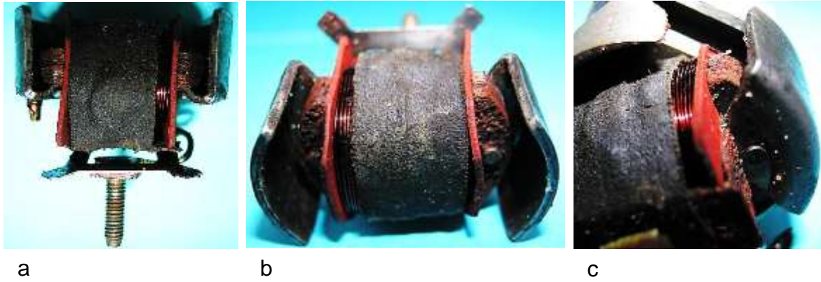
Bild 2.12: Positionierung der Polradpolschuhe zwischen den Ankerpolflächen
