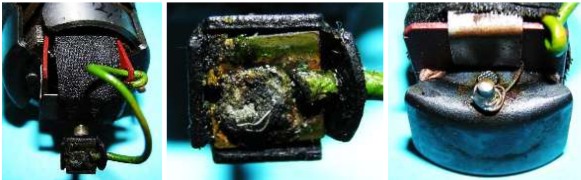
Bild 1.45: Kontaktierung: a) Befestigung der Anschlusslitze am Spulenkörper, b) Lötstelle am Kabelanschluss c) Massekontakt
