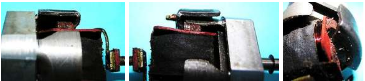
Bild 2.13: Positionierung der Polschuhe des Polrades zwischen den Ankerpolflächen
