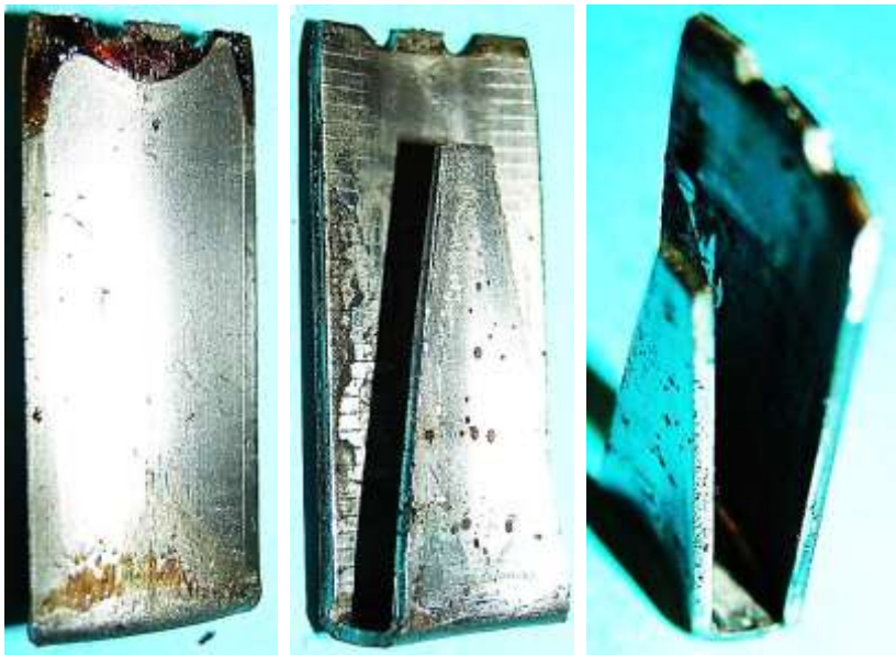
Bild 3.14: Polelement: a) Fläche für den Übergang des magnetischen Flusses zum Joch, b) Trapezförmige Polfläche, c) Wickelraum
