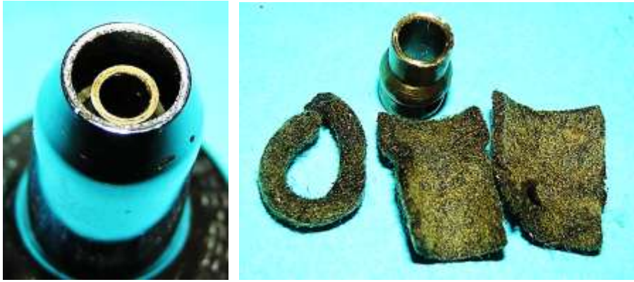
Bild 1.39: Oberes Kalottenlager mit Filzelementen
