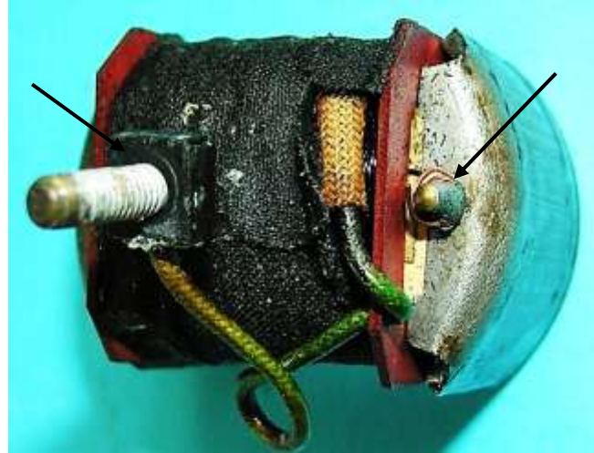
Bild 1.30: Spulenanschlüsse: a) Gehäusetopf mit dem Rahmen für den verdrehsicheren Kabelanschlussbolzen, b) Kabelanschlussbolzen und Massekontakt
