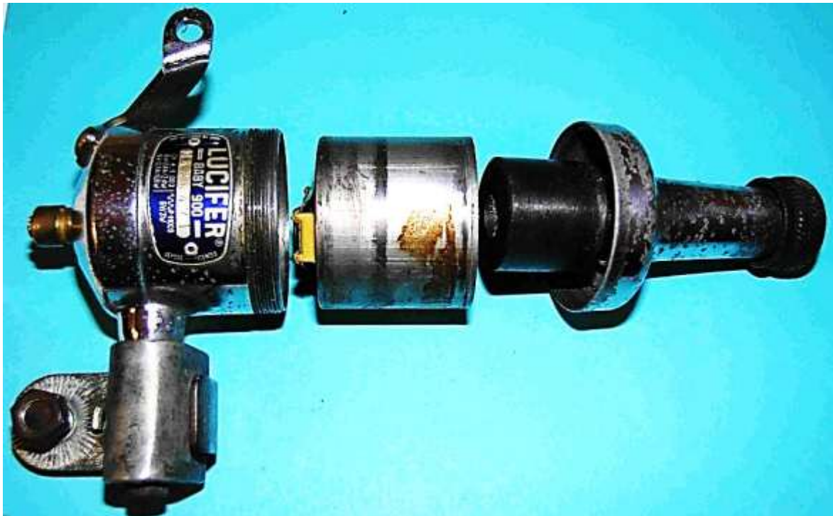
Bild 3.11: Baugruppen des Dynamos: a) Gehäusetopf mit Kippeinrichtung, Kabelanschluss und Lampenarm, b) Ankerjoch, c) Walzenmagnet, Durchmesser 24 mm, axiale Länge 20 mm
