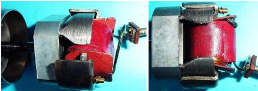
Bild 2.26: Zwei Positionen des Polrades relativ zum Anker
