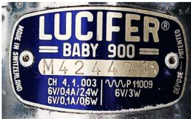
Bild 3.2: Leistungsschild mit der Leistungsaufteilung für Scheinwerfer und Rücklicht
