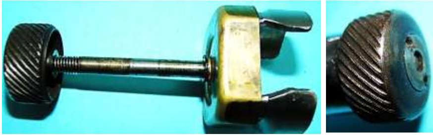
Bild 1.36: Läuferwelle mit Adapter und den Polschuhen
