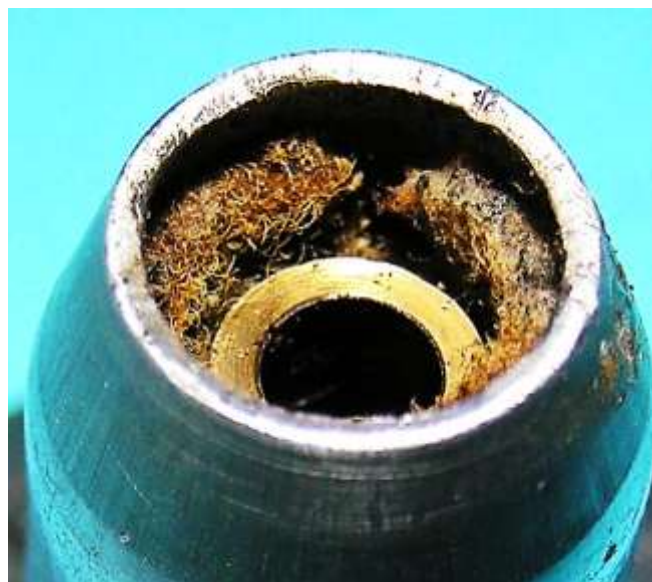
Bild 1.27: Oberes Lager: a) Lagerhals mit eingezogenem Rand, b) Filzring über den Filzmatten zum Abschluss des Öldepots
