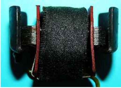
Bild 1.41: Ankerspule mit Blechpaket: Seitenansicht des Ankers, b) Axialer Ankerquerschnitt
