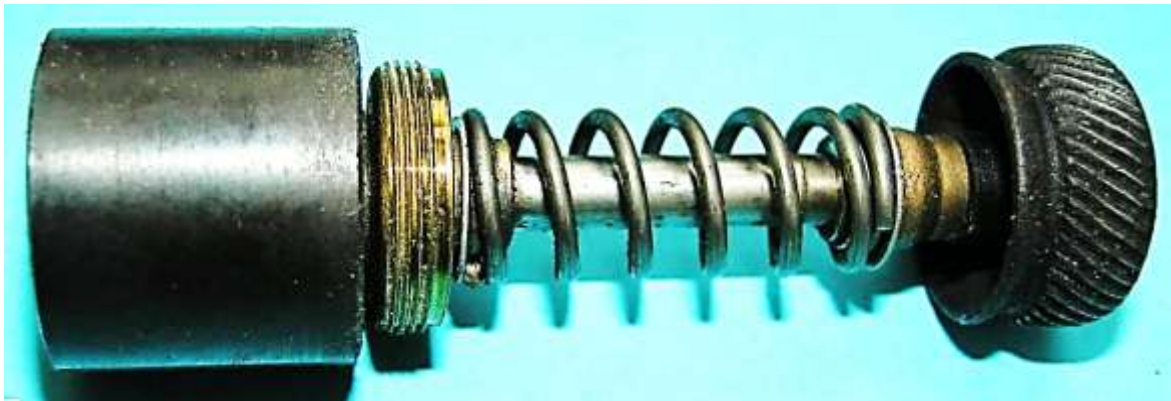
Bild 3.16: Polrad mit Welle, Reibrad und Lagerelementen
