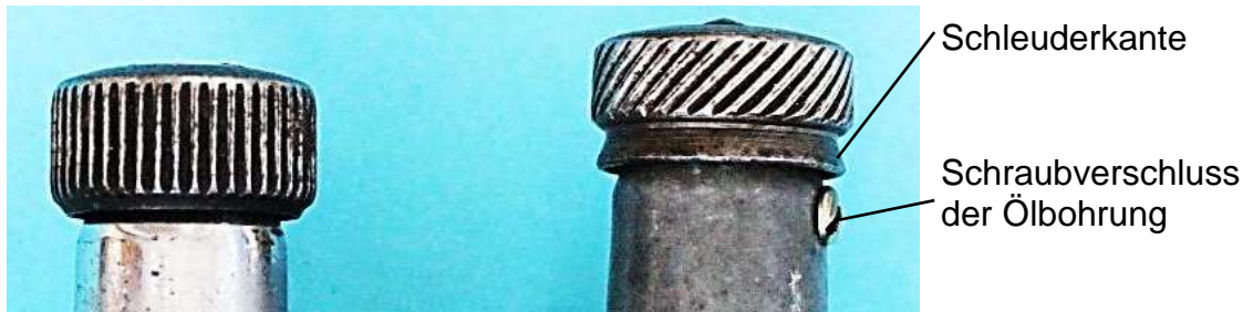
Bild 1.12: Veränderungen am Reibrad: a) Lucifer Baby 210166, b) Lucifer-Baby 700 B 727039
