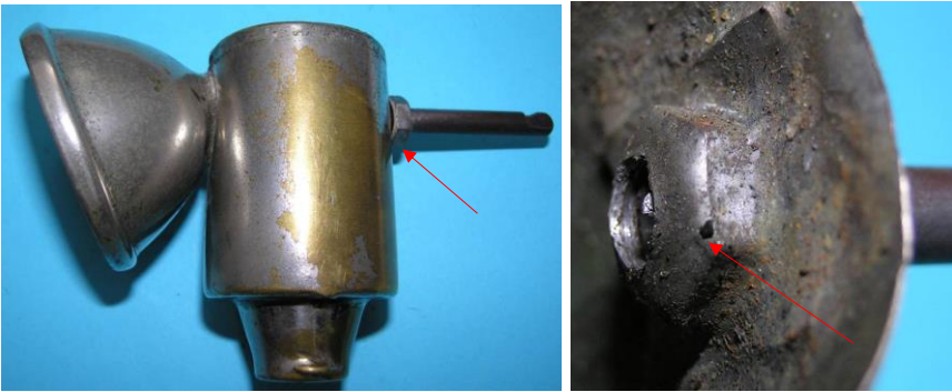
Bild 3.4: Befestigung des Drehbolzens am Gehäusemantel
