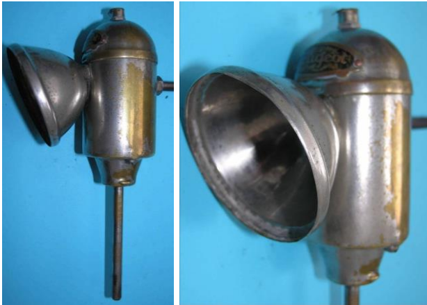
Bild 3.1: Peugeot, eine Dynamo-Lampen-Kombination in Oberlage
