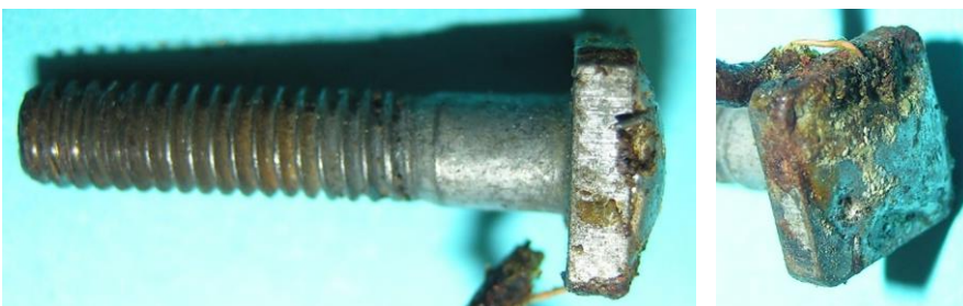
Bild 3.26: Lötstelle am quadratischen Bolzenkopf
