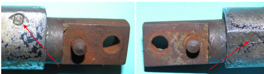
Bild 3.20: In einer Durchgangsbohrung des Gehäusestutzens eingepresster Sperrstift
