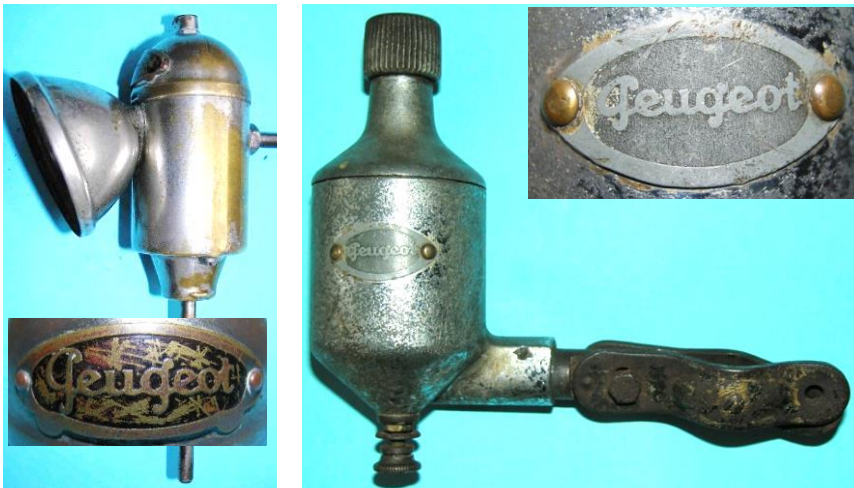
Bild 1.1: Peugeot-Dynamos: a) Dynamo-Lampen-Kombination mit Tulpenmagneten und Doppel.T-Anker, b) 6-poliger Dynamo mit AlNi-Magnetwalze
