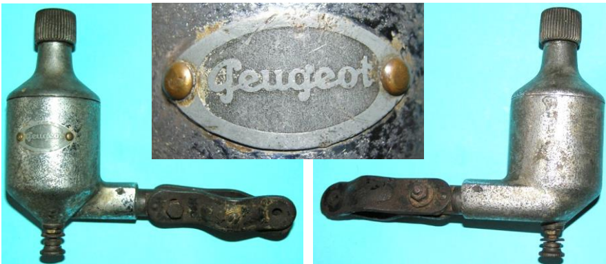
Bild 3.13: 6-poliger Dynamo der Marke Peugeot mit AlNi-Polrad (Gewicht 480 g)
