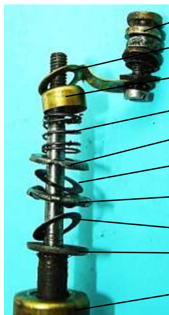
Bild 3.9: Spannung führender Kontakt: a) Anker mit den Spannung führenden Bauteilen auf der Welle, b) Einzelteile des Stromkreises vom Anker bis zum Kabelanschlussbolzen
