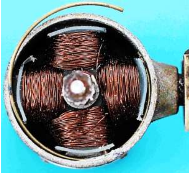
Bild 6.3: Kreuzförmige Grundstruktur des Ankers
