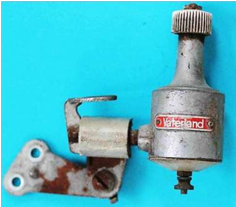
Bild 6.1: Dynamoausführung mit Blätterpolanker
