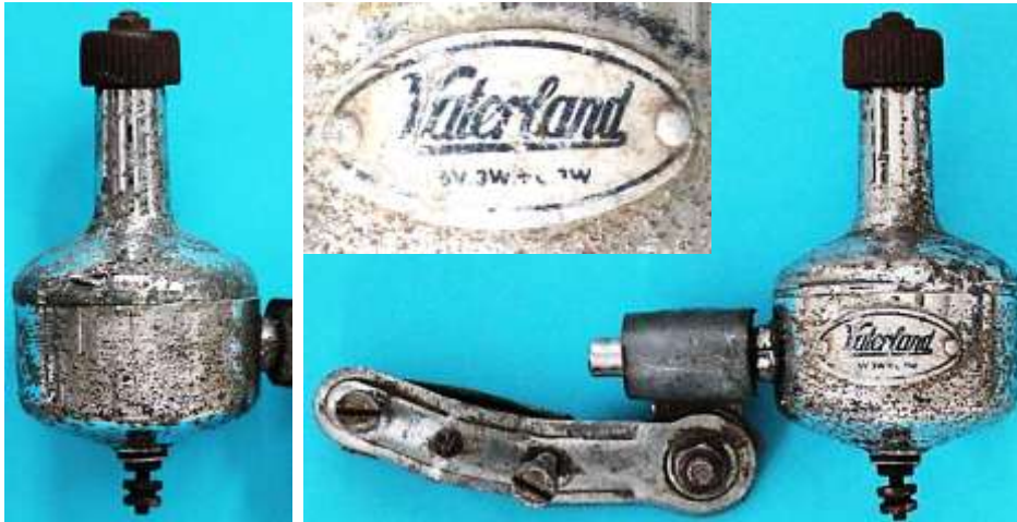
Bild 4.1: Dynamo mit Klauenpolanker und Klauenpolrad
