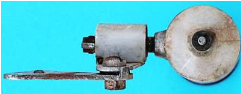
Bild 6.6: Boden und Abdeckung der Kippvorrichtung aus Kunststoff
