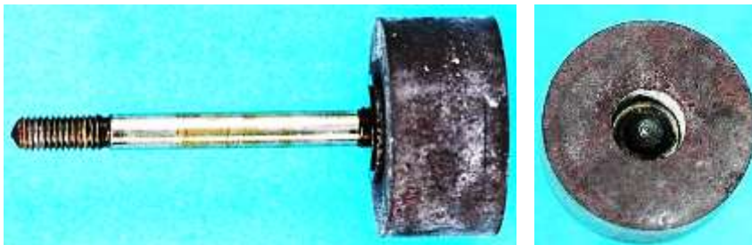
Bild 6.5: Polrad a) Mit Welle b) Bohrung mit eingegossener Welle
