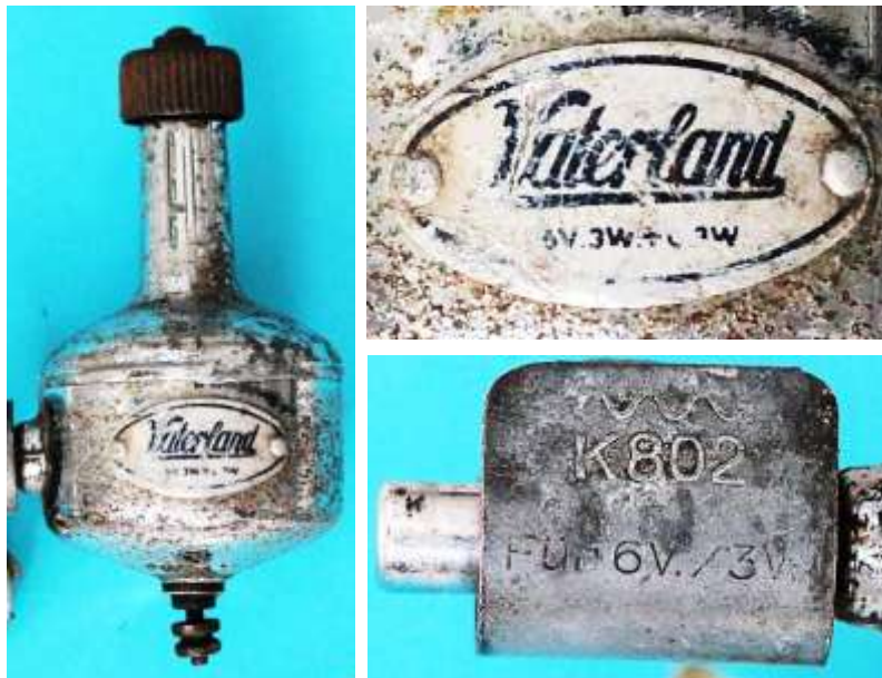
Bild 4.2: Beschriftungen auf dem Gehäusemantel und auf der Kippvorrichtung
