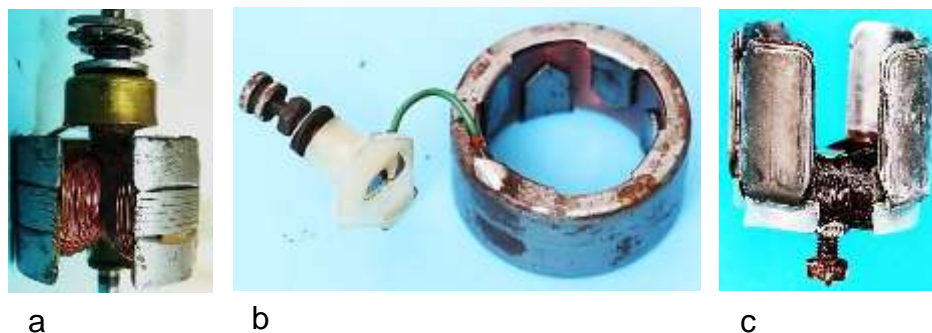
Bild 2.4: Anker: a) Vierpoliger Sternanker, b) Klauenpolanker, c) Blätterpolanker
