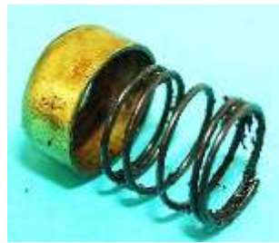
Bild 3.8: Komponenten des Strompfads: Schraubenfeder und Kontaktkappe
