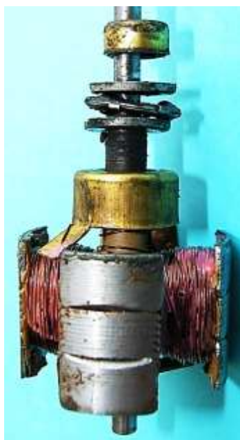
Bild 3.9: Spannung führender Kontakt: a) Anker mit den Spannung führenden Bauteilen auf der Welle, b) Einzelteile des Stromkreises vom Anker bis zum Kabelanschlussbolzen
