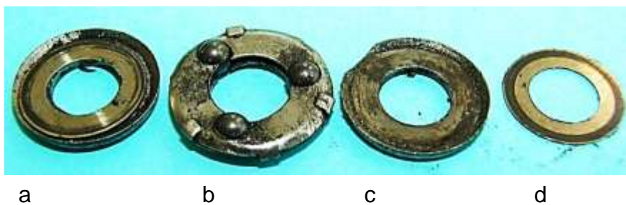
Bild 3.7: Axiallager im Stromkreis: a) Lagerschale mit Stahlscheibe, b) Kugellagerkäfig, c) Lagerschale, d) Lagerscheibe
