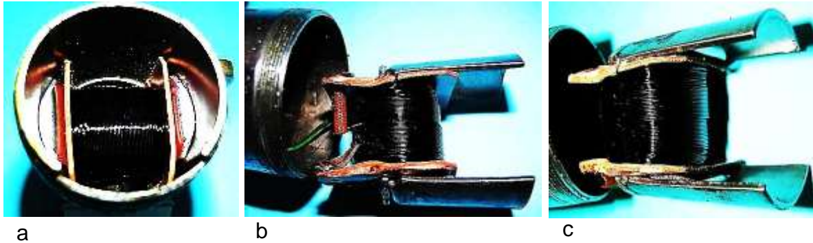
Bild 5.10: Anker: a) Position im Gehäusetopf, b) und c) Pole und Spule
