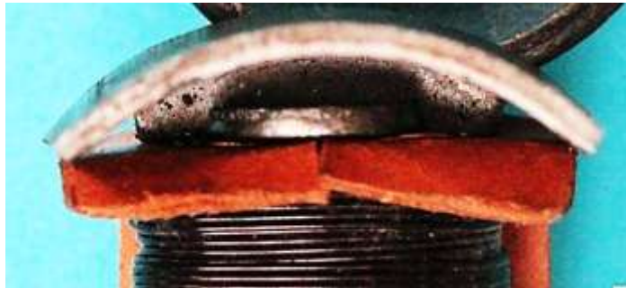
Bild 2.11: Stabilisierung des Spulenkastens: a) Ankerpule b) Abgewinkelte Jochverstärkung zur Stabilisierung des Spulenkastens
