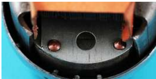
Bild 2.12: Polradpositionen: a) Polradpolschuh in der Ankerpollücke, b) Pollücke des Polrades in der Ankerpollücke
