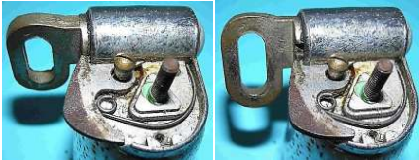
Bild 5.7: Eingebaute Bauteile der Kippvorrichtung: a) Arretierter Dynamo, b) Betriebsposition
