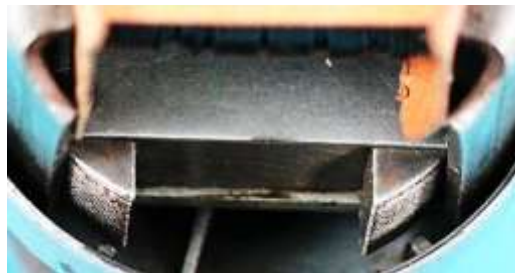
Bild 2.12: Polradpositionen: a) Polradpolschuh in der Ankerpollücke, b) Pollücke des Polrades in der Ankerpollücke
