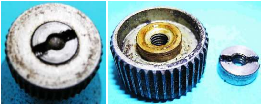
Bild 5.18: Schlitzmutter zum Kontern des mit einem Innengewinde ausgerüstetem Reibrades
