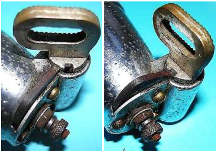
Bild 5.8: Stellungen des Drehbolzens: a) Betriebsstellung, b) Eingeklinkter Schieber
