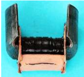
Bild 2.11: Stabilisierung des Spulenkastens: a) Ankerpule b) Abgewinkelte Jochverstärkung zur Stabilisierung des Spulenkastens
