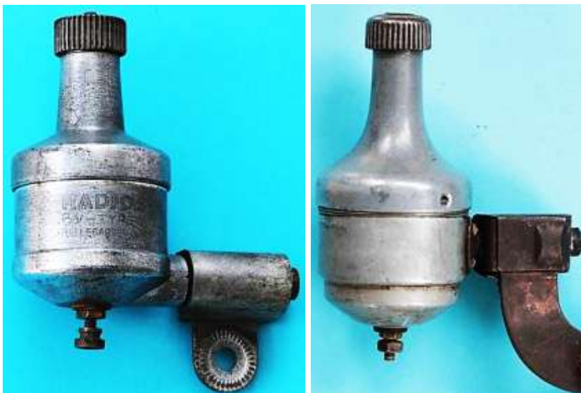
Bild 2.2: Gegenüberstellung: a) Radios Typ M b) Unbeschrifteter Dynamo
