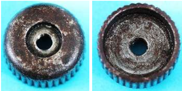
Bild 2.4: Reibrad aus Stahlguss
