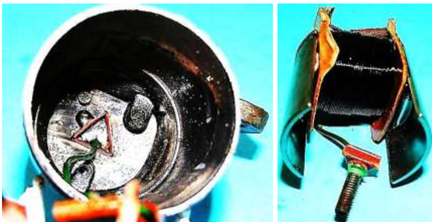
Bild 5.9: Spannung führender Kontakt: a) Bolzenkopf mit Lötstelle, b) Anker mit Kabelbolzen
