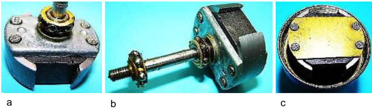
Bild 5.15: Polrad: a) Polradplatte mit Welle, b) Zwei Kugellager auf der Welle, c) Untere Polradplatte
