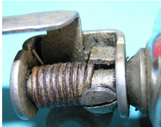
Bild 3.7: Ruhestellung und Betriebsstellung des Sperrbolzens
