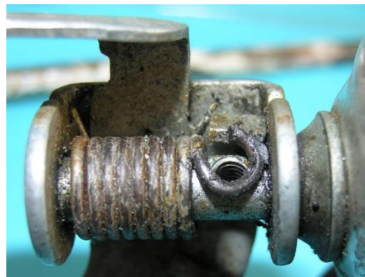
Bild 3.8: Drehbolzen mit eingeschraubtem und entferntem Sperrstift
