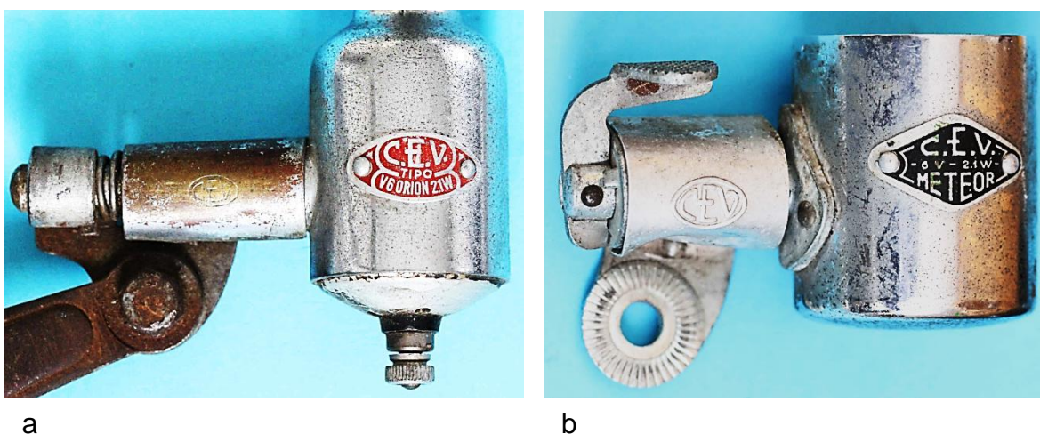
Bild 2.27: Gegenüberstellung der Kippvorrichtungen und der Gehäusekonzepte
