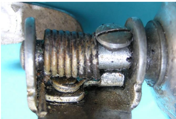
Bild 3.8: Drehbolzen mit eingeschraubtem und entferntem Sperrstift
