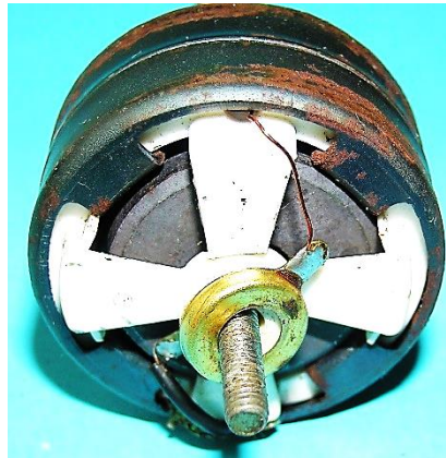
Bild 1.5: 8-poliger Klauenpolgenerator der Kugeldynamos
