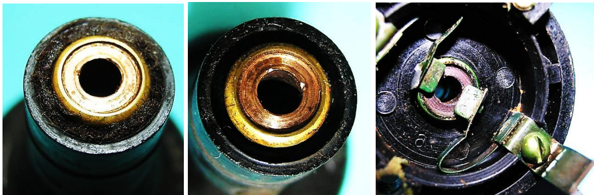
Bild 2.17: Lagerrohr: a) Abdichtung des oberen Lagerrands, b) Schlusscheibe aus Messing, c) Hartgewebescheiben als Gleitlager
