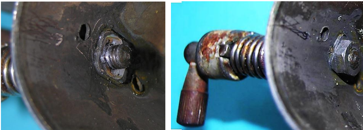
Bild 2.10: Befestigung des Drehbolzens am Gehäusemantel
