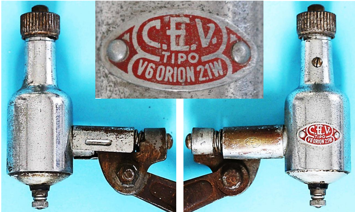
Bild 2.20: Zwei Ansichten des Dynamos V6 Orion
