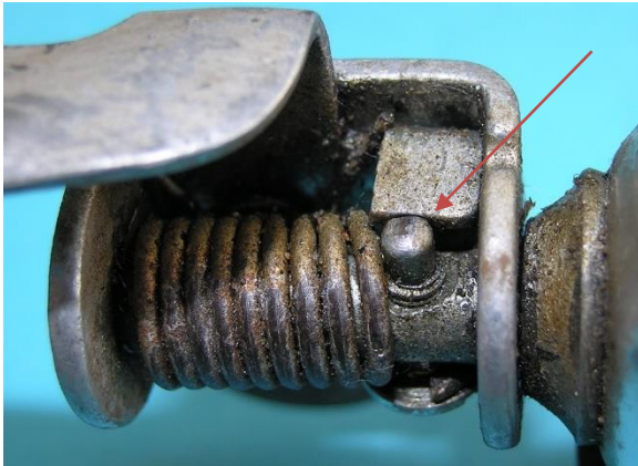
Bild 3.7: Ruhestellung und Betriebsstellung des Sperrbolzens
