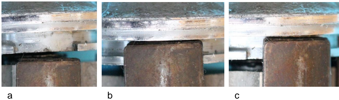
Bild 2.38: Montagevorgang parallel zum Bild 2.34: a) Nut und Polschuhbreite, b) Polschuh in die Nut eingeschoben, c) Verdrehung des Pols in der Ringnut
