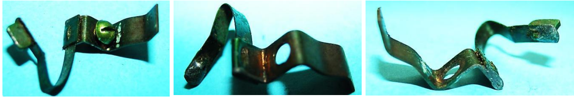
Bild 2.16: Bürstenhalter: a) Schraube zur Befestigung am Lagerhals, b) Lötstelle der Bürste, c) Klemmstelle der Blattfedern
