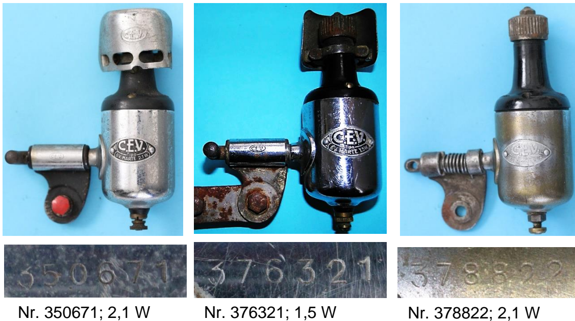
Bild 2.1: Magnetstahl-Dynamo mit den Fertigungsnummern 350671 bis 378822, Gewicht 380 g
