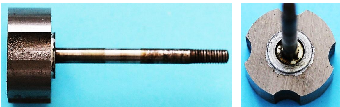
Bild 2.29: Vierpoliges Polrad: Durchmesser: 27 mm, axiale Länge: 12 mm
