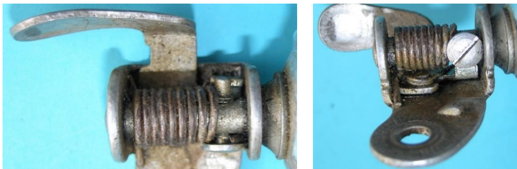
Bild 3.2: Kippvorrichtung mit langem Hebel und kurzem Halterarm (XI – 967)
