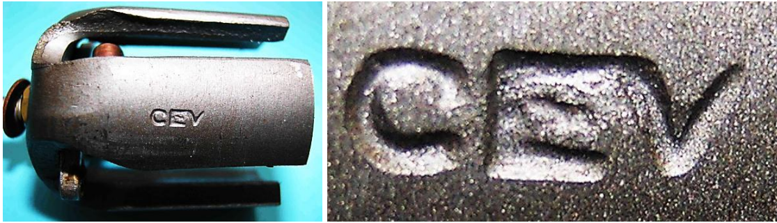
Bild 2.5: Magnetschenkel mit eingprägtem Firmenlogo
