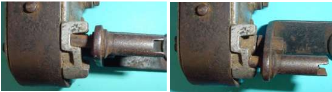
Bild 3.6: Positionen der Kippvorrichtung: a) Ruhestellung, b) Betriebsstellung
