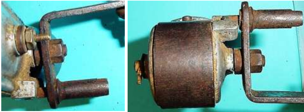
Bild 3.5: Befestigung des Halteblechs auf dem Drehbolzen zwischen zwei Muttern: a) Ansicht von oben, b) Ansicht von unten
