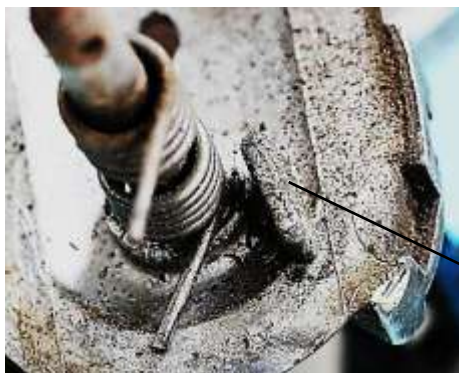
Bild 4.7: Doppelte Druckfeder: a) Freie Federenden zur Abstützung am Stützzapfen, b) Abstützung der Feder auf dem Drehbolzen
