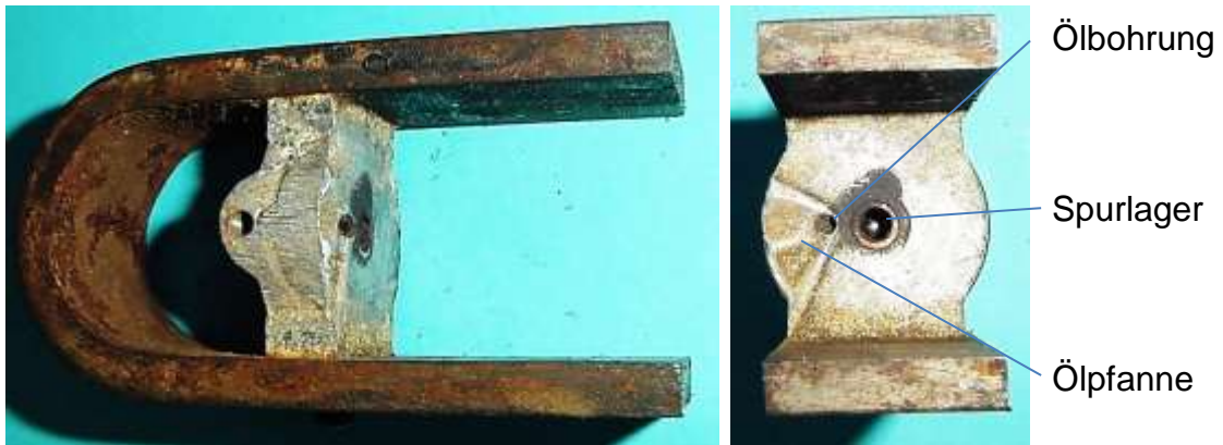
Bild 3.10: Magnet mit Lagersteg, Ölbohrung und Pfanne
