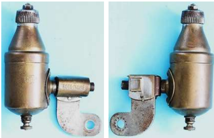
Bild 6.1: Roto-Phare mit zweipoligem AlNi-Polrad
