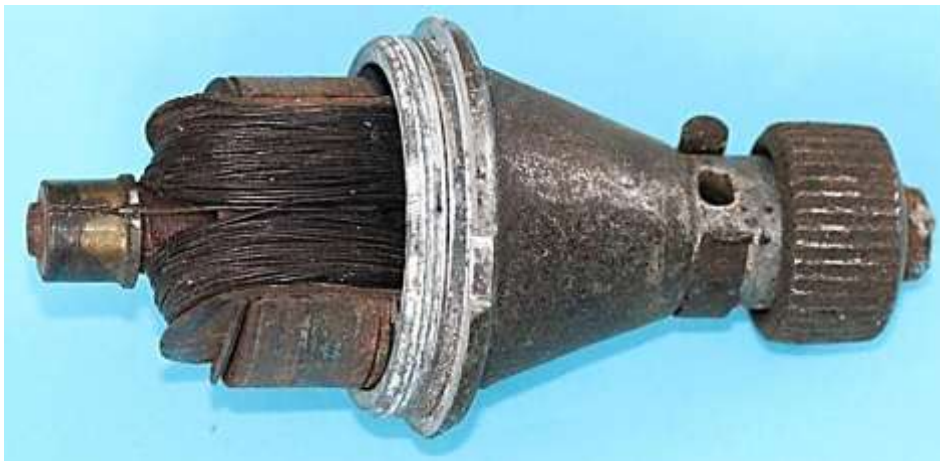
Bild 5.4: Lagerhals mit Gewinde und eingebautem Anker
