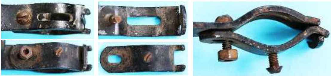
Bild 4.10: Am Halter einseitig eingeklinkte Schelle
