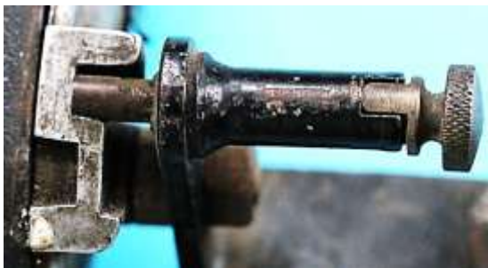
Bild 4.6: Sperrstift mit Zugknopf: a) Ruhestellung, b) Betriebsstellung
