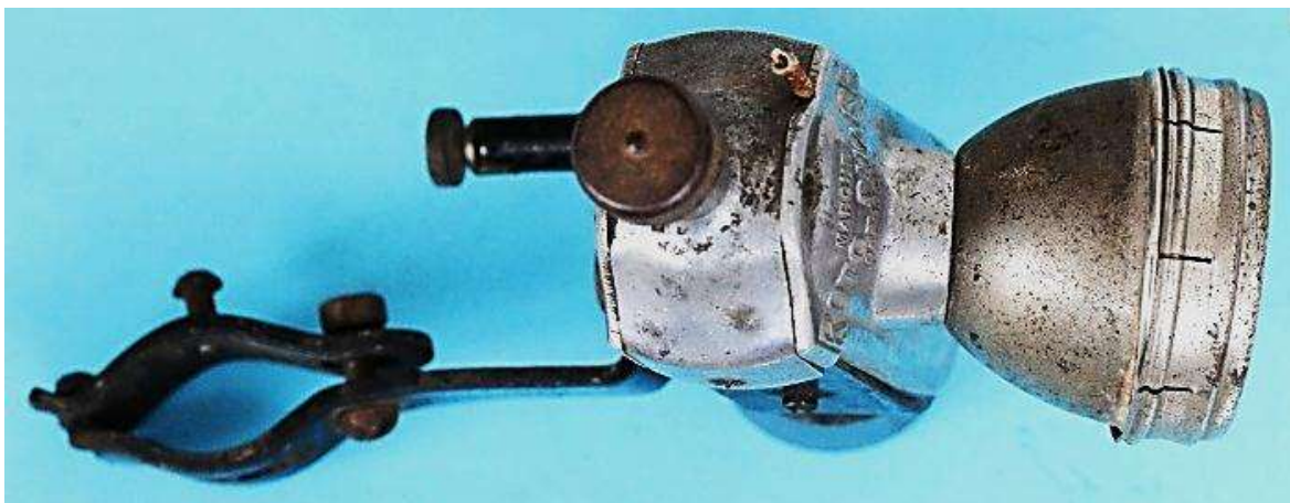
Bild 4.2: Lampensockel und Pollückenblech als eine konstruktive Einheit
