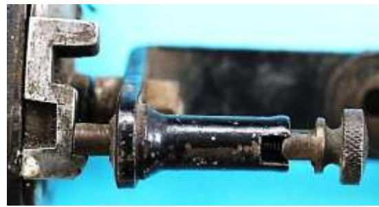
Bild 4.6: Sperrstift mit Zugknopf: a) Ruhestellung, b) Betriebsstellung
