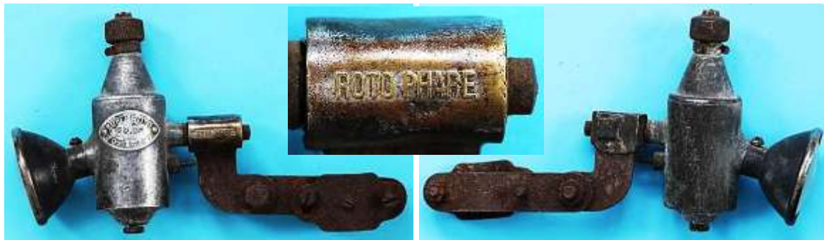
Bild 5.1: Dynamo-Lampen-Einheit mit Halter, Beschriftung der Abdeckung der Kippvorrichtung
