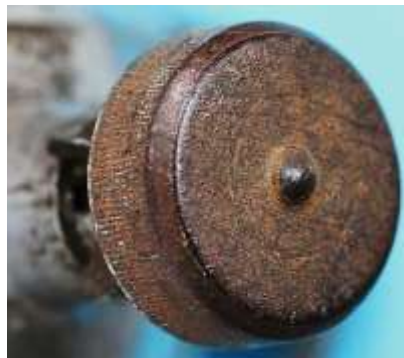
Bild 4.5: Reibrad: a) Verschließbare Ölbohrung, b) Schwer lösbare Befestigung des Reibrades auf der Welle
