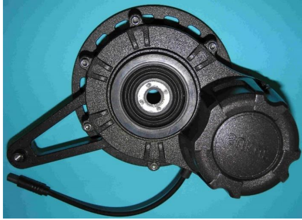
Bild 2.4: Antrieb des Generators durch die Verzahnung mit den Speichen: a) SRAM Spectro-Lux V6, b) Sunup
