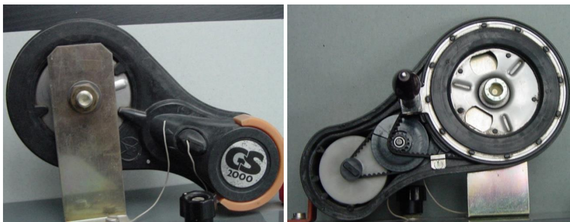
Bild 2.3: GS 2000: Zweistufiges Getriebe mit Zahnriemen
