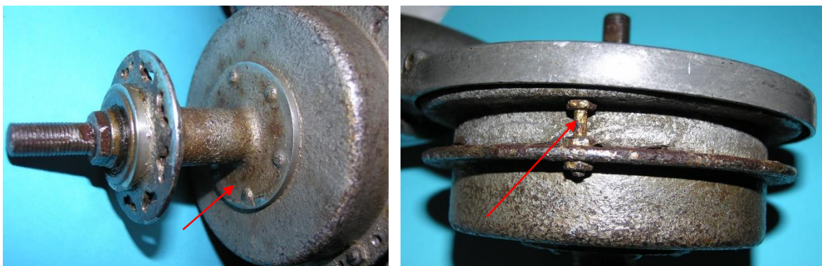
Bild 3.4: a) Bremstrommel an der Nabe angenietet, b) Abstützung des Getriebes
