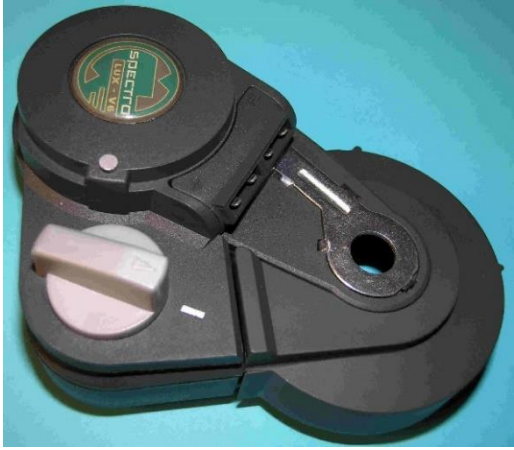
Bild 2.4: Antrieb des Generators durch die Verzahnung mit den Speichen: a) SRAM Spectro-Lux V6, b) Sunup
