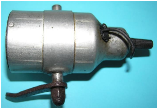
Bild 4.1: Abmessungen des Generators: Gehäusedurchmesser 41 mm, axiale Länge 78 mm
