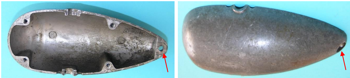
Bild 3.8: Deckel mit einer Durchgangsbohrung und vier Gewindegrundbohrungen
