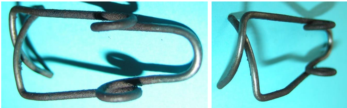
Bild 3.9: Feder für den Andruck des Kegelrades am Gummiring
