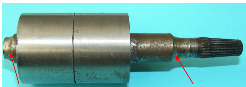
Bild 4.7: Polrad: a) Linien der parallelliegenden Pollücken (perspektivisch verzerrt), b) 12 mm starke Polradwelle mit zwei Konen
