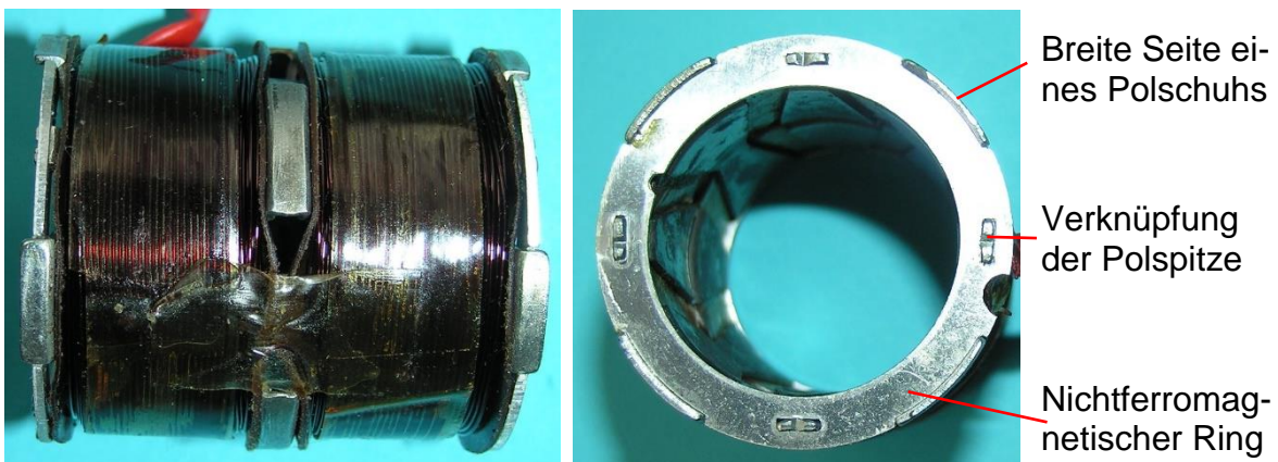
Bild 4.10: a) Unterbrechungsfreier Übergang des Drahtes von einer Spule zur ande- ren, b) Stirnseite des Ankers
