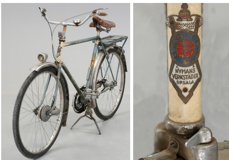
Bild 1.2: Produkt der Firma „Nymans Werkstätten“ in Upsala: a) Nabendynamo außerhalb der Speichenebenen am Hermes-Fahrrad, b) Steuerkopfschild am Hermes-Fahrrad
