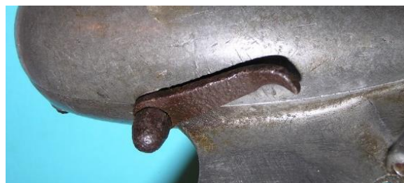
Bild 3.12: Kippvorrichtung: a) Schlüssel­fläche auf dem Drehbolzen, b) Gesehnte Bohrung im Hebel für eine verdrehsichere Befestigung auf dem Drehbolzen
