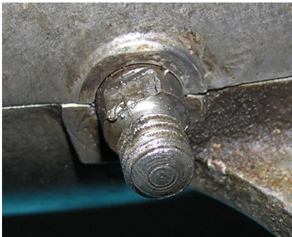
Bild 3.12: Kippvorrichtung: a) Schlüssel­fläche auf dem Drehbolzen, b) Gesehnte Bohrung im Hebel für eine verdrehsichere Befestigung auf dem Drehbolzen
