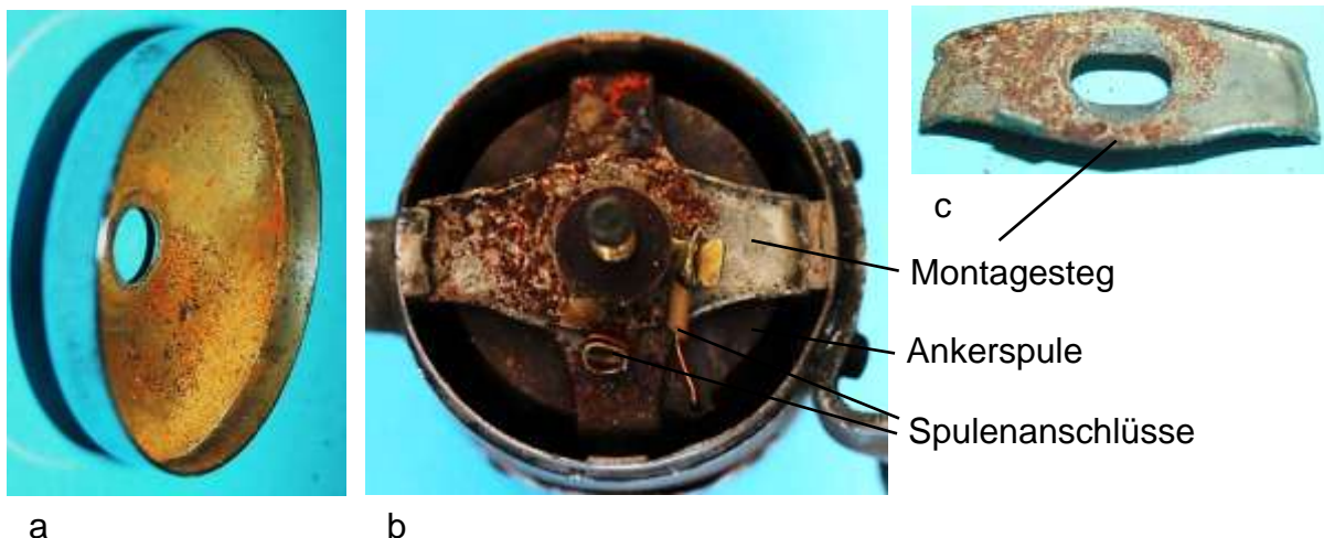
Bild 2.4: Abgenommener Boden: a) Eisenblechboden, b) Unterseite des Ankers, c) Montagegesteg
