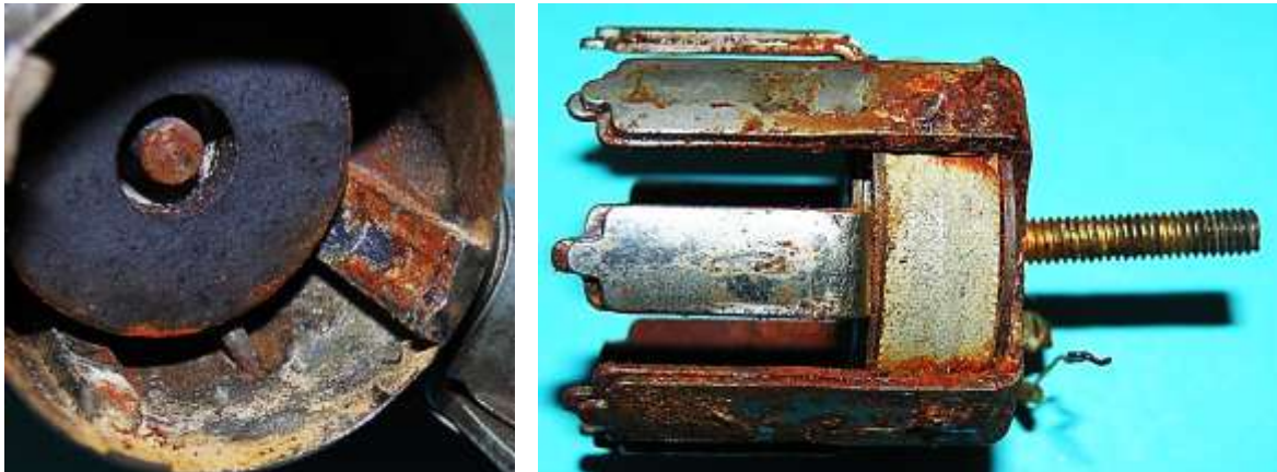
Bild 2.5: Generator: a) Walzenpolrad und Schienen zur Positionierung des Ankers, b) Klauenpolanker mit axialer Anordnung der Generatorspule
