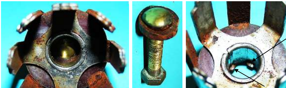
Bild 2.6: Kurzer Klauenpolkranz: a) Im Spulenkernrohr eingesetzter Kabelanschlussbolzen, b) Kabelanschlussbolzen mit Isolierscheibe, c) Ausgeklinkte Zähne
