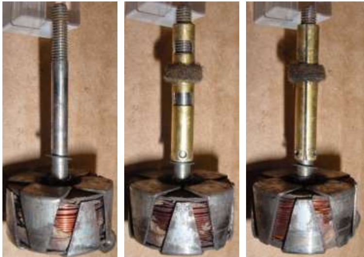
Bild 4.57: Anker und seine Lagerung
