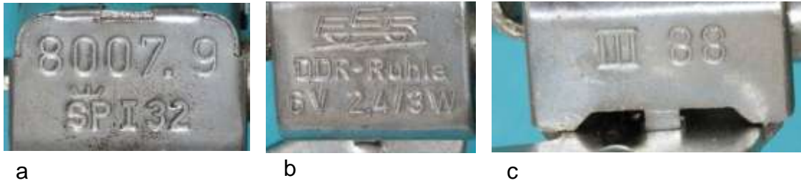
Bild 5.71: Beschriftungen auf der Abdeckung der Kippvorrichtung: a) Typennummer 8007.9, b) FER, DDR-Ruhla, 6 V 2,4/3 W3 W, c) Fertigungsdatum III 88
