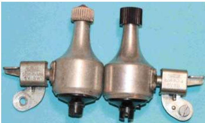
Bild 5.60: Der Unterschied aufeinanderfolgender Serien besteht in der Reibradausführung a) 8007.4 / 1985 b) 8007.5 / 1989
