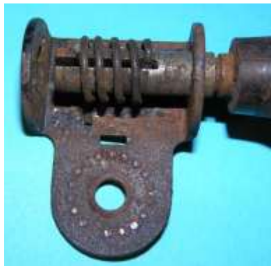
Bild 5.19: Kippvorrichtung: a) Komplette Kippvorrichtung. b) Ohne Fußhebel und Sperr- haken
