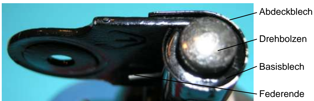
Bild 1.11: Kippvorrichtung mit axial aufgeschobener Abdeckung
