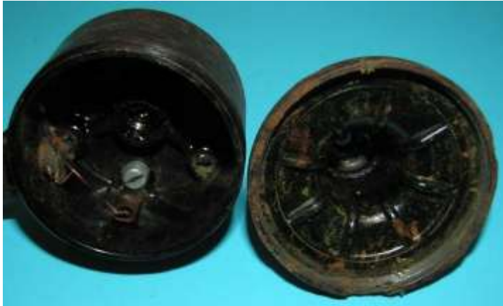
Bild 5.2: Gehäusekopf und Lagerhals aus gefülltem Duroplast
