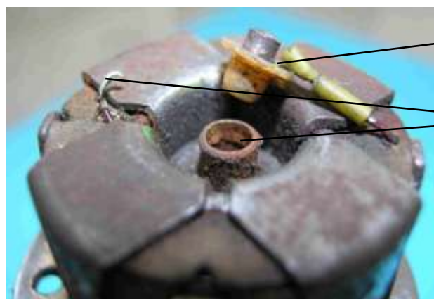
Bild 4.50: Kontaktierung der Spulenenden
