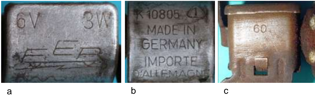
Bild 4.45: Beschriftung auf der Kippvorrichtung des Typs FER Standard 8007.2 und 8007.3: a) Firmenname „FER“ und Nenndaten, b) Prüfnummer K 10805, Gütezeichen 1, MADE IN GERMANY und IMPORTE D`ALEMAGNE, c) Einprägung der Jahreszahl 1960 auf dem Basisblech
