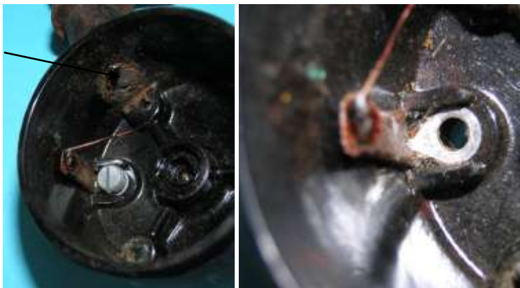
Bild 5.10: Kabelschuhe innerhalb des Gehäusetopfes
