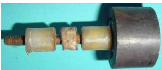
Bild 5.29: Polrad mit Kunststofflager: a) Trocken gelaufenes Lager mit trockenem Fettdepot in der Mitte, b) Polrad mit Reibrad
