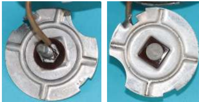
Bild 5.41: Kontaktteller, a) Unterseite mit angeklebtem Spulenende, b) Obere Seite mit isoliert eingesetztem Kabelbolzen
