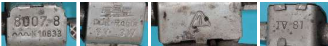
Bild 5.54: Beschriftungen auf der Kippvorrichtung des Typs 8007.8
