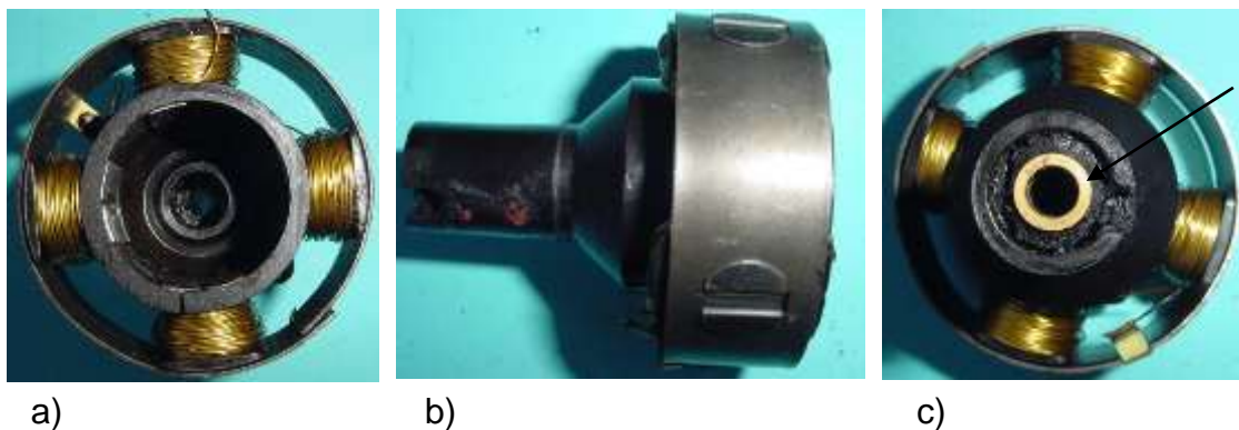
Bild 3.48: Anker: a) Ansicht des Ankers von der Bodenseite, b) Ankerjoch und innerer Lagerhals, c) Ansicht des Ankers von der Reibradseite mit oberem Gleitlager
