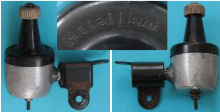
Bild 3.29: Dynamo 36/378/4005 der Firma Metallbau, Radebeul
