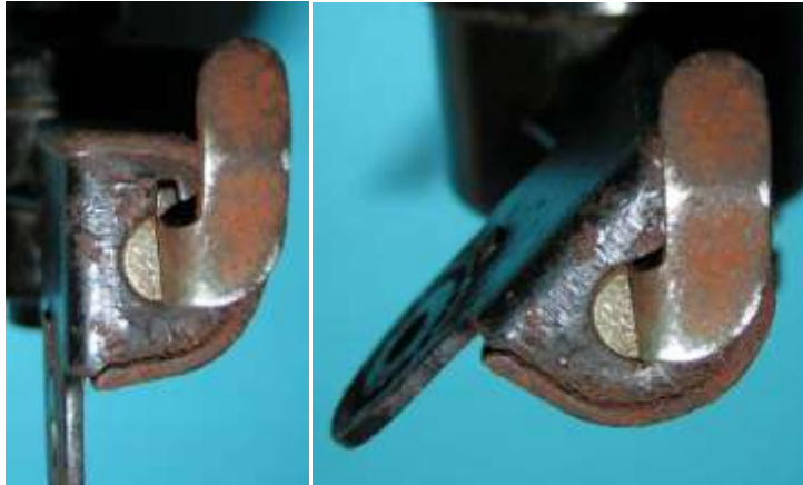
Bild 5.16: Kippvorrichtung: a) Raststellung, b) Betriebsstellung
