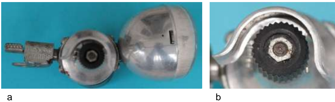
Bild 5.63: Dynamo-Lampen-Kombination 8007.5: a) Gesamtansicht von oben, b) Reibrad mit Spritzschutz
