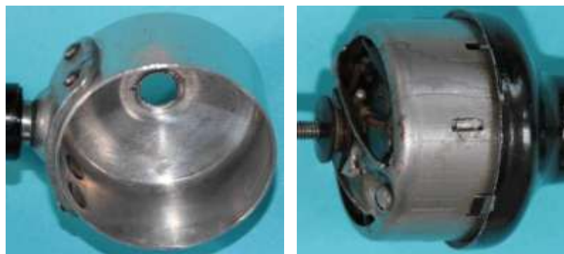
Bild 3.22: Dynamokonstruktion: a) Gehäusetopf, b) Ankerjoch
