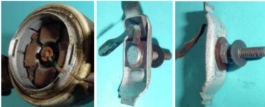
Bild 4.51: Spannung führender Kontakt
