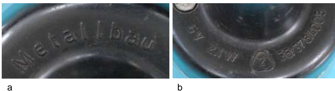
Bild 3.31: Beschriftung des Lagerhalses: a) Firmenname: Metallbau, b) Nenndaten: 6 V; 2,1 W, Gütezeichen 2, Zahlenreihenfolge: 36/378/4005
