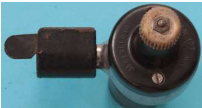
Bild 3.30: Blick auf das Reibrad und den Lagerhalsfuß
