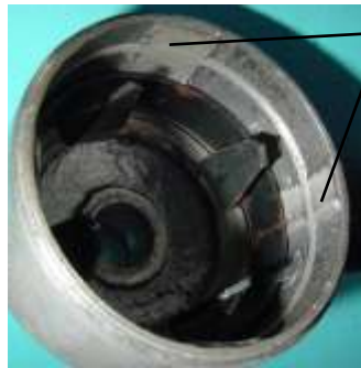
Bild 5.27: Anker, a) Ankerspule mit einem Klauenpolring, b) Bearbeitete Schiebeflächen
