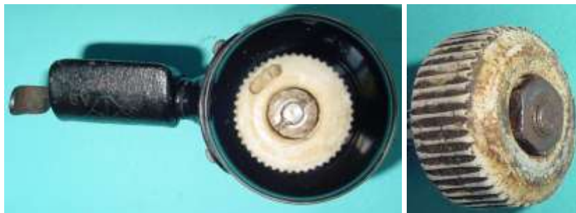
Bild 3.44: Befestigung der keramischen Reibräder
