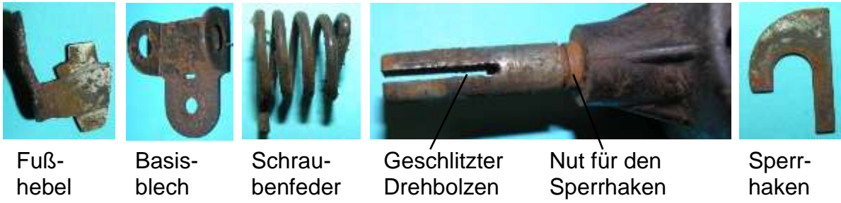
Bild 5.18: Einzelteile der Kippvorrichtung
