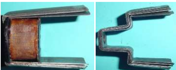
Bild 3.39: Ankerblechpaket aus vier Blechen:
