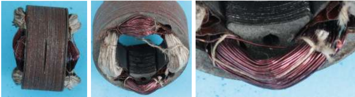
Bild 3.37: Vierpoliger Anker: a) Blechpaket, b) Wicklungsköpfe, c) Polschuhform
