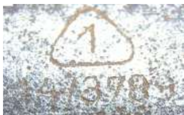
Bild 4.35: Beschriftung der Kippeinrichtungsabdeckung
