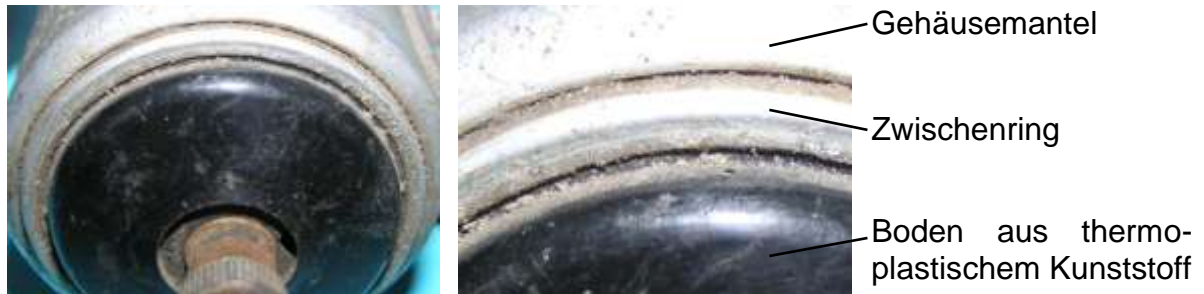
Bild 5.45: Boden aus thermoplastischem Kunststoff
