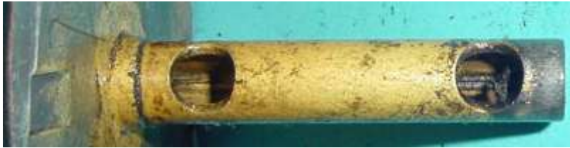
Bild 4.16: Gerollte Lagerhülse mit Ölöffnungen
