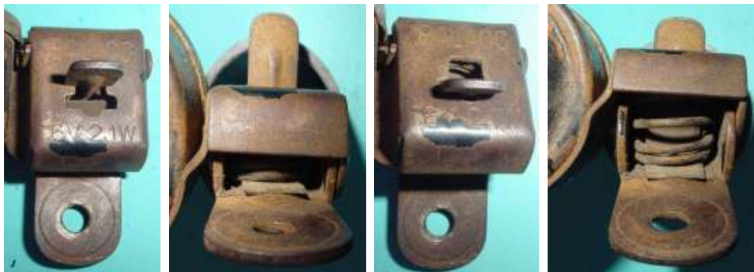
Bild 4.12: Kippvorrichtung: a) Arretierte Stellung, b) Andruckstellung
