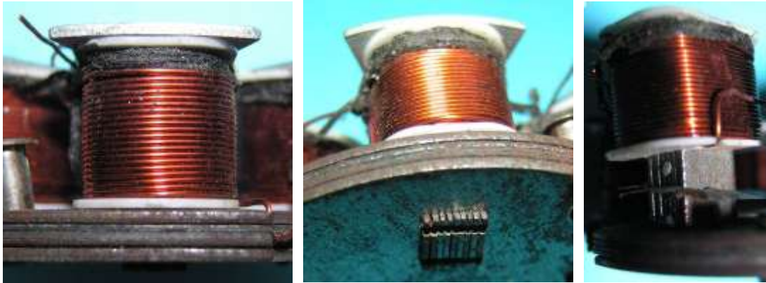
Bild 5.9: Ankerspule und Joch: a) Fünf Jochbleche unterhalb der Ankerspulen, b) Befestigung eines Spulenkerns am Joch durch Verstemmen, c) Papiermaske zwischen Spule und Joch
