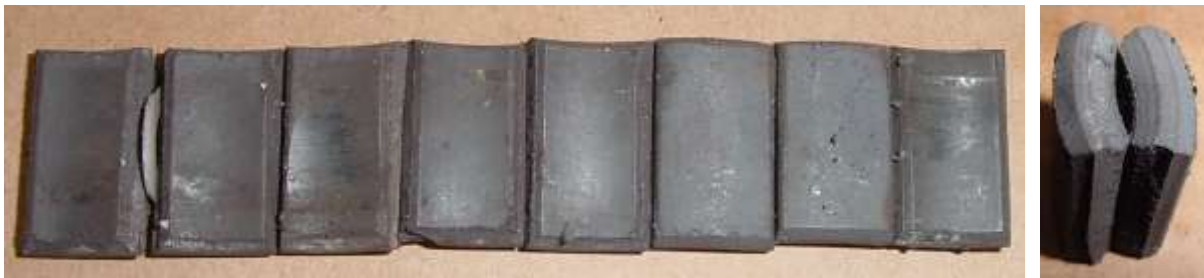
Bild 4.54: Acht Magnetblöcke des Erregersystems
