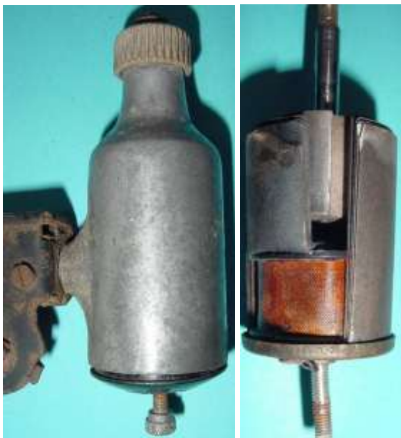
Bild 3.38: Metallbau 6 V, 2,1 W 36 / 1204 / 4004
