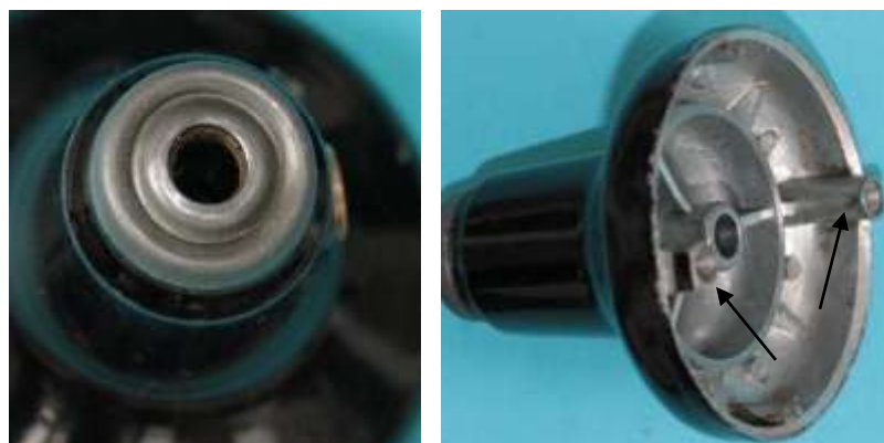
Bild 3.21: Lagerhals aus Zinkdruckguss a) Öldepot am oberen Lagerhalsrand b) Lagerhals mit Gewindebohrungen
