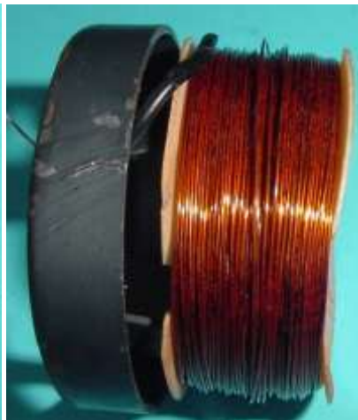
Bild 5.28: Ankerspule mit einem Klauenpolring
