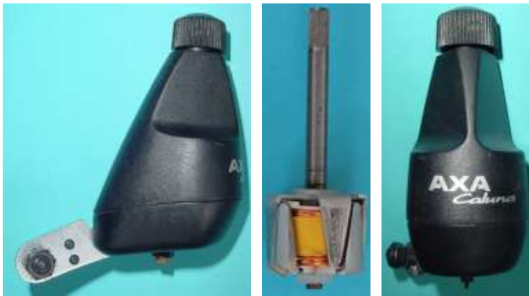
Bild 4.61: AXA Caluna mit rotierendem Klauenpolanker
