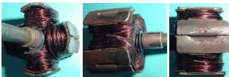
Bild 2.2: Sternanker: a) Lagerbuchse auf der Welle, b) Axialspielausgleichsfeder, c) Polschuh aus zwei Blechen
