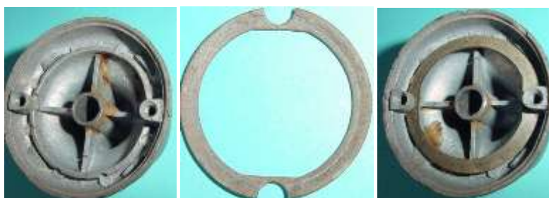
Bild 2.5: Lagerhals mit Gummiring
