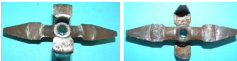
Bild 4.59: Zwei aufgebogenen Polschuhe eines Klauenpolrings
