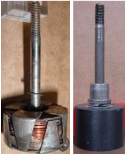
Bild 4.60: Ablösung des Läufers mit einem Klauenpolanker durch einen Läufer mit einer keramischen Magnetwalze
