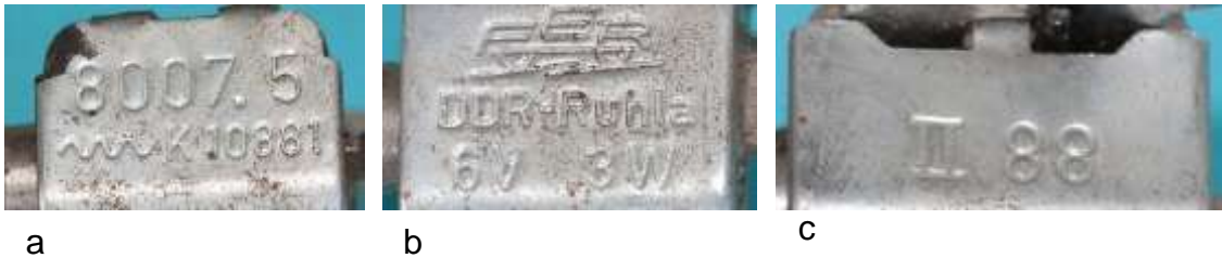
Bild 5.62: Dynamo-Lampen-Kombination 8007.5: a) Typenbezeichnung und Prüfnummer, b) Firmenlogo, Firmenstandort und Nenndaten, c) Fertigungsdatum
