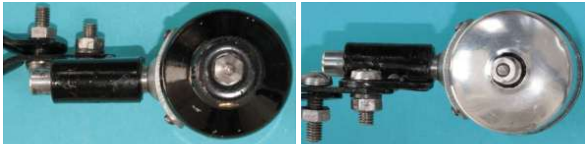
Bild 3.20: Gehäuseansichten: a) Lagerhals mit Reibrad, b) Boden mit Kabelanschlussbolzen
