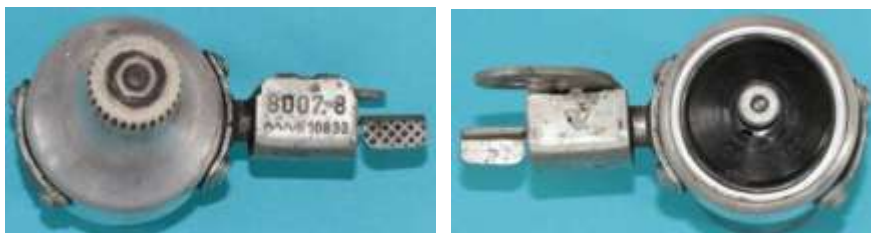
Bild 5.53: TYP 8007.8 a) Reibradansicht, b) Bodenansicht
