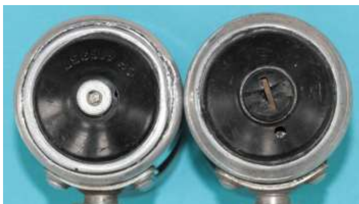
Bild 5.55: Variation des Kabelanschlusses: a) Schraubklemme 1983, b) Federdruckklemme 1985
