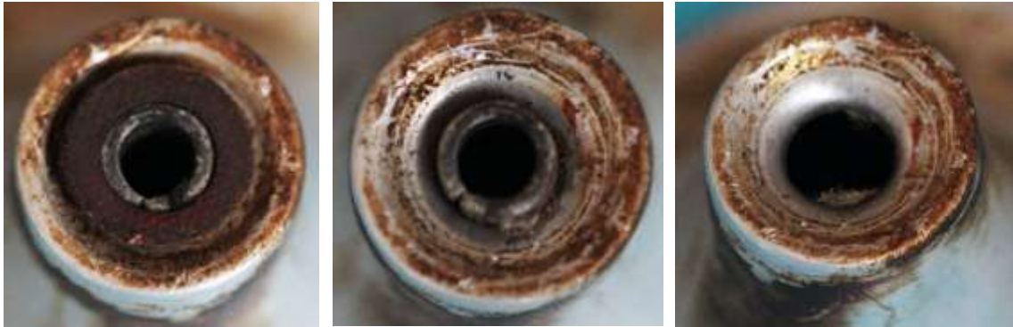
Bild 4.24: Lagerhalsmündung: a) Abdeckung des Schlitzes zwischen dem Lagerrohr und dem Lagerhals, b) Einpassung des Lagerrohres, c) Lagerhalsmündung
