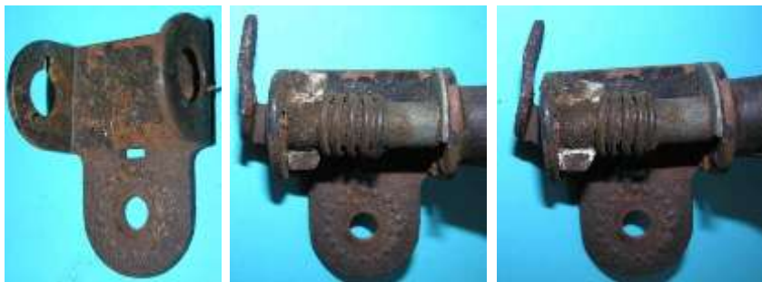
Bild 5.17: Kippvorrichtung: a) Basisblech, b) Raststellung, c) Betriebsstellung
