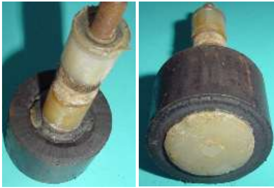
Bild 5.30: Welle mit Kunststoff in der Polradbohrung eingespritzt
