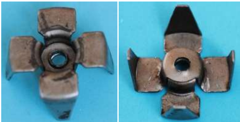
Bild 4.31: Klauenpolkranz: a) Stirnseite, b) Wickelraum
