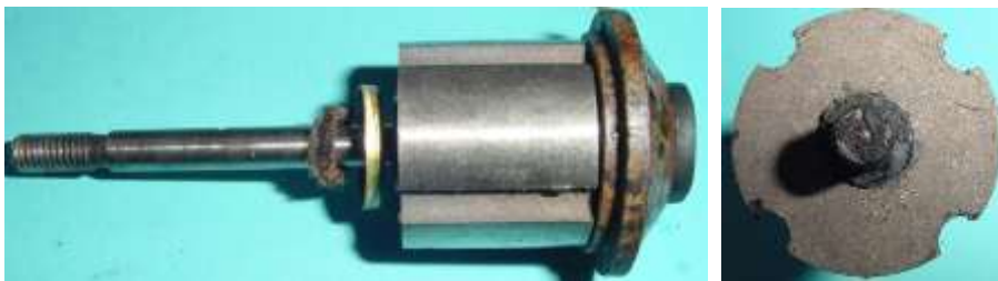
Bild 3.53: Vierpoli- ger AlNi-Magnet mit Welle
