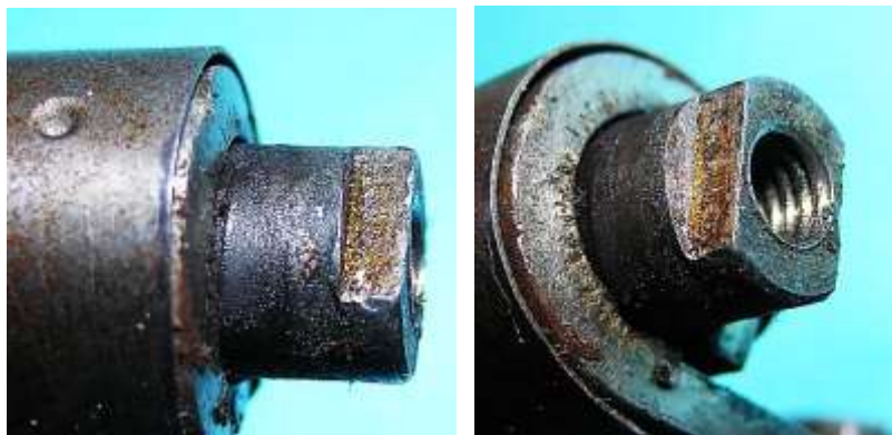
Bild 4.8: Schlüsselflächen an der Stirnseite des Drehbolzens
