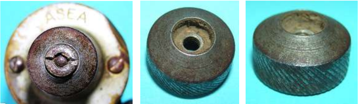
Bild 3.12: Reibrad und seine Befestigung auf der Welle
