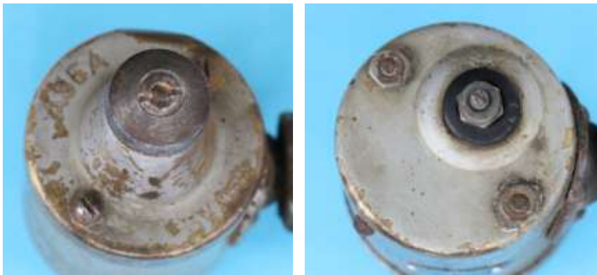
Bild 3.3: Gehäuseflächen: a) Lagerhals mit der Beschriftung: ASEA 6 V; 0,5 A und den Köpfen der Schlitzkopfschrauben, b) Boden mit dem dezentralen Kabelanschluss und den Muttern auf den Schrauben
