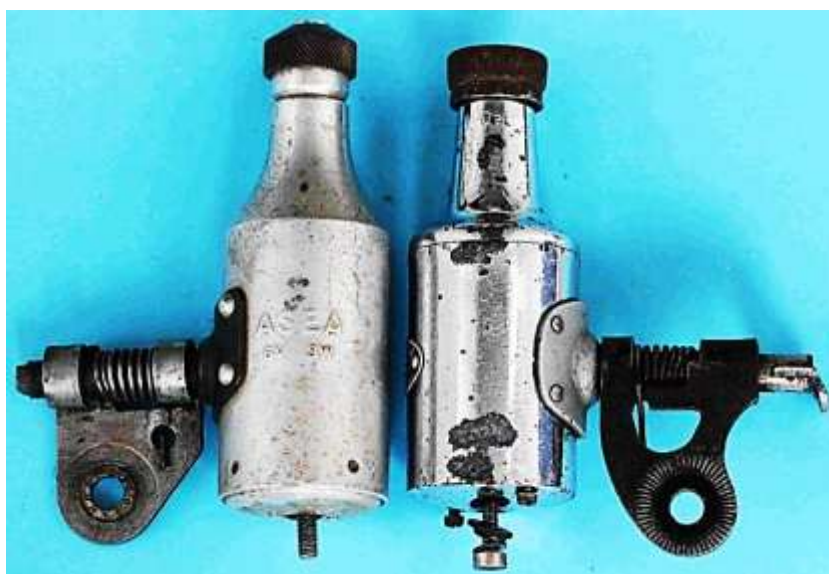
Bild 1.8: Vergleich der Reibräder: a) ASEA C 47, b) Bosch WMA
