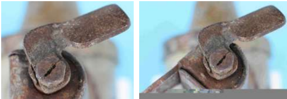
Bild 3.4: An der Stirnseite des Drehbolzens angeschraubtes Bedienungspedal: a) Ruhestellung, b) Betriebsstellung
