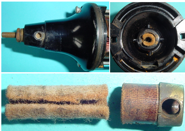
Bild 4.4: Zwei Gleitlager mit Öldepot
