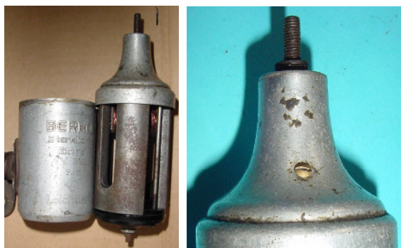
Bild 2.7: Lagerhals, Gehäusermantel, Magnetsystem und Spannbolzen
