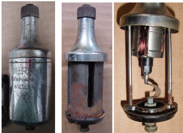
Bild 3.1: Berko Universal, Erregersystem und Anker
