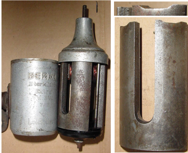
Bild 2.3: Gekrümmter Hufeisenmagnet mit Ausnehmungen am Magnetkopf
