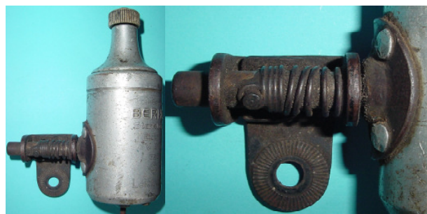
Bild 2.5: Kupplung mit Drehbolzen am Berko Modell 750
