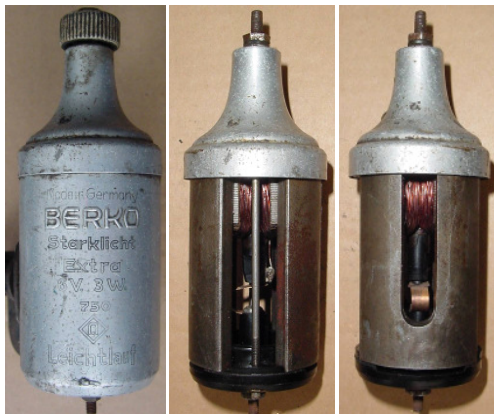
Bild 2.2: Berko Starklicht, Extra, Leichtlauf, Modell 750, mit Drehbolzen, 3,0 W ab ???
