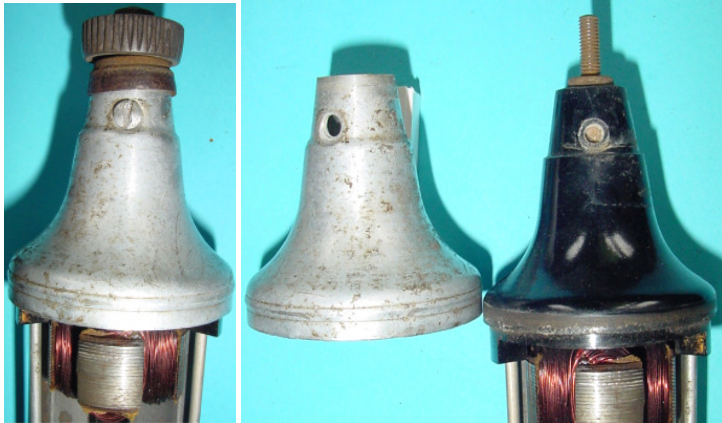
Bild 4.3: Äußerer und innerer Lagerhals mit Ölöffnung
