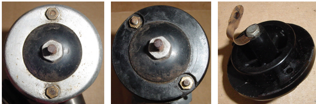
Bild 2.4: Bodenplatte aus Bakelit mit den Gewindeenden der Spannbolzen, an denen auch der Gehäusemantel befestigt ist
