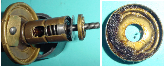
Bild 3.12: Berko-Universal, Abdeckung des oberen Lagers mit einer Deckscheibe und einem Fettdepot
