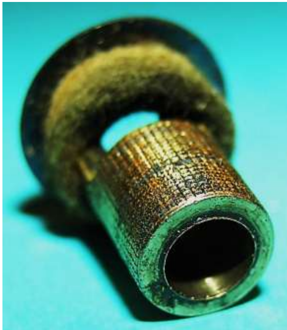
Bild 1.10: Oberes Lager mit Öldepot und dünnwandigem Lagerrohr
