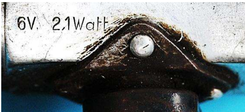
Bild 1.2: Auf dem Gehäusemantel eingeprägte Nenndaten
