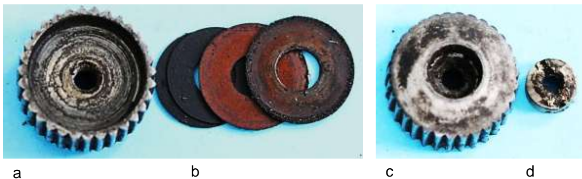
Bild 1.14: Reibrad: a) Innenraum, b) Anlaufscheiben im Innenraum, c) Vertiefung für die Kontermutter, d) Schlitzmutter
