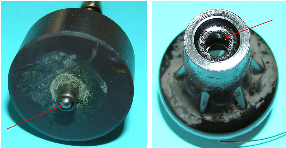
Bild 14: Lagerung: a) Axiallager, b) Kugellager im Lagerhals aus Duroplast
